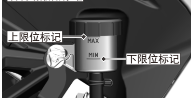
后制动液储存罐
