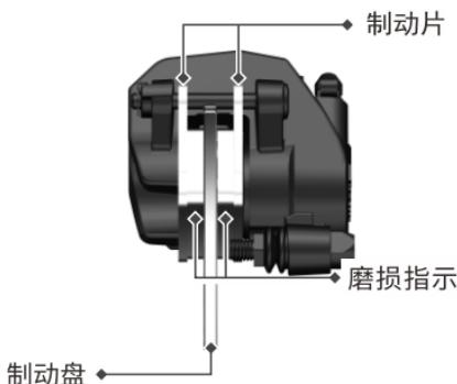
前轮：从制动卡钳前部检查制动片（务必检查左右制动卡钳）。
