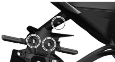
2. 使用T25梅花内六角和十字批分别拆下后挡泥板底部盖板的2颗自攻钉和3颗螺栓。
