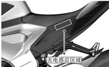
当感应钥匙电池电量不足或者没有钥匙电池时，可通过无电感应模式开机，具体步骤如下：
