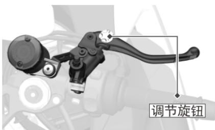
西互：旋转刹车手柄调整螺栓，可以调整制动手柄与油门手把的距离。顺时针旋转增加距离，逆时针则反之。
