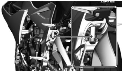
1. 如图所示位置为空气滤清器积油管，用尖嘴钳取下卡簧，拔出塑料堵头，放除废油，完成后再按照相反顺序安装回原来的状态。
