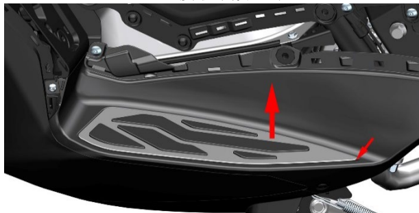
b. M310/350/150/368 使用 4#内六角，M368 (ETC) 使用 T25 梅花扳手拆下左踏板上的 7 处 M6×14 的轴肩螺栓。
