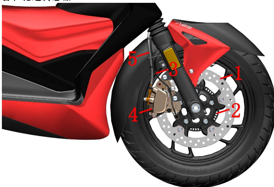
1-前碟刹主泵 2-FMC-HU 制动软管 3-RMC-HU 制动软管 4-后碟刹主泵
