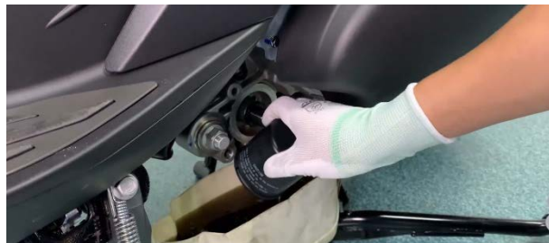
c. 将精滤器内的机油沥干。
