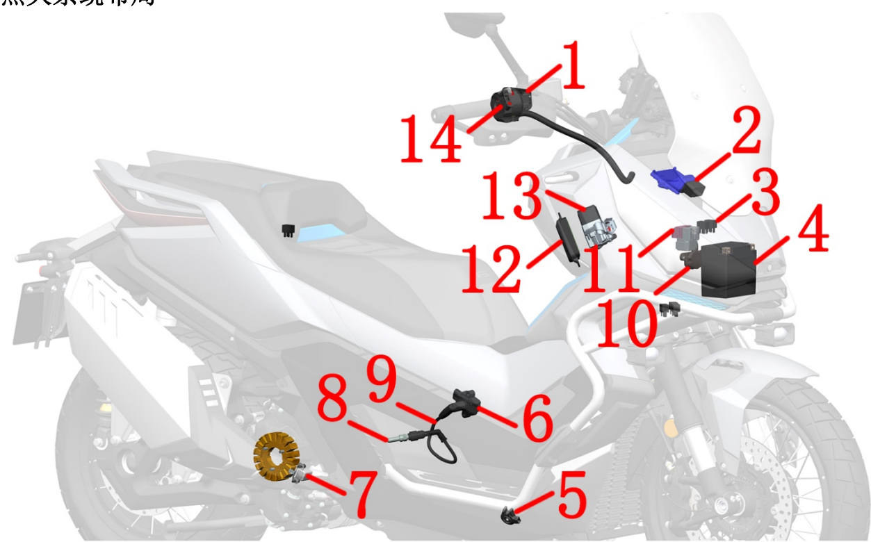
1-右手把副开关 2-发动机控制器 (ECU) 3-继电器 4-蓄电池 5-侧支架熄火开关 6-点火线圈本体 7-曲轴位置传感器 8-火花塞 9-高压线 10-倾倒开关 11-启动继电器 12- PKE 13-龙头锁 14-右手把开关
