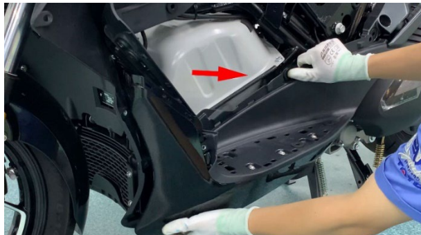
f. 使用同样的方法拆下右踏板装饰罩及右踏板。
