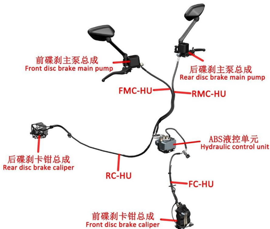
制动系统总成示意图 Brake system assembly sketch map
