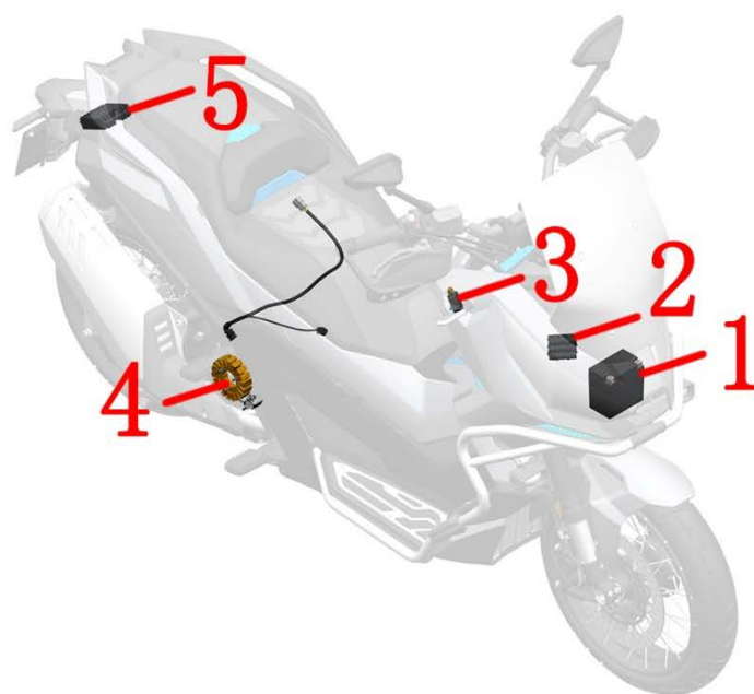
1-蓄电池 2-主保险 (25A) 3-充电口 (PKE) 4-磁电机 5-整流器
