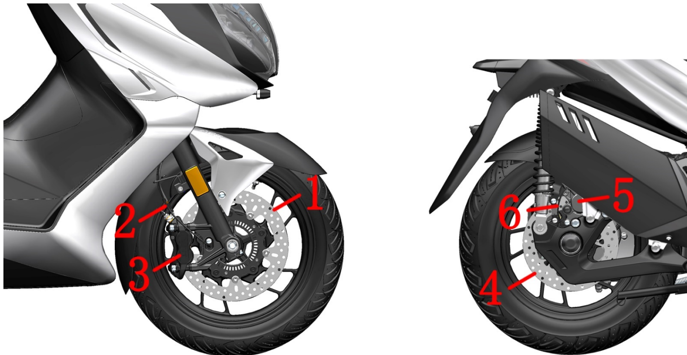
1-前制动盘组件 2-轮速传感器（前轮） 3-前碟刹卡钳 4-后制动盘组件 5-后碟刹卡钳 6-轮速传感器（后轮） E368 (ETC)
