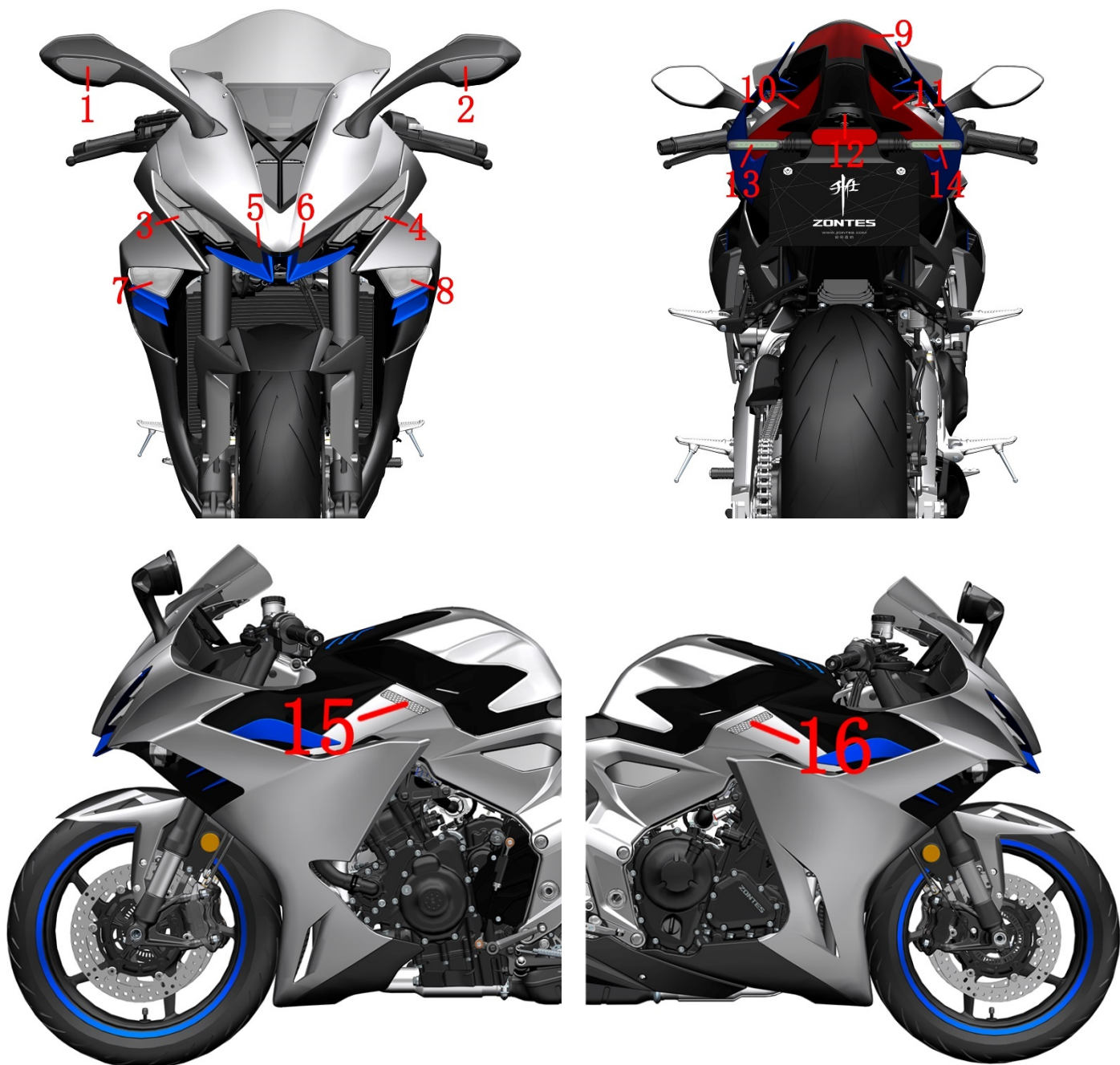
1-右转向灯 2-左转向灯 3-右日行灯 4-左日行灯 5-右前位置灯 6-左前位置灯 7-右前大灯 8-左前大灯 9-制动灯 10-左位置灯 11-右位置灯 12-后牌照灯 13-左后转向灯 14-右后转向灯 15-车架左网格氛围灯 16-车架右网格氛围灯
