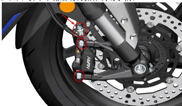
b. 前碟刹卡钳分解
