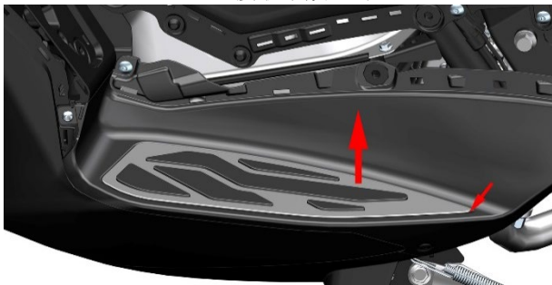
b. M310/350/150/368 使用 4#内六角，M368 (ETC) 使用 T25 梅花扳手拆下左踏板上的 7 处 M6×14 的轴肩螺
