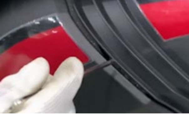
g. 用4#内六角将另外4颗M6×14轴肩内六角螺栓或T30梅花扳手将4件小法兰M6×16+衬套+胶垫装回。将装饰扣装回。
