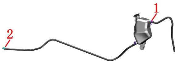
M150 冷却液系统抱箍/卡箍分布图
