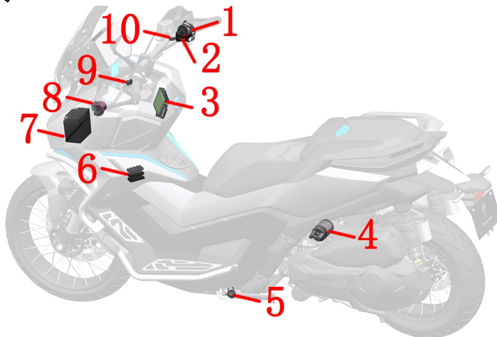
1-右手把开关（熄火开关、启动按钮） 2-右手把副开关（解锁车辆） 3-PKE 4-启动电机 5-侧支架熄火开关 6-保险盒 7-蓄电池 8-启动继电器 9-后刹车开关 10-前刹车开关
