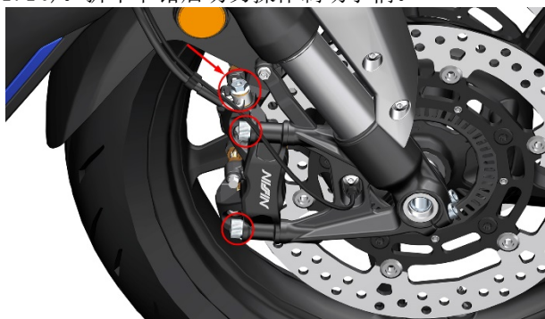
b. 前碟刹卡钳分解
