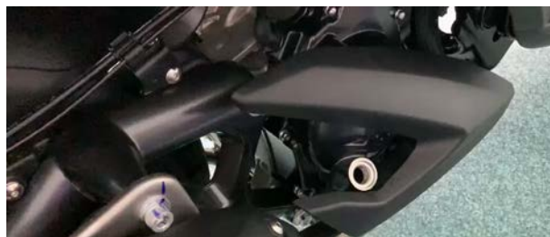
d. 检查 O 环(2)是否有破损、老化，如无则擦拭干净，如有则需更换。机油尺所用 O 环规格为：18×3×3.5。
