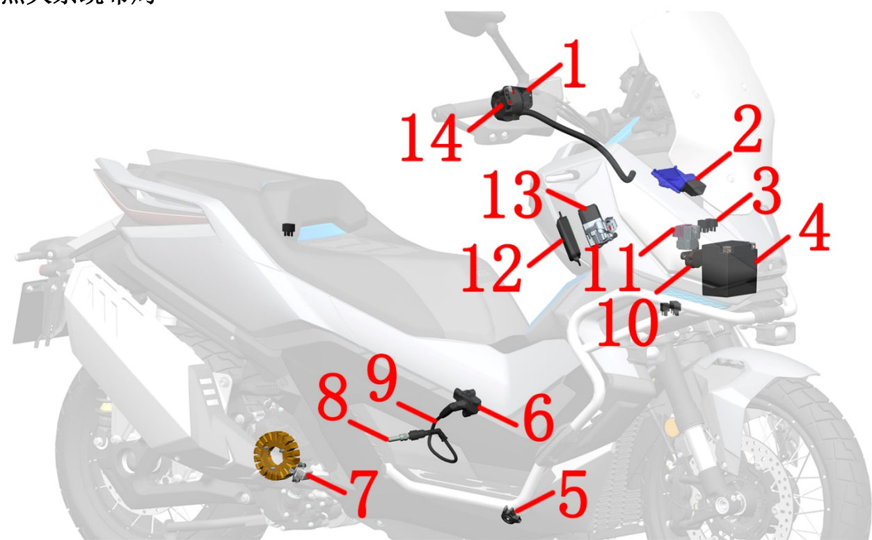
1-右手把副开关 2-发动机控制器 (ECU) 3-继电器 4-蓄电池 5-侧支架熄火开关 6-点火线圈本体 7-曲轴位置传感器 8-火花塞 9-高压线 10-倾倒开关 11-启动继电器 12- PKE 13-龙头锁 14-右手把开关
