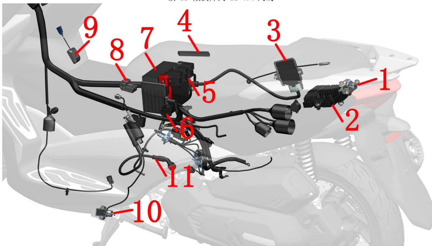
1-坐垫锁 2-启停控制器 3-发动机控制器 (ECU) 4-PKE 天线 5-保险盒 6-启动继电器 7-蓄电池 8-电子油箱锁 9-GPS 天线 10-侧支架熄火开关 11-电喷高压线
