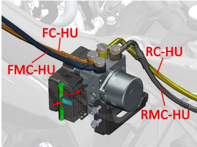
FMC-HU: FRONT DISC BRAKE MAIN PUMP - HYDRAULIC CONTROL UNIT
