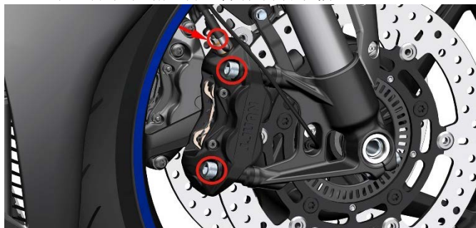
b. 前碟刹卡钳分解
