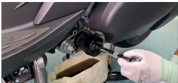
d. 将精滤器内的机油沥干。
