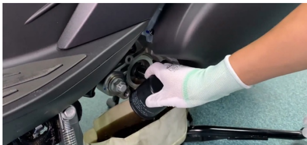
e. 用干净的无纺布擦拭干净发动机上残留的机油及杂质等。
