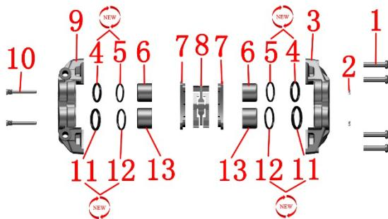
1~螺栓 2~卡簧 3~卡钳内侧壳体 4~Φ30 油封 5~Φ30 防尘封 6~Φ30 活塞 7~制动片 8~制动片弹簧片 9~卡钳外侧壳体 10~销轴 11~Φ34 油封 12~Φ34 防尘封 13~Φ34 活塞
