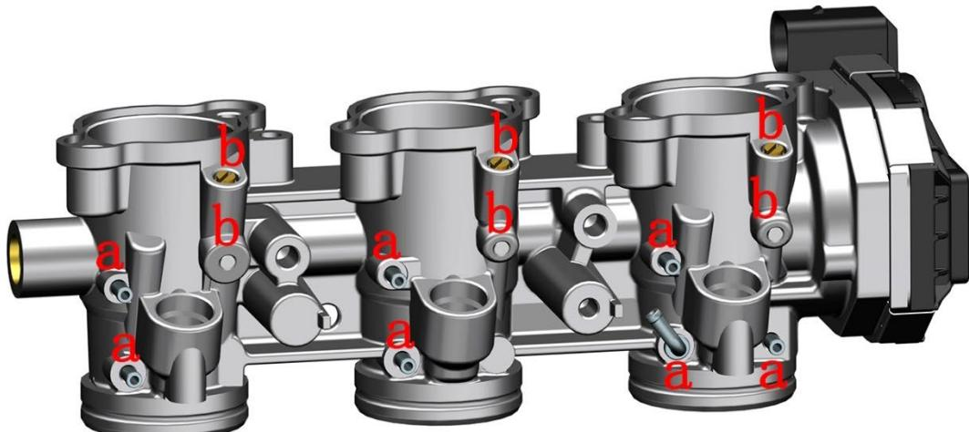
2、怠速不稳定，转速忽高忽低，此时连接诊断仪，检查节气门信号电压波动不能超过 0.08V，节气门开度波动不能高于 0.5%。
