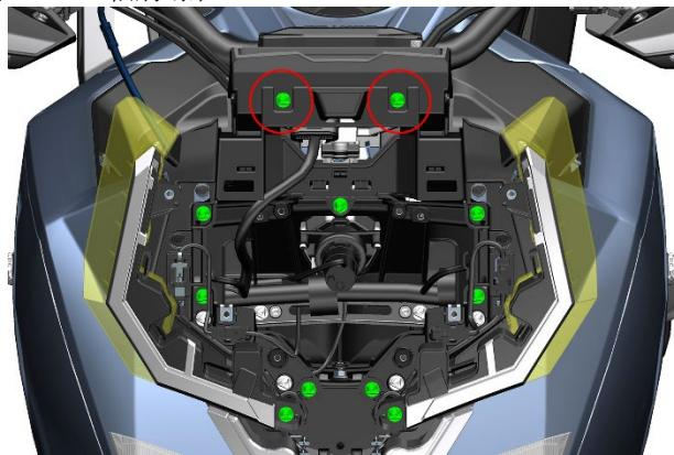
b. 拆下左右两侧包围后，从缝隙推开仪表底部装饰件的卡扣。
