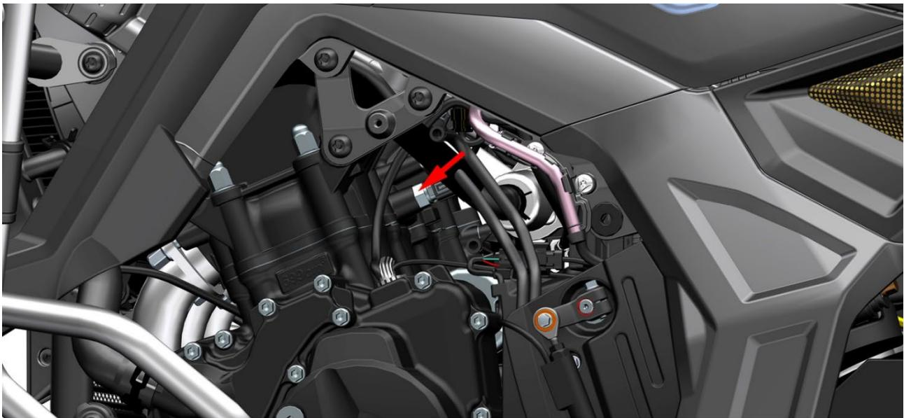
因空间有限建议使用 72 齿的 17#棘轮梅花扳手逆时针拆下水油共用传感器，取下  $9 \times 2$  三元乙丙橡胶 O型圈。重新装配时需更换新的 O型圈避免渗漏。
