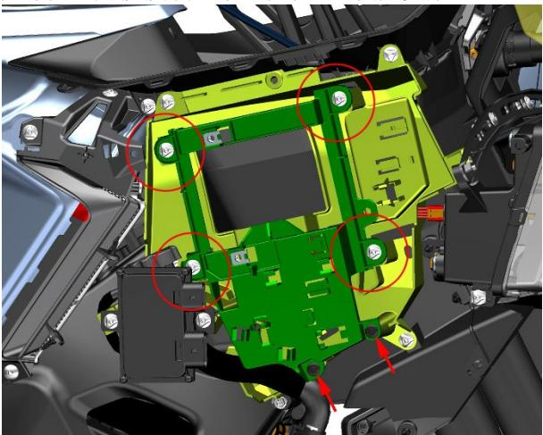
c. 使用 T25 内六角梅花扳手拆下两颗颗 M6×14 的轴肩螺栓螺栓，取下雾灯驱动盒。
