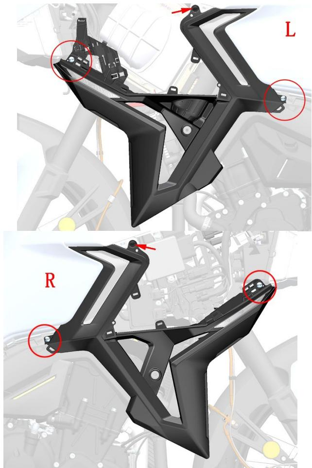
c. 使用 T25 梅花内六角拆下一颗 M6×16 轴肩螺栓螺栓, 1 颗膨胀钉后, 拔下右包围角灯的插头, 即可取下包围下部组件, 左包围下部组件拆卸方法相同。
