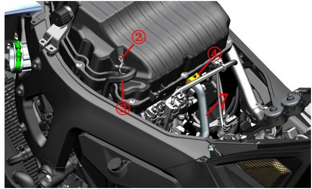
c. 将空滤器微微抬起，使用抱箍钳取下补气阀橡胶管(8)上的抱箍⑤，拔下补气阀橡胶管后可将空滤器壳体取出。
