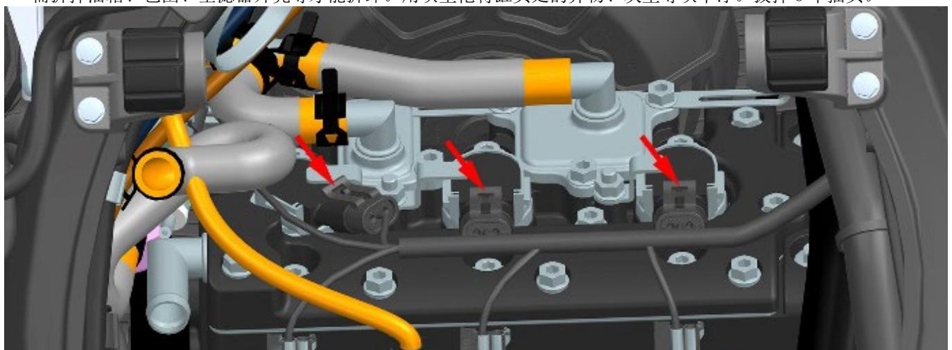
用 10#套筒拆下螺母，取下点火线圈压板。将点火线圈取下。使用 14#套筒拆下火花塞。如配合较紧，可以轻微左右摇晃取出点火线圈。
