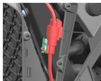
当车辆故障灯亮起，报 0030（前氧加热器故障），0130（前氧信号故障）需按照以下方式检查：
