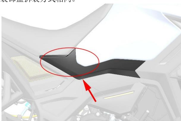
b. 使用 T25 梅花内六角左右包围各拆下两颗 M6×14 轴肩螺栓螺栓，1 颗膨胀钉。
