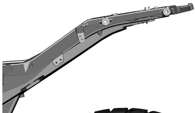
e. 使用十字螺丝批将 4 颗自攻螺钉拆下，取下右侧盖网饰衬板与右侧盖网饰拆下，使用同样的方法拆下左侧盖网饰衬板。
