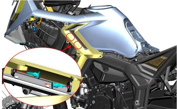
g. 用手轻轻拉开箭头所指方向的左包围下部，用十字批拆下包围后面的自攻螺钉。向上稍托起后取下包围下部组件。右侧用同样方法拆下。
