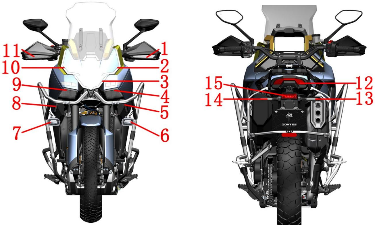
1~左前转向灯 2~左位置灯 3~中位置灯 4~左大灯 5~左角灯 6~左雾灯（高配版） 7~右雾灯（高配版） 8~右角灯 9~右大灯 10~右位置灯 11~右后转向灯 12~后位置灯 13~右后转向灯 14~左后转向灯 15~后尾灯/牌照灯
