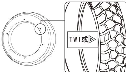
胎侧三角形（△T.W.I.）标记指示磨损条位置。若磨损到标记点表明已经磨损到极限，继续驾驶会有安全隐患，必须更换新的同规格轮胎。
