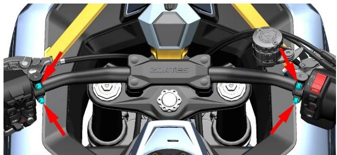
b. 扣下压块上的 4 颗装饰扣，使用 6#内六角拆下 4 颗螺栓，取下压块，拿起方向把。
