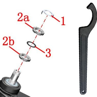
c. 若转向较重则逆时针松开调节螺母(2b)。先顺时针拧到 35N.m(3.6 kgf.m, 26 lbf.ft)后逆时针松 1/4 圈，然后再拧到 13N.m(1.3 kgf.m, 10 lbf.ft)。
