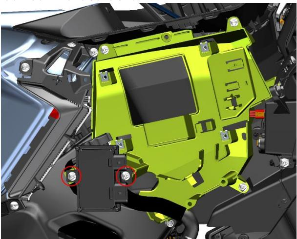
d. 从布线板上取下水箱加水口，拉开水箱加水口
