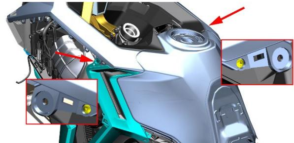
h. 先将左包围上部稍微拔开部分卡扣至合适位置，使用T25梅花内六角拆下左侧包围内饰上连接支架的1颗轴肩螺栓(1)。用同样办法拔开右包围上部，取下螺栓(1)。
