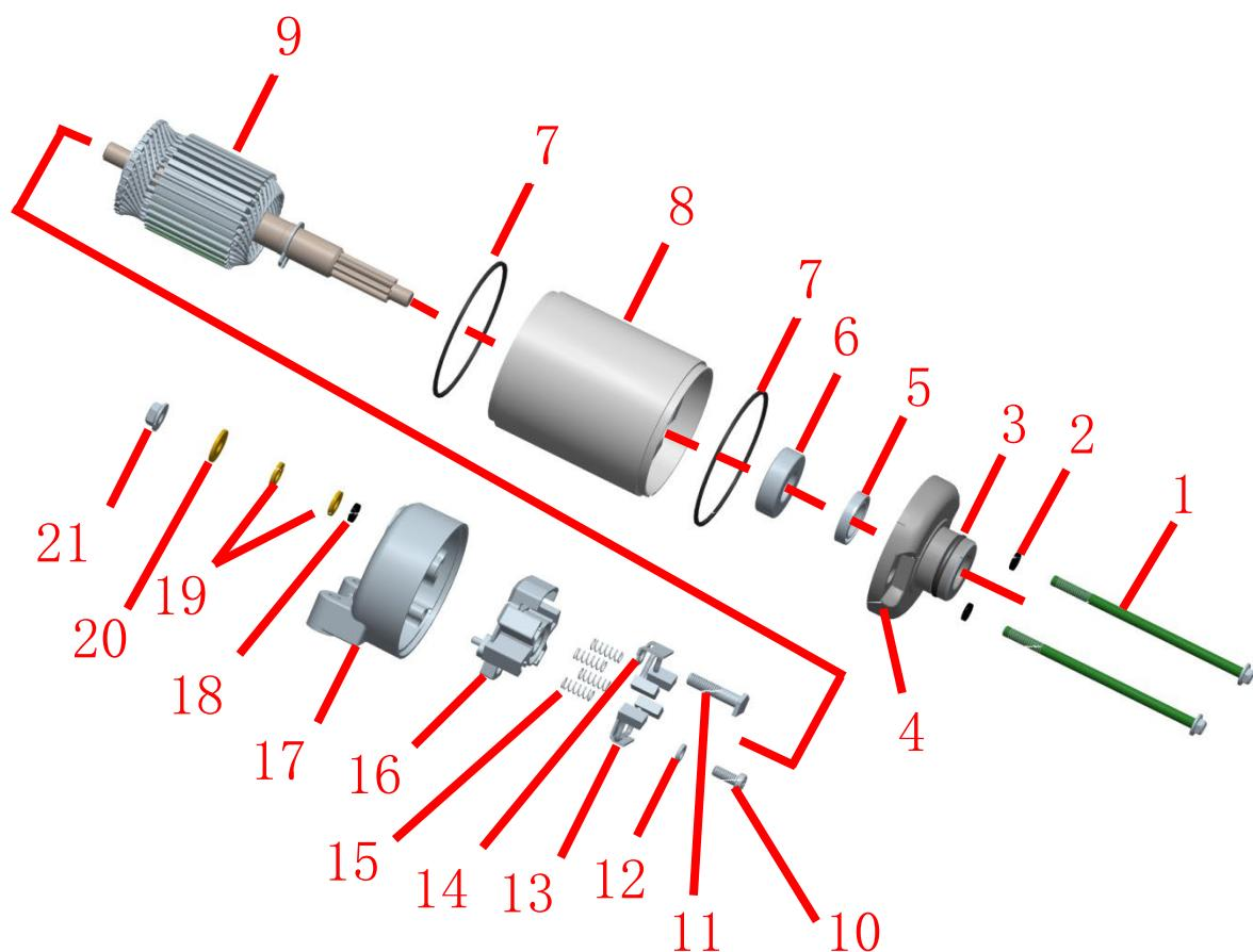
1~M5×98 螺栓×2 2~O 环×2 3~O 环 4~起动电机前盖 5~油封 6~轴承 7~矩形密封圈 8~起动电机外过壳 7~矩形密封圈 9~电枢 10~螺钉×2 11~带限位头部螺钉 12~垫圈 13~负极电刷×2 14~正极电刷×2 15~蜗簧×4 16~绝缘刷机架 17~起动电机后盖 18~密封橡胶圈 19~绝缘垫片 20 防松垫片 21 螺母
