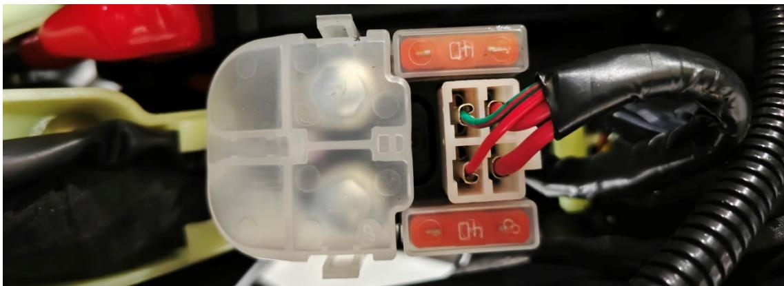
b. 解锁车辆，发动机熄火开关打到“ $\text{O}$ ”，收起侧支架，捏住制动手柄按下起动按钮应能听到起动继电器吸合的声音，否则应检查起动线路。
