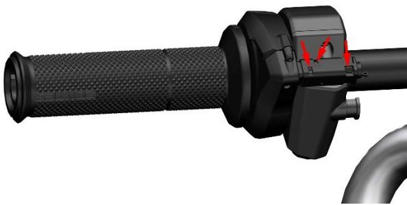
用十字螺丝刀拆下螺栓。
