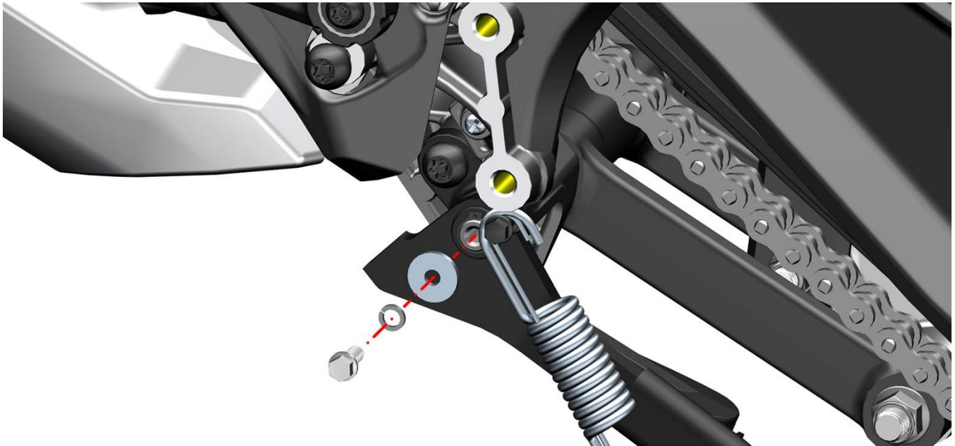
c. 参照拆侧支架弹簧的方法将主支架弹簧拆除。用 T50 梅花带孔套筒逆时针方向将主支架前部（图中 a）的螺栓拆除后，将主支架往下旋转到露出另外一颗螺栓（图中 b）。
