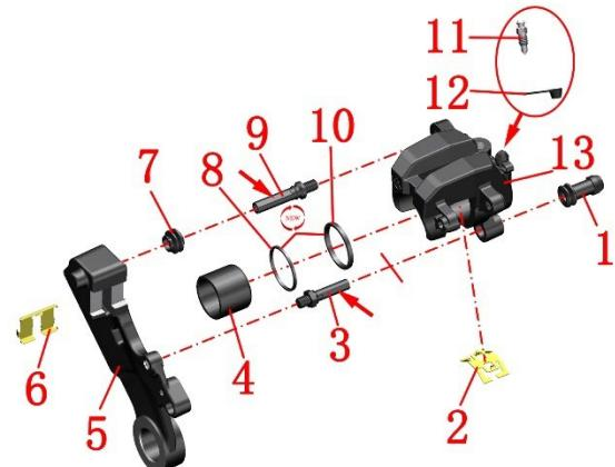
1~卡钳安装板销轴胶帽 2~弹力卡片 3~下滑动轴 4~活塞 5~卡钳安装板 6~卡片 7~卡钳销轴胶帽 8~防尘封 9~上滑动轴 10~油封 11~放气嘴 12~放气嘴胶帽 13~卡钳壳体
