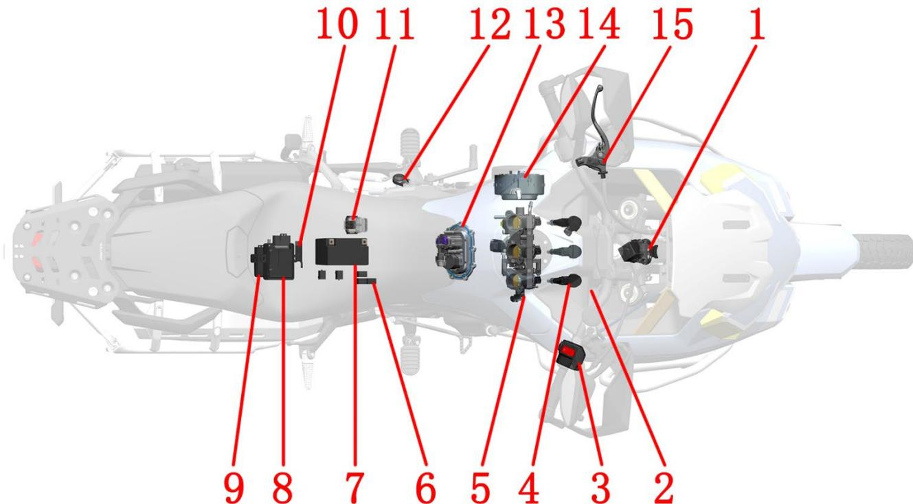
1~龙头锁 2~氧传感器 3~右手把开关 4~点火线圈 5~节气门组件 6~继电器（主线束保险盒内有3件，保险盒外侧有2件） 7~蓄电池 8~PKE 主机 9~ECU 10~倾倒开关
