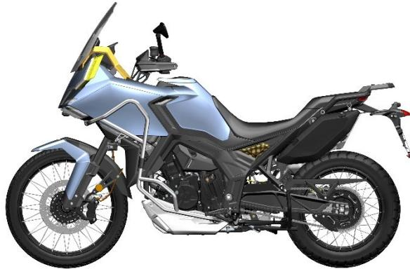
b. 使用梅花 T25 内六角拆下发动机护板前面的 2 颗 M6×16 的 2 颗螺栓(1)，并取下翻边衬套(2)。
