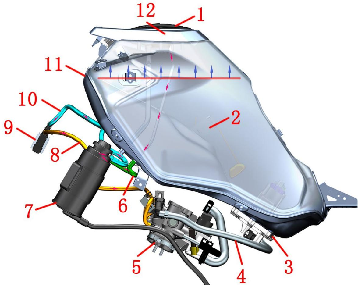
1~电子油箱锁 2~油位传感器 3~燃油泵 4~高压油管 5~节气门阀体 6~吸附/通气管 7~碳罐 8~电磁阀出气管
