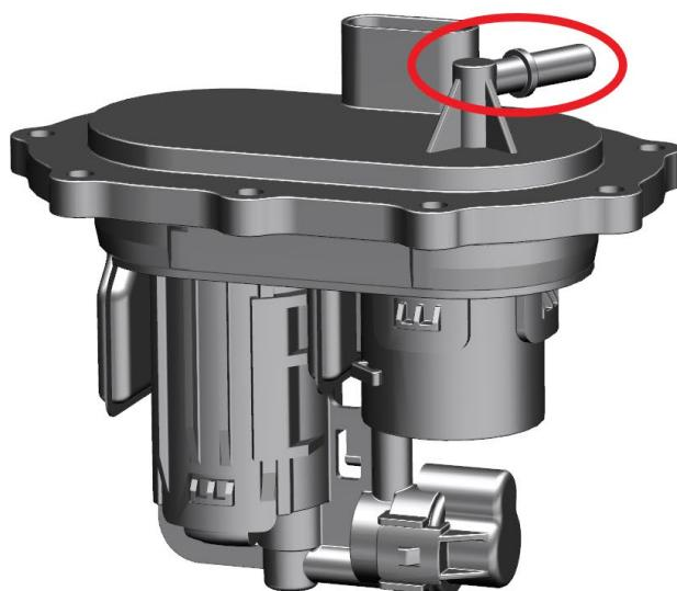
重新装配时需先对角预紧然后再拧紧 9 颗螺栓，否则燃油泵的密封胶圈压缩不均匀容易导致渗漏造成安全隐患。
