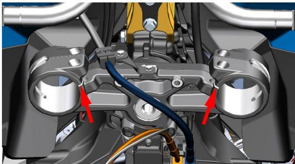
b. 使用一字螺丝刀撬开上联板上的一处缝隙，套入对应减震，将减震调至恰好露出端盖位置（如图所示）。将减震装到位后取下一字螺丝刀。使用 6#内六角拧紧上联板处的螺栓，扭力标准：25N.m。
