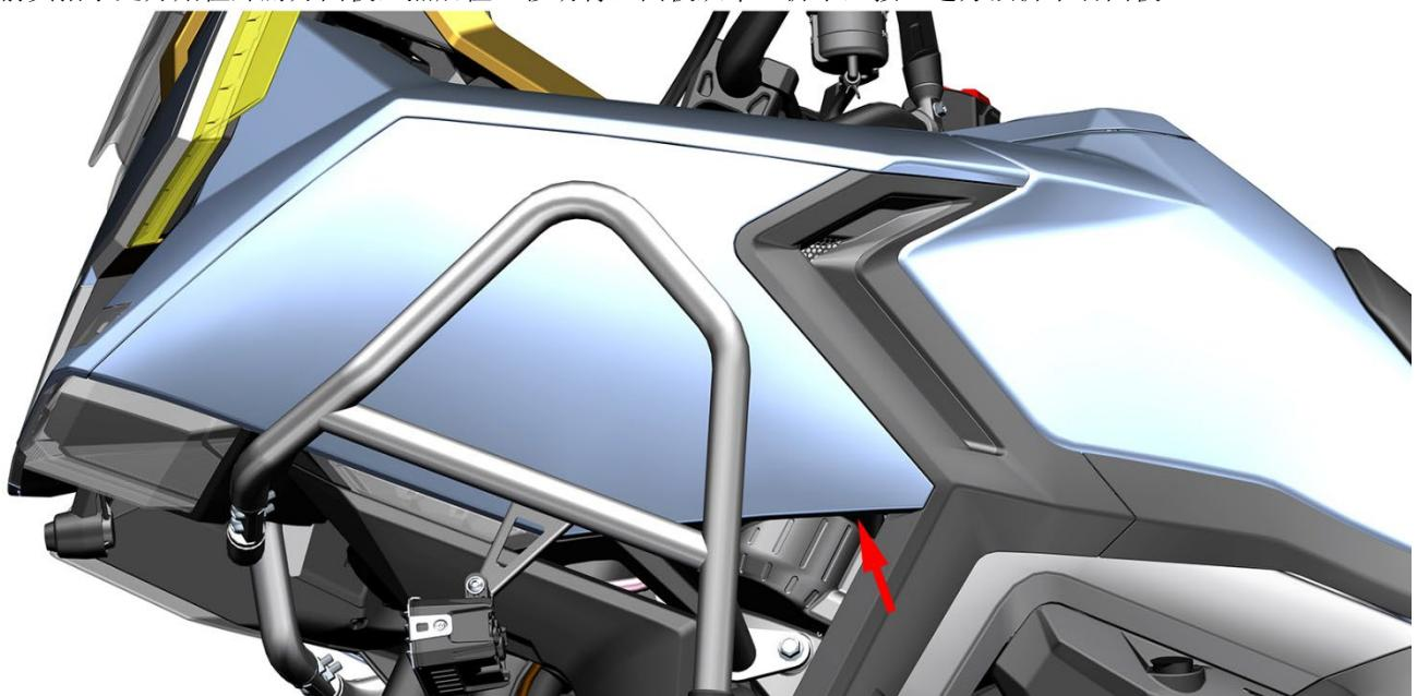
用光杆直径6mm长度150~200mm长的十字螺丝刀对准调光螺栓锯齿，逆时针旋转为调低，顺时针为调高。
