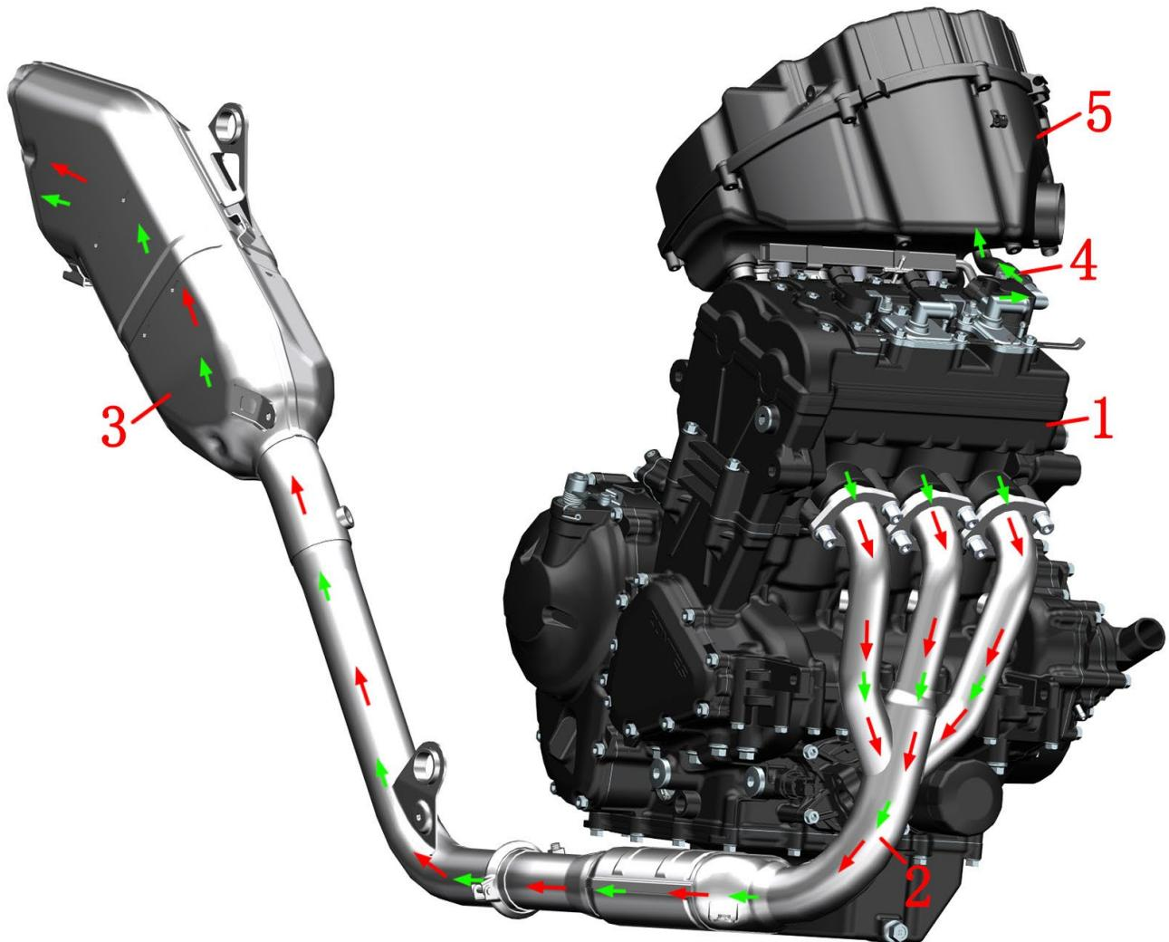
1~缸头 2~前置消声器 3~后置消声器 4~废气通气管 5~空滤器组件
