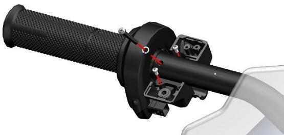
用十字螺丝刀拆下左开关的 4 件螺栓，将上下壳分离后取下。
