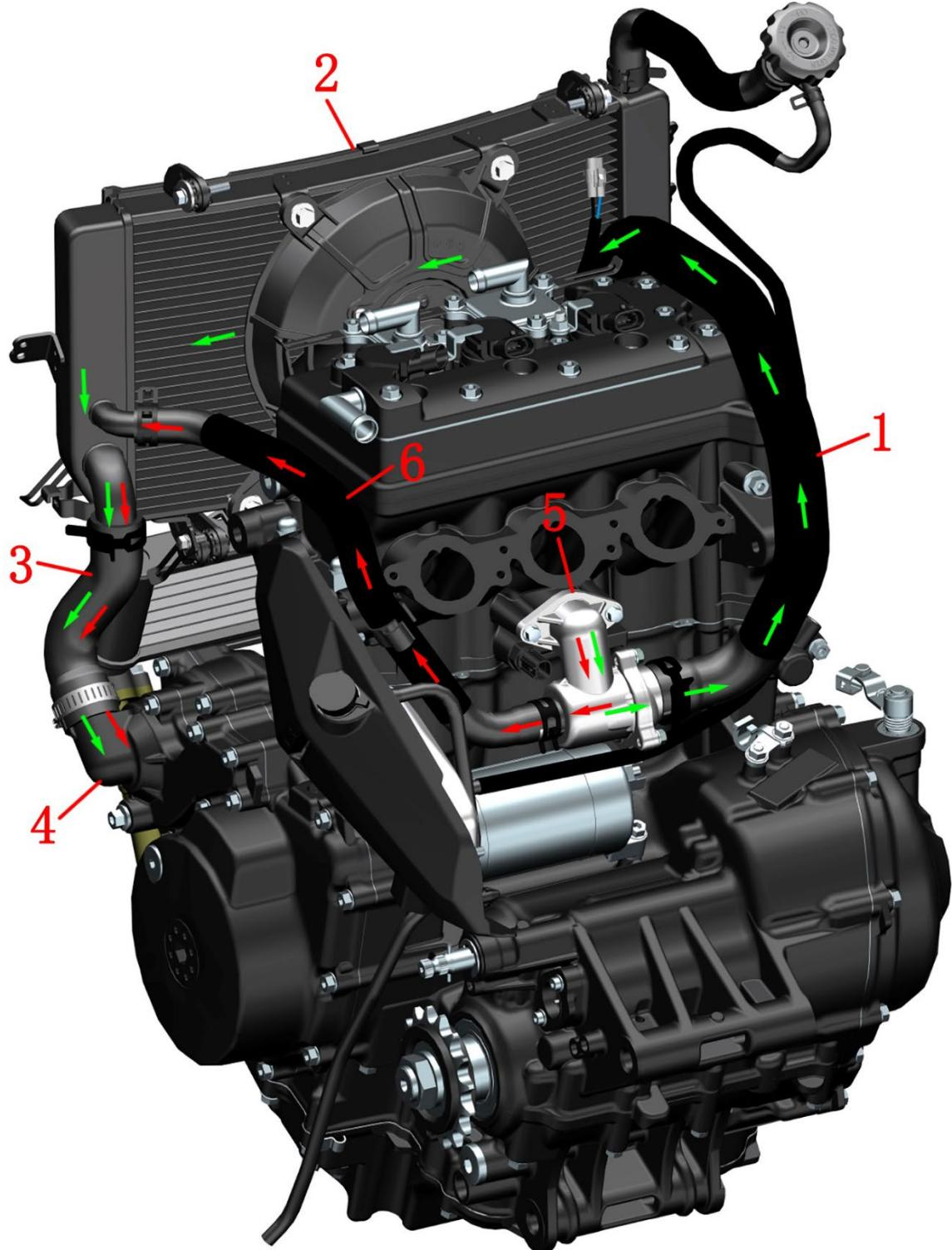
1~主水箱进水管 2~主水箱 3~发动机进水管 4~水泵组件 5~节温器组件 6~小循环水管
