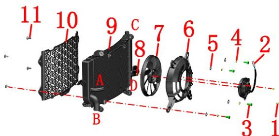
1~风扇电机螺栓\*3 2~风扇电机 3~风扇护罩螺栓\*4
