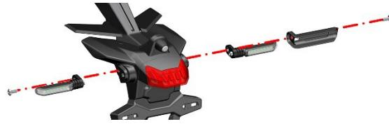
e. 先使用 4# 内六角拆下 2 颗 M6×14 内梅花轴肩螺丝和 1 颗 M6×17.5 内梅花轴肩螺丝，随后慢慢拔出后挡泥板支架盖板，取下夹板 M6×11。
