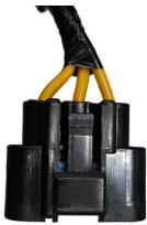
d. 检查磁电机定子侧的黄线色 3P 插头各个端子与接地是否均不导通。如电阻值或与接地导通则需要更换磁电机定子。
