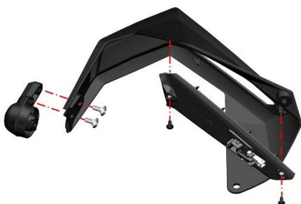
c. 如有需要则用 10#套筒拆下上方的螺母，取下左护手罩支架。用 12#开口扳手拆下底部的转接螺柱。螺母和转接螺柱的标准扭力 8~10N·m。
