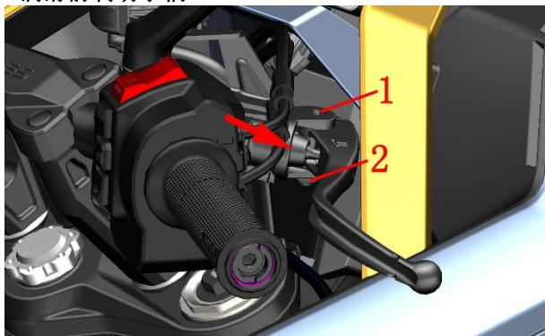
a. 先将手把护罩拆下，再用 10#梅花扳手逆时针旋转拆下螺母(2)。
