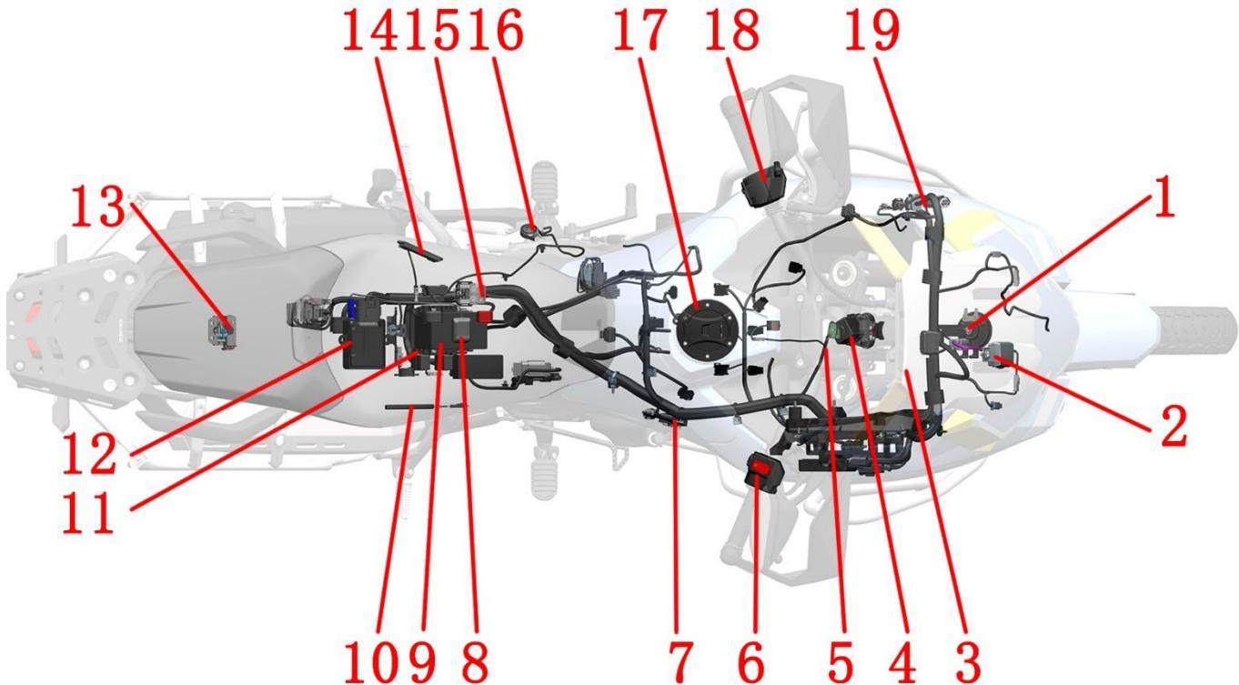
1~喇叭 2~风挡电机控制器 3~TFT 仪表 4~龙头锁 5~碳罐电磁阀 6~右手把开关 7~充电口座 8~GPS 天线 9~锂电池
