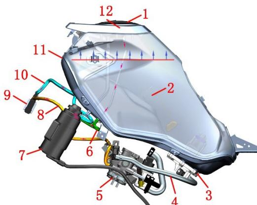
1~油箱锁 2~油位传感器 3~燃油泵 4~高压油管 5~节气门阀体组件 6~吸附/通气管 7~碳罐 8~电磁阀出气管 9~碳罐电磁阀 10~电磁阀进气管 11~燃油箱 12~油气分离器（在油箱锁内部）
