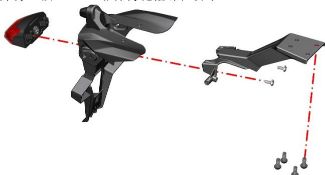
g. 首先使用十字螺丝刀拆卸底部 2 颗自攻螺钉，将后摄像头装饰罩上部从卡扣内拔出，使用十字螺丝刀拆卸摄像头卡箍配套螺栓及其垫片，然后将摄像头接口拔出并整理线束，随后将后摄像头与后摄像头装饰罩下部取出。
