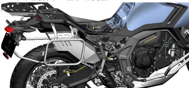
b. 用十字螺丝刀拆下膨胀钉，后将主泵拉出。用耐油塑料薄膜将主泵周围包裹好，防止制动液滴落到零部件表面损伤漆层。
