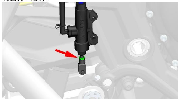
大调整：松开刹车踏板上的螺栓，将刹车踏板调至驾驶员适应的角度再拧紧螺栓即可。
