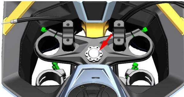
b. 用 6#内六角拆下上联板的两颗螺栓(1)，螺栓(1)扭力： $25\text{ N.m}$  ( $2.6 \text{ kgf.m}$ ,  $18 \text{ lbf.ft}$ )。用 14#套筒拆下固定垫块的两颗螺栓(2)，取下垫片、缓冲胶、衬套。螺栓(2)扭力： $60\text{ N.m}$  ( $6.1 \text{ kgf.m}$ ,  $44 \text{ lbf.ft}$ )。（装回时螺栓(2)需涂上适量的螺纹紧固胶）
