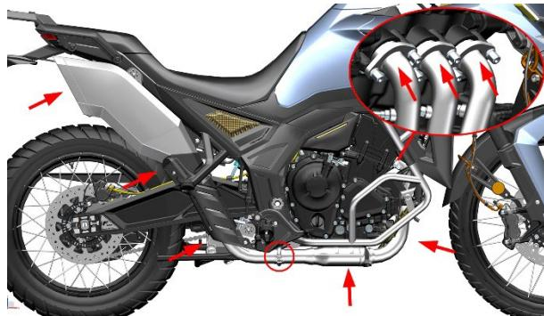
b. 如发动机和消声器的连接处有轻微漏气可先尝试用 6#内六角紧固排气口螺母(3)；如问题未解决则需将消声器拆下，更换新的发动机排气口密封垫(4)。具体拆卸方式可参照消声器的拆卸。
