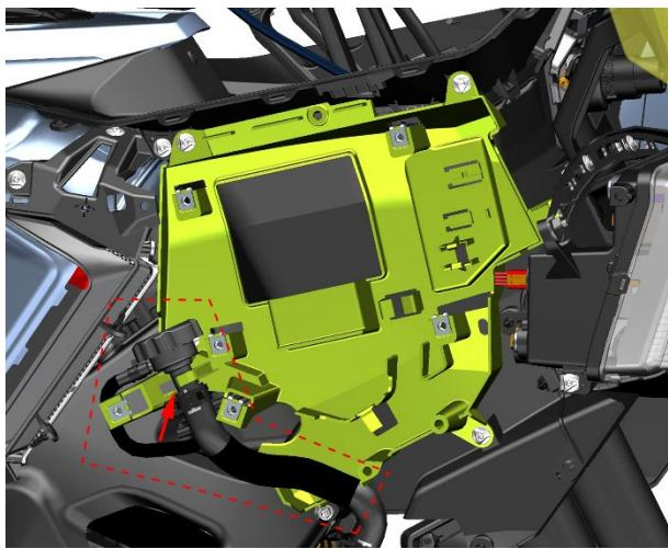
e. 使用 T25 内六角梅花扳手拆下四颗 M6×14 的轴肩螺栓①和一颗 M6×16 的轴肩螺栓螺栓②。
