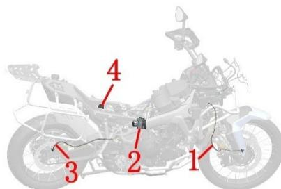
1～前轮轮速传感器 2～ABS 液控单元 3～后轮轮速传感器 4～OBD 诊断接口
