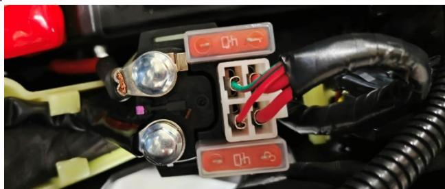
重新安装时继电器，红色线安装在继电器标注“B”的螺纹孔上，黑色线安装在继电器标注“M”的螺纹孔上。确保螺钉拧紧后将保护帽盖好，然后插上继电器连接器。
