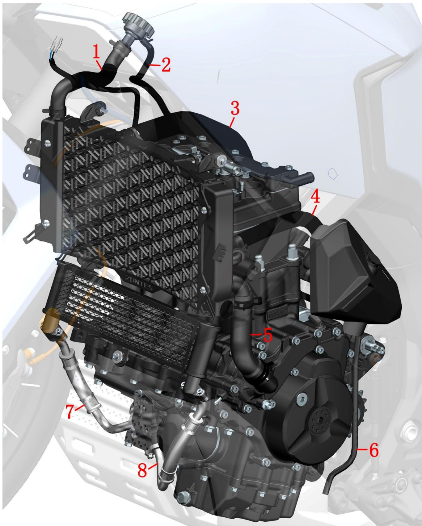
1~ZT703-F 水箱加水口连接水管 2~ZT703-F 副水箱连接水管 3~ZT703-F 主水箱进水管 4~ZT703-F 小循环水管
