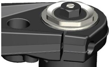
c. 将下联板 2 颗 M8×35 的螺栓装上，使用同样的方法装入另一根减震。
