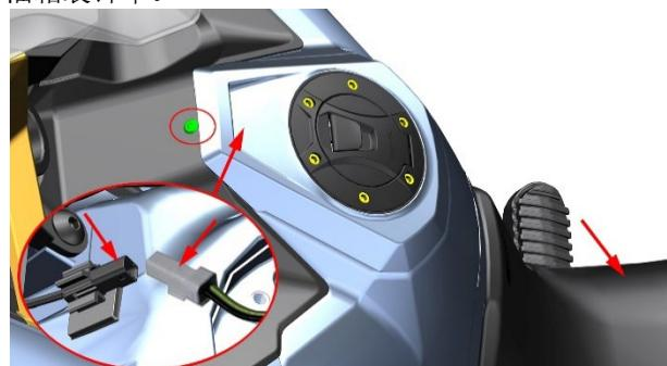
b. 将左、右包围面板的卡扣拔出后，分别拆下左、右包围面板
