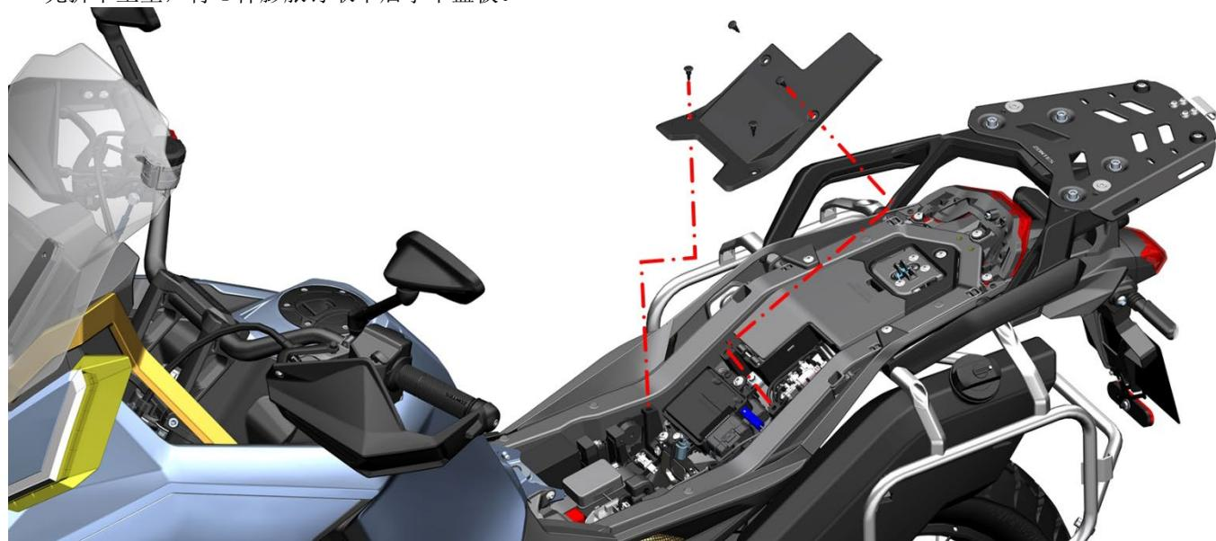
按下防脱卡扣，将插头拔出。使用4#内六角拆下两颗螺栓即可取下倾倒开关。
