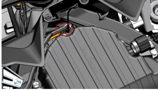
c. 将碳罐组件(1)按照大箭头方向从空滤器左侧进气腔组件(2)上取下，并将碳罐组件(1)上的橡胶管①按小箭头方向抽出，取下碳罐组件(1)。
