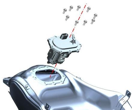
重新装配时需先对角预紧然后再拧紧9颗螺栓，否则燃油泵的密封胶圈压缩不均匀容易导致渗漏造成安全隐患。
