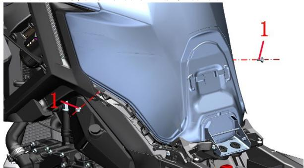
f. 用挑针将左包围下部箭头所指方向的2颗膨胀钉拆下，右侧用同样方法拆下。
