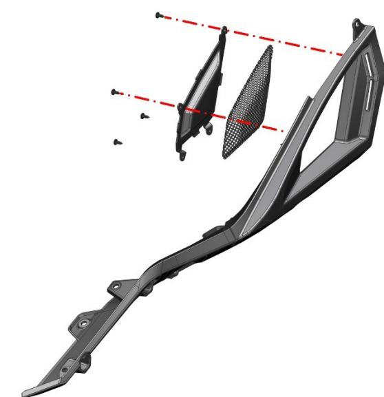
f. 拆下固定在右尾裙与右侧盖上的膨胀钉，随后把右侧盖拆下；左侧盖同样拆法。
