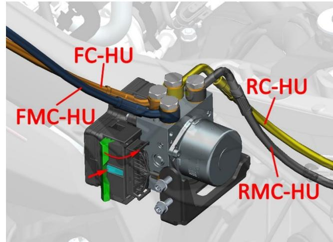
FMC~HU：前碟刹主泵～液控单元
