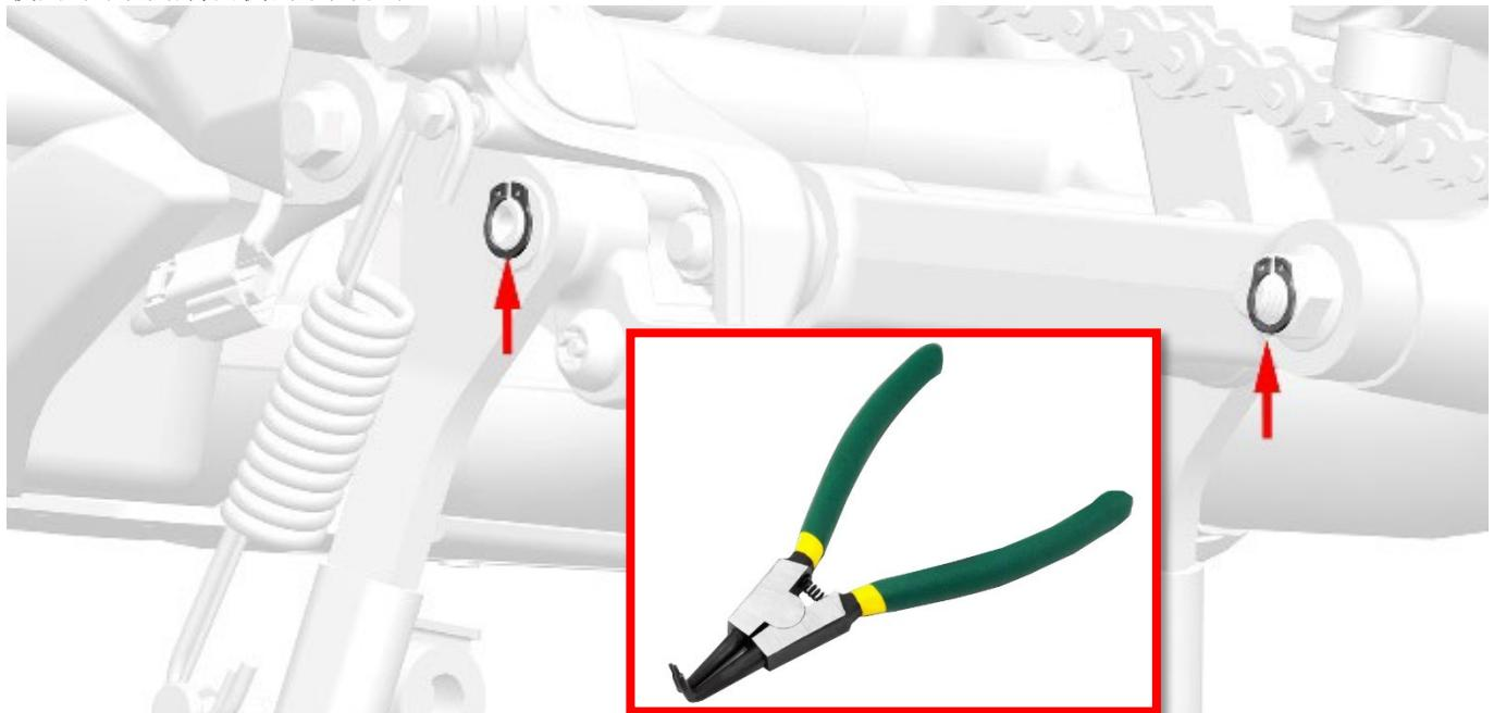
e. 将主支架装配块往上旋转并往内侧移动，退到左车架的缝隙中。将主支架往车辆右侧平移即可从车辆上取下主支架。
