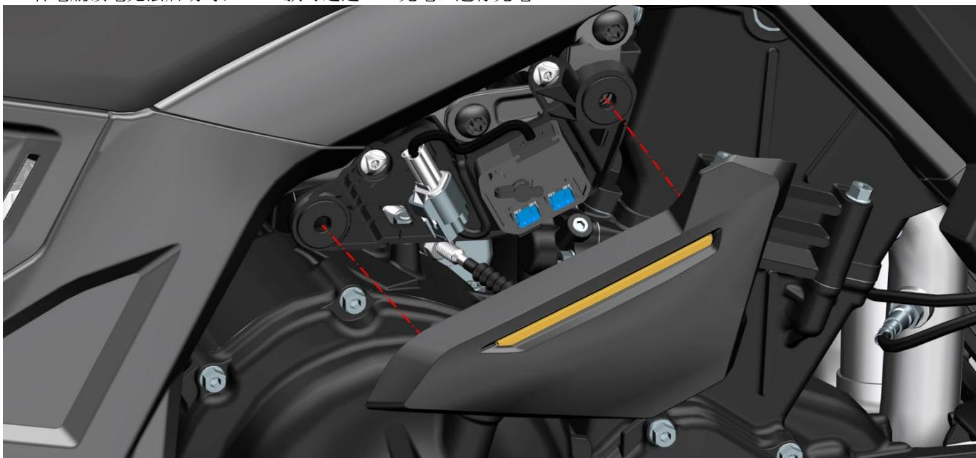
2024 款掀开胶塞插入原厂标配的充电器 DC 插头。再将 AC 座插入 110~220V 电源。如使用劣质充电器导致电池损坏的不在三包范围。
