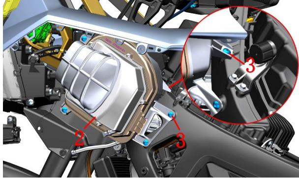
b. 使用4#内六角从空滤器左侧进气腔组件(2)的缝隙中穿过拧松空滤器连接管组件(5)上的Φ59×9管箍组件(4)，然后将空滤器左侧进气腔组件(2)按箭头方向拔，取下空滤器左侧进气腔组件(2)。
