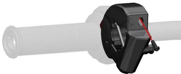
将右开关上盖移开后用十字螺丝刀拆固定开关下部的两颗螺钉，后再拆下限位螺栓和弹垫将右手把胶套取下。
