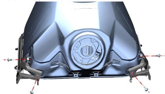
d. 将左、右包围网饰衬板组件按箭头方向推，推至孔位后取下组件。
