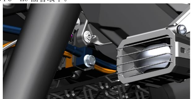
d. 用 5#内六角拆下固定油管的螺栓，松开 FC~HU 油管。
