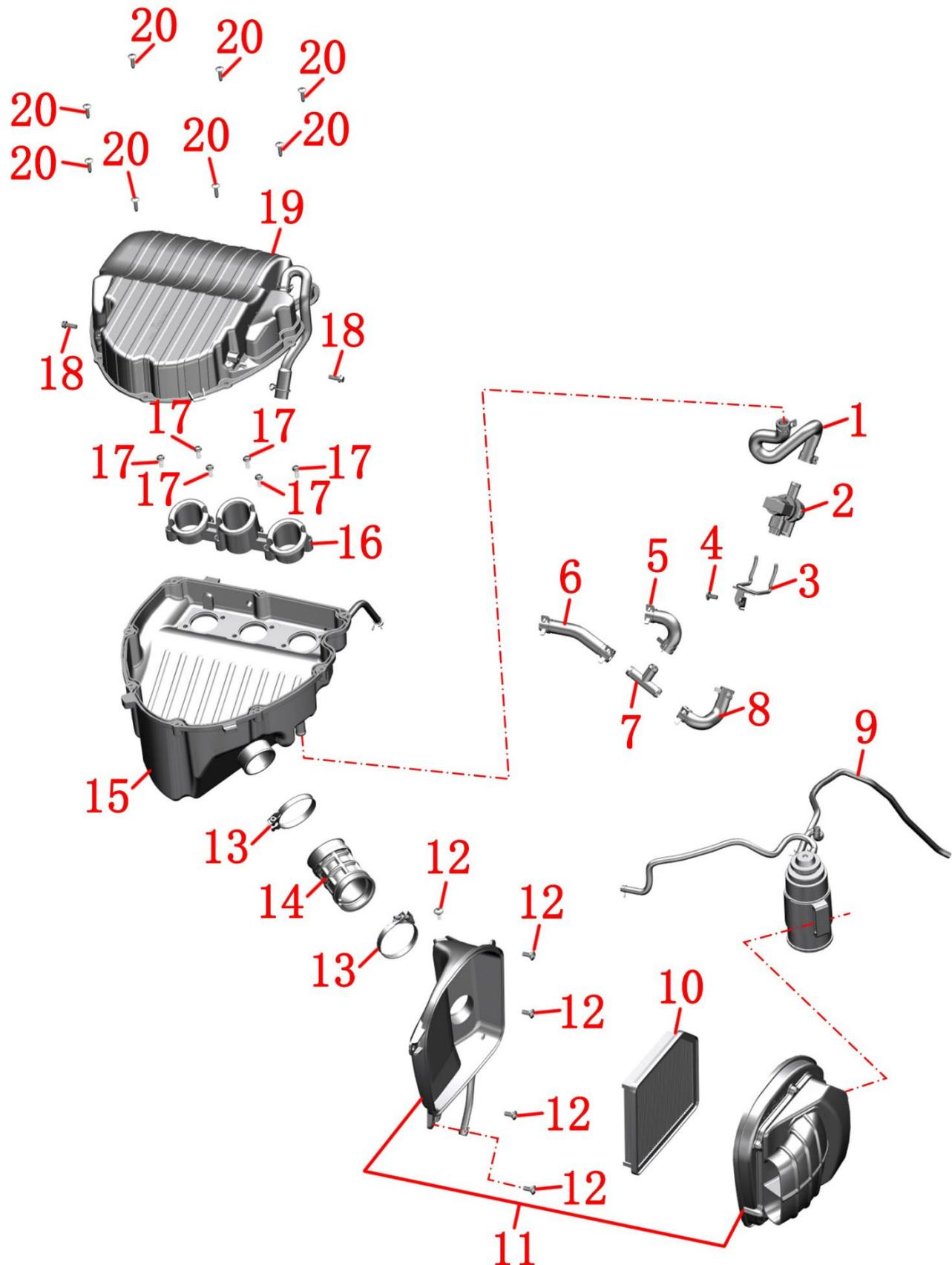
1~ZT700~F 补气阀橡胶管~4 2~YH 二次补气阀 3~703F 补气阀支架 4~非标内梅花螺栓 M6×12 (304 不锈钢)
