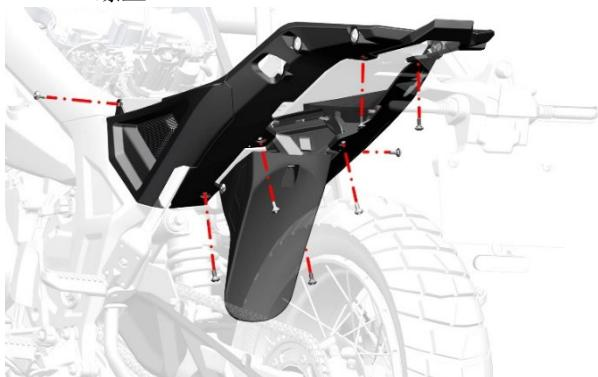
b. 使用 4#内六角拆下固定在内泥板上的 3 颗 M6×14 内梅花轴肩螺丝，随后取下内泥板。
