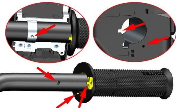
c. 安装前碟刹半盖或离合摇臂半盖时需将半盖与碟刹主泵或半盖与离合摇臂的结合面对齐方向把上的圆孔，再使用 8#套筒拧紧螺栓。注意需先打紧顶部螺栓，再锁紧底部。
