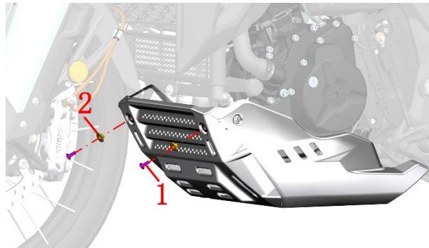
c. 使用梅花 T25 内六角拆下发动机护板的 3 颗螺栓(1)和翻边衬套(2)，取下发动机护板。
