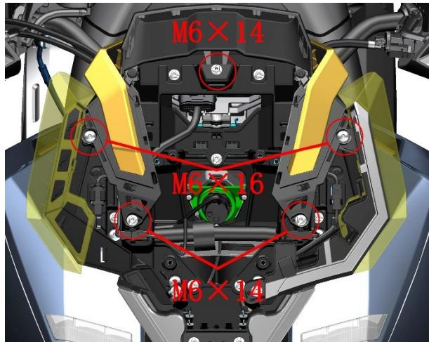
b. 拆下包围面板后，使用十字螺丝刀拆下如图所示的自攻螺钉。左右两侧用同样方法拆下。
