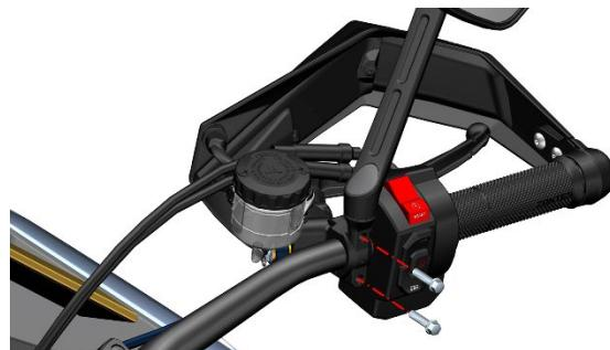
c. 将前刹主泵倾斜让螺栓朝上，佩戴好防水手套后用12#套筒拆下螺栓，取下铜垫后移开FMC~HU油管，将主泵内的制动液倒出。螺栓标准扭力：32N·m(3.3 kgf·m, 24 lbf·ft)。
