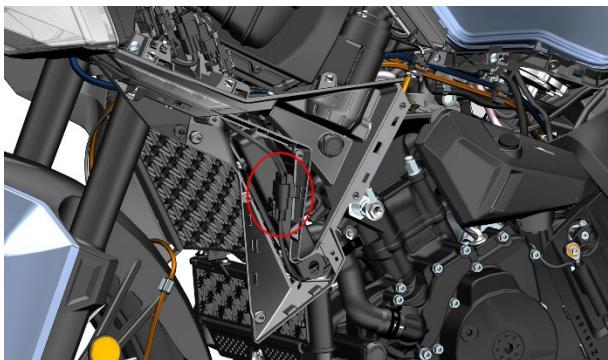
d. 使用 8#套筒拆下发动机进、出油管上的 4 颗螺栓(9)；再使用 8#套筒拆下固定油冷器的 1 颗螺栓(10)。然后将油冷器往车头方向旋转到合适位置。注意：进、出油管脱离油冷器可能会滴落少量机油。
