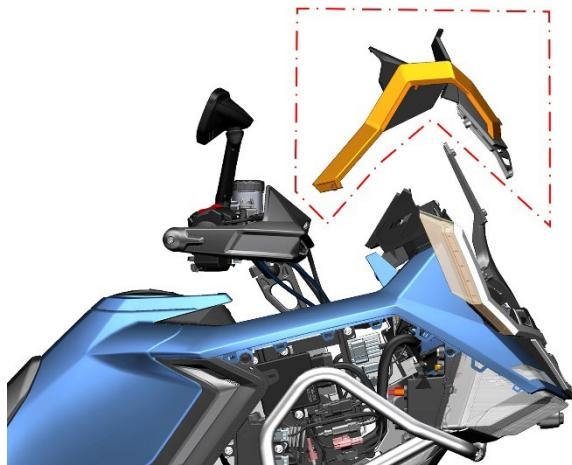
d. 使用十字批即可拆解整个装饰罩总成，安装位置关系如下图所示。
