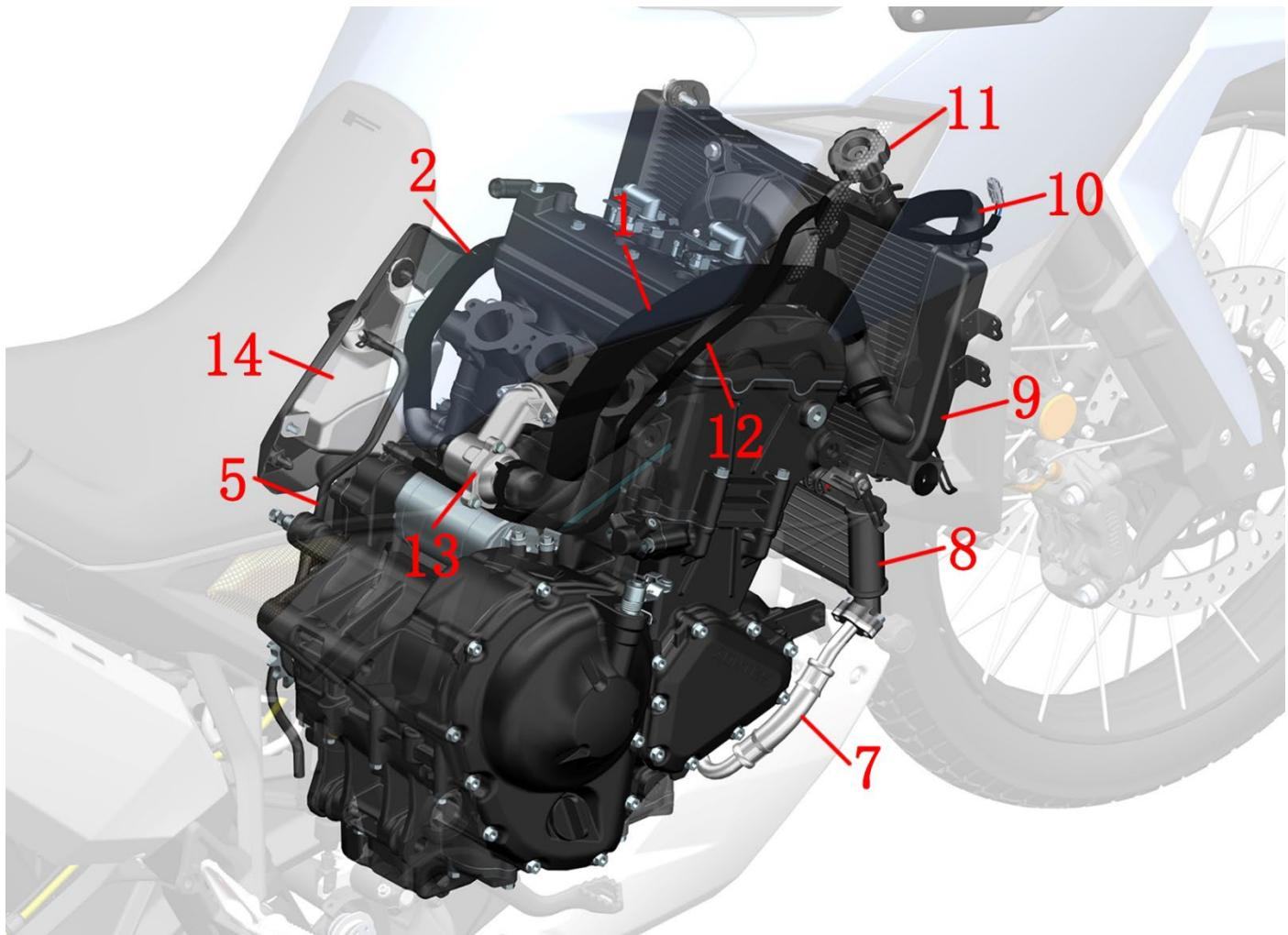
1~ZT703-F 主水箱进水管 2~ZT703-F 小循环水管 3~ZT703-F 发动机进水管 4~水泵盖组件 5~ZT310-R 副水箱漏水管 6~ZT703-F 发动机出油管 7~ZT703-F 发动机进油管 8~ZT703-F 油冷器 9~ZT703-F 主水箱
