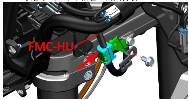
c. 用 10#套筒拆下固定油管的螺栓，将 FMC~HU 油管和 FC~HU 油管取下。
