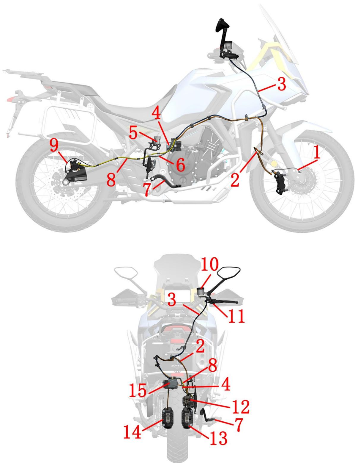
1~轮速传感器（前轮） 2~FC~HU 制动软管 3~ FMC~HU 制动软管 4~ RMC~HU 制动软管 5~后碟刹主泵 6~后刹车开关 7~刹车踏板 8~ RC~HU 制动软管 9~轮速传感器（后轮） 10~前碟刹主泵 11~前刹车开关 12~后碟刹总成 13~前碟刹总成（右） 14~前碟刹总成（左） 15~液控单元
