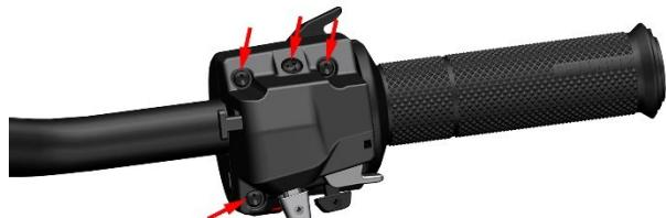
掰开胶套露出螺栓后再用十字螺丝刀拍下固定胶套的螺栓和弹垫将左手把胶套取下。
