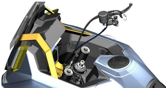
b. 为便于讲解此处隐去其它零部件。先将防松垫圈(1)往上移再松开调节螺母(2a)。
