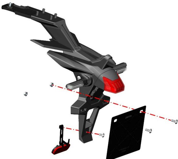
d. 使用 4# 内六角拆下左边 1 颗 M6×25 非标螺栓，取
