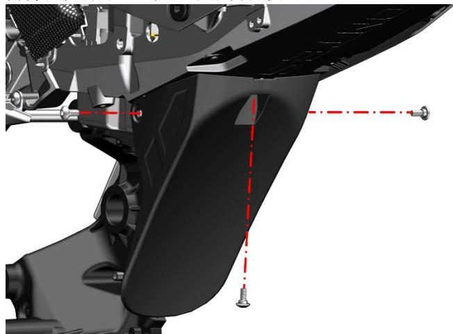
c. 先使用 4#内六角拆下固定在尾群上部的 2 颗 M6×14 内梅花轴肩螺丝。然后抓住右尾群组件的 a、b 处沿着缝隙逐渐把组件往外拔出，再依次将 c 处拔出。
