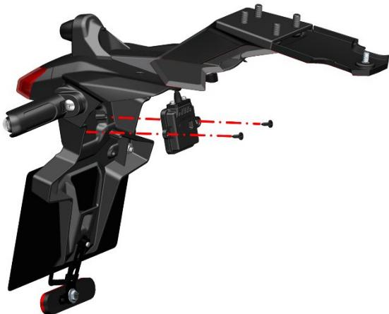
c. 使用 4# 内六角拆下固定广告牌前方的两颗 M6×16 非标内梅花螺栓，并拧出固定螺栓的两颗 GB6177 螺母，后广告牌斜上方取出，并使用 4# 内六角拧出一颗 M6×14 内梅花轴肩螺丝，取下后反射器支架与后反射器。
