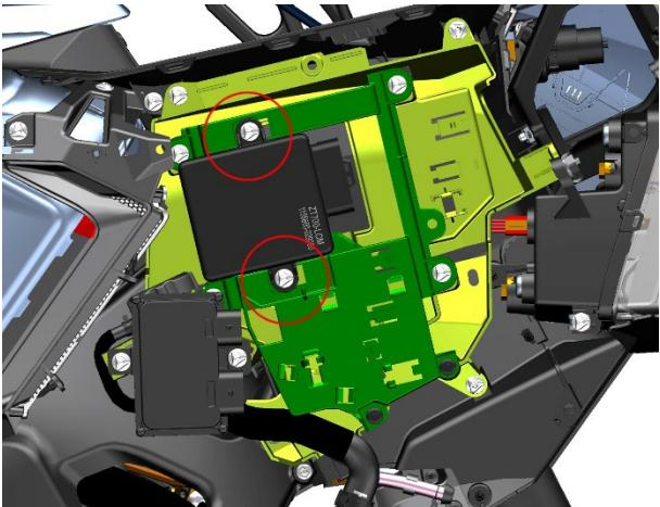
b. 使用 T25 内六角梅花扳手拆下四颗 M6×14 的轴肩螺栓螺栓，两颗颗膨胀钉，取下 ECU 固定支架。
