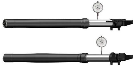
变形量 $<0.2\text{mm}(0.008\text{ in})$ 的轻微变形可用 V 形铁块将前叉管支撑好并在接触面放置软胶或橡胶、铜片等防止前叉管划伤，使用压力机缓慢小压力小行程分多次校直，边校直边测量，矫正后径向跳动应 $<0.05\text{mm}(0.002\text{ in})$ 。若矫正后原弯曲变形部位失圆则应更换。过大的变形则应更换减震。
