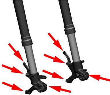
c. 若前叉管上附着大量液压油，则先擦拭干净后骑行观察。若无油迹或轻微油迹则为防尘封处装配时积存的液压油，可判断为油封未漏油。若附着少量油渍或油泥混合物则拆下防尘封后擦拭干净前叉管和油封表面，先压缩一次前减震再擦拭干净再压；重复 10 次上述操作。观察前叉管上是否仍然有，若有则前减震漏油需更换防尘封和油封，若无则是装配时积存的少量液压油为正常现象。
