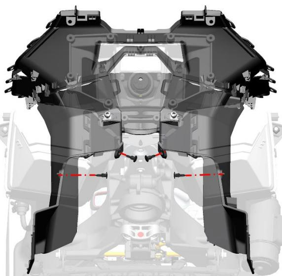
b. 使用 T25 梅花内六角拆下车辆左侧的一颗 M6×14 轴肩螺栓螺栓，注：右侧 M6×14 螺栓拆布线版时已拆下。
