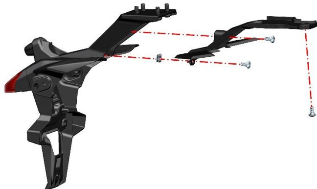
f. 先使用 4# 内六角拧松 2 颗 M6×14 内梅花轴肩螺丝，然后慢慢将尾灯拔出取下，随后拔出后挡泥板支架，并将 4 颗 M8×18 非标梅花槽螺栓拆下。
