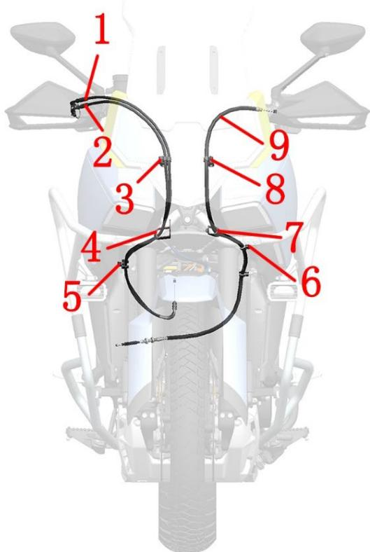
1~加油线 2~回油线 3~右手把走线支架 4~油门线限位支架 5~油门线线夹 6~离合线线夹 7~离合线限位支架
