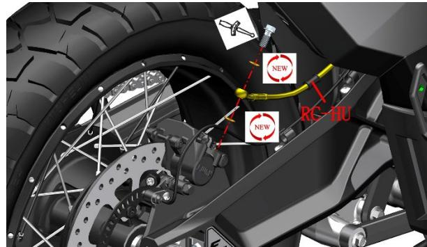
b. 参照拆后轮和更换制动版的步骤将后卡钳和制动片先拆下。
