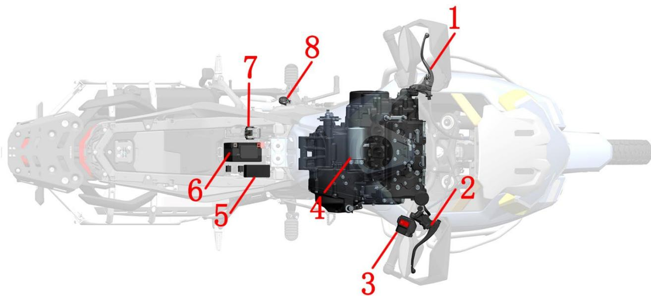
1~离合摇臂（离合开关） 2~前碟刹主泵（前刹车开关） 3~右手把开关 4~起动电机 5~保险盒 6~蓄电池 7~起动继电器 8~侧支架熄火开关
