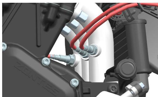
新的传感器螺纹处涂有专用的膏状的螺纹防烧结剂，防止漏气和便于后续再次拆卸。若拆下旧的检查没问题后在安装前也需在螺纹处涂抹适量的防烧结剂。
