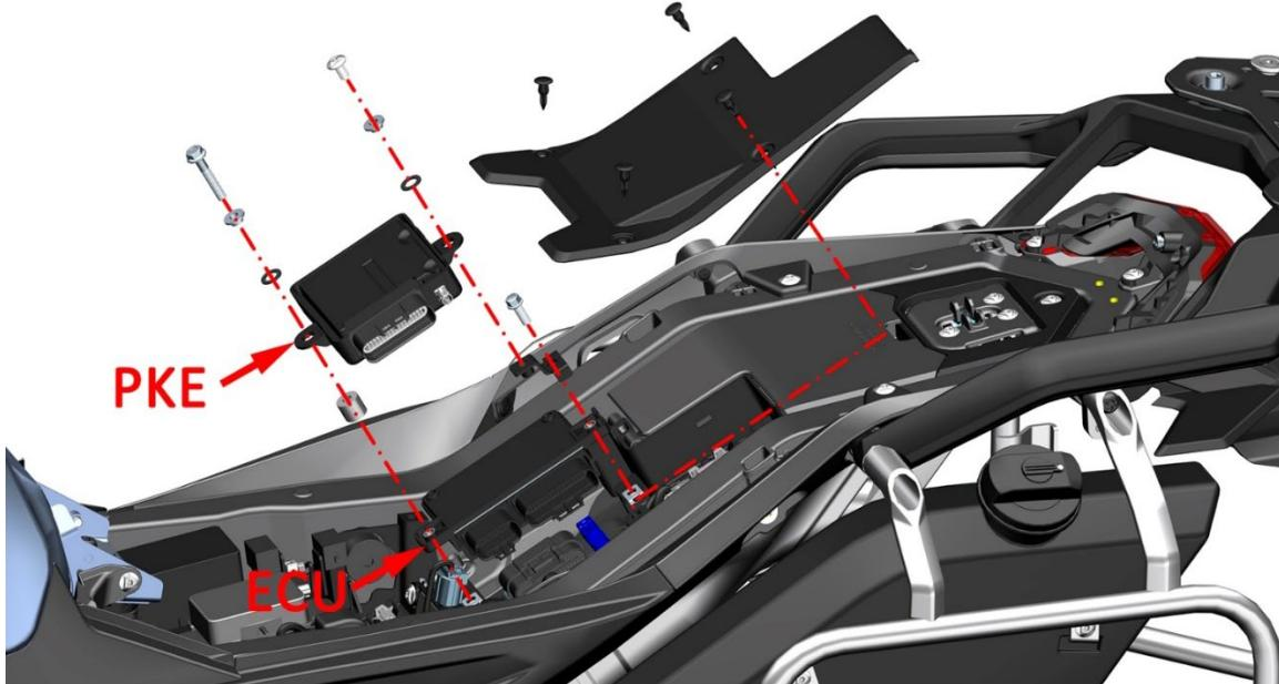
注意：更换 ECU，需要将整车关机后等待 10 秒再进行操作，避免电喷系统异常。
