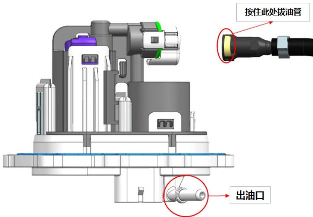
若需从车辆上拆下燃油泵，可用抽油泵将燃油箱内的燃油抽空。将油箱组件翻转到背面用 2025 年 6 月底到 8 月底的部分车型使用 8#套筒，其它使用 10#套筒拆下 9 颗螺栓，即可拆下燃油泵。
