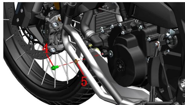
b. 可以参考主水箱添加冷却液步骤拧开加水口盖，加速冷却液的流出。
