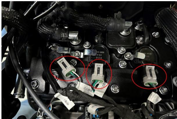
d. 使用 10# 套筒拆下 2 处点火线圈压板，并取出 3 个点火线圈。
