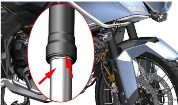
b. 检查底筒是否掉漆；前挡泥板、前轮空心轴和前刹车卡钳的安装点是否断裂或开裂的迹象。检查底筒底部是否有渗漏。
