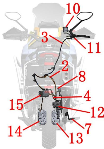
1~轮速传感器（前轮） 2~FC~HU 制动软管 3~ FMC~HU 制动软管 4~ RMC~HU 制动软管 5~后碟刹主泵 6~后刹车开关 7~刹车踏板 8~ RC~HU 制动软管 9~轮速传感器（后轮） 10~前碟刹主泵 11~前刹开关 12~后碟刹总成 13~前碟刹总成（右） 14~前碟刹总成（左） 15~液控单元
