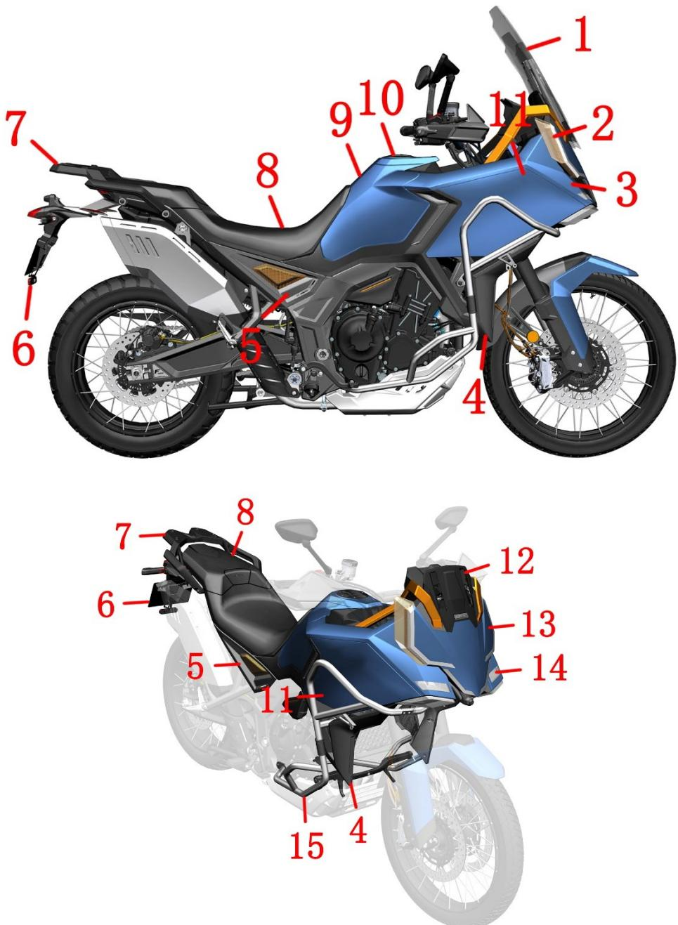
1. 挡风玻璃 2. 前右位置灯 3. 右包围上部 4. 右包围下部 5. 右侧盖 6. 后挡泥板 7. 后扶手 8. 坐垫 9. 油箱 10. 油箱装饰罩 11. 右包围面板 12. 风挡内衬 13. 头罩面板 14. 前左大灯 15. 护杠
