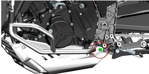
f. 使用带中孔的 T50 梅花内六角拆下 1 颗 M10×25 的螺栓，取下右护杠。
