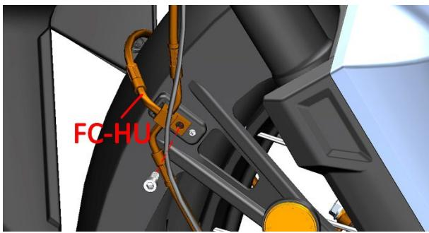
e. 解开左车架内侧的两根油管，将两根油管从前面抽出。
