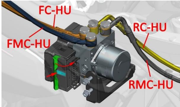
c. 用 8#套筒拆下主车架左侧的 2 颗螺栓，将液控单元和支架组件从车上拆下。
