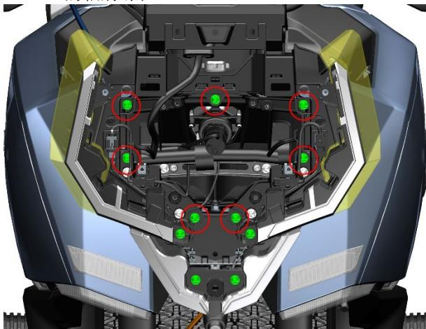
b. 拆下车头下方一颗膨胀钉
