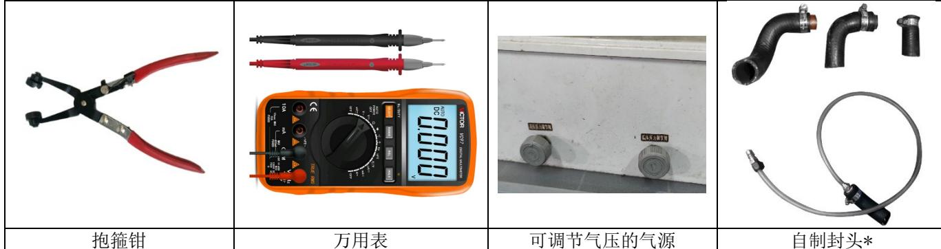
\*可用软胶塞封堵，或用软管对折后用绳子或铁丝捆绑好作为小管的堵头用于测试水箱加水口密封性。可找内径为16mm的水管截取一段，一头用合适的气管接头加卡箍装配牢固用于测试水箱加水口和主水箱、小水箱的密封性。
