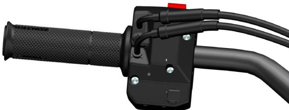
d. 使用十字螺丝刀拆下左手把开关后壳的两颗螺栓，取下左手把开关后部，再将固定前部的螺栓拆下。取下开关前部。
