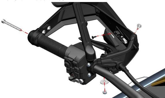
b. 用十字螺丝刀拆下手把手护罩上的 2 颗自攻钉，拆转向灯。用 T25 梅花扳手拆下两颗螺栓，将平衡块和护手罩分离。
