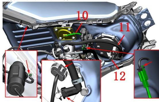
j. 参考拆空滤器步骤先将空滤器拆下，按箭头方向按下防脱锁扣后拔出高压油管。更换新的高压油管后参照拆卸步骤还原。
