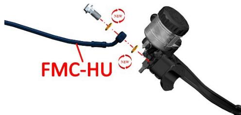
d. 参照添加制动液步骤拆除上盖；参照“维修”中的检查刹车配件拆除刹车开关和制动手柄。
