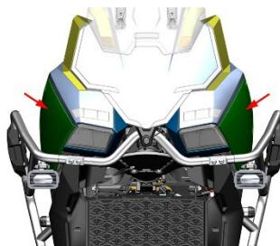
c. 用带中孔的 T45 梅花扳手将 2 颗梅花槽带柱盘头螺栓(3)拆下，取下 2 颗油箱平垫(4)和压胶(5)。用 T25 梅花扳手拆下 2 颗内梅花轴肩螺栓(1)。用十字批拆下 2 颗膨胀钉(2)。
