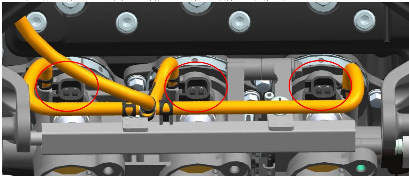
如需更换喷油器，待发动机和消声器冷却后才能进行。用十字螺丝刀拆下固定滑轨的两颗螺钉后将油轨和喷油器一同取下。用一字螺丝刀撬开喷油嘴的卡扣即可取下喷油器。
