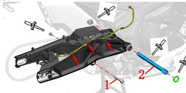
c. 用 T25 梅花扳手拆下 7 颗螺栓，取下油管夹和防磨块。用 13#开口扳手拆下后平叉凹槽处的两颗螺栓和螺母。
