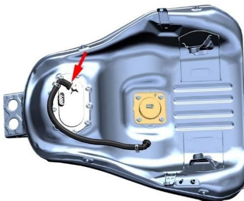
拆装油箱时，拆掉油箱固定螺丝后一定要先从油箱尾部轻轻抬起，抬高至手能够刚好伸进去即可，然后拔掉与油泵相连的高压油管，需要注意高压油管不能硬拉硬扯，一定要先按住高压油管接头上面的卡扣处（如下图），再顺着出油口方向往外拔，不然容易把油泵出油口拉扯断裂。
