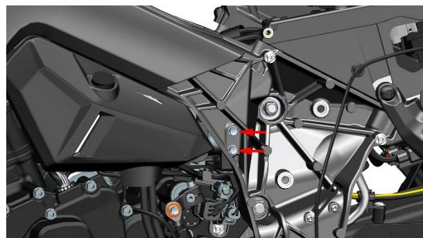
d. 抓牢液控单元后用 T25 梅花扳手拆下两颗 M6×16 螺栓，即可将液控单元拆下。如需更换支架，则需将翻边衬套和缓冲胶取下。
