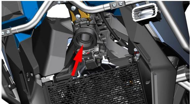
b. 依次在下联板上方放入涂抹好润滑脂的轴承、轴圈、防尘盖，再拧入 1 颗方向柱调节螺母，使用四爪套筒将方向柱调节螺母拧紧，扭力：50N·m(5.1 kgf·m, 37 lbf·ft)，确保上联板不上下串动后将方向柱调节螺母逆时针松 1/4 圈，最后使用扭力扳手拧紧，扭力：13N·m(1.3 kgf·m, 10 lbf·ft)。在方向柱调节螺母上放入胶垫；再拧入第二颗方向柱调节螺母，将第二颗方向柱调节螺母拧到与第一颗方向柱调节螺母的缺口对齐，放入调节螺母防松垫圈。
