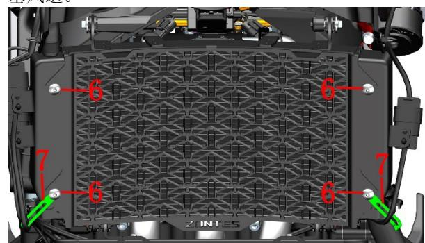
b. 用平的雕刻刀或小号一字螺丝刀等将变形的鳍片拔正。若变形的鳍片超过 20% 则需更换新的散热器。
