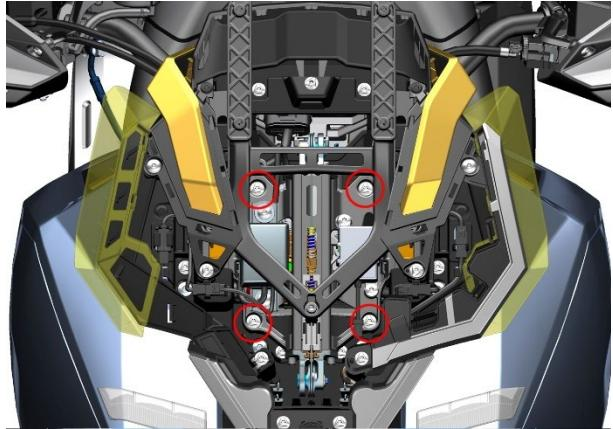
b. 使用 4#内六角拆下左右两侧的两颗膨胀钉，使用 T25 内六角梅花扳手松开两颗 M6×14 轴肩螺栓和两颗 M6×16 轴肩螺栓。松开头罩左右部饰件，稍微拉开，将风挡升降组件取出。
