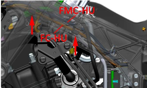
f. 在车辆右侧（靠近右上护杠）处找到轮速传感器的插头，按下防脱卡片后拔出插头。
