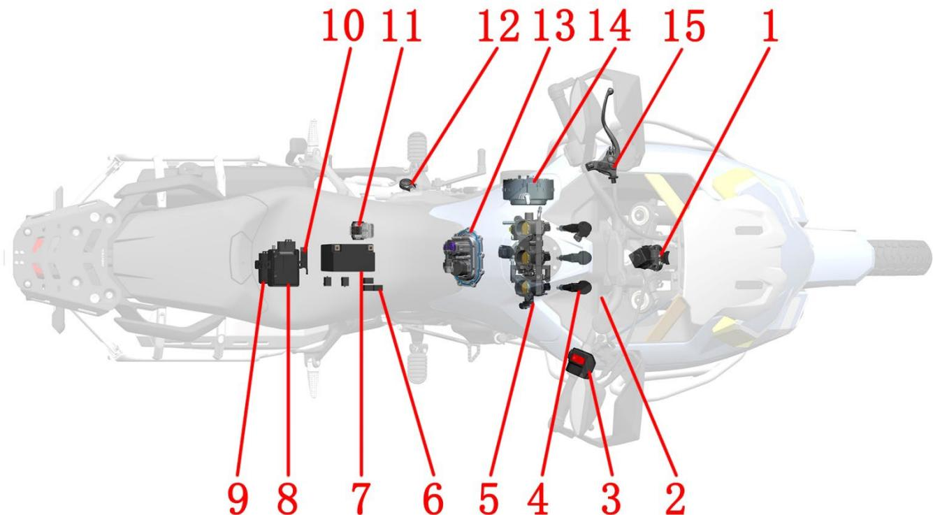
1~龙头锁 2~氧传感器 3~右手把开关 4~点火线圈 5~节气门组件 6~继电器 7~蓄电池 8~PKE 主机 9~ECU 10~倾倒开关
