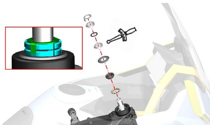
d. 将垫块和上联板安装好，放入垫片，最后拧入盖形螺母，扭力：100N·m (10.2 kgf·m, 74 lbf·ft)。
