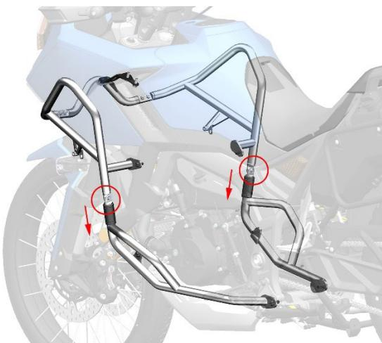
e. 使用带中孔的 T50 梅花内六角拆下 1 颗 M10×20 的螺栓，取下左护杠。
