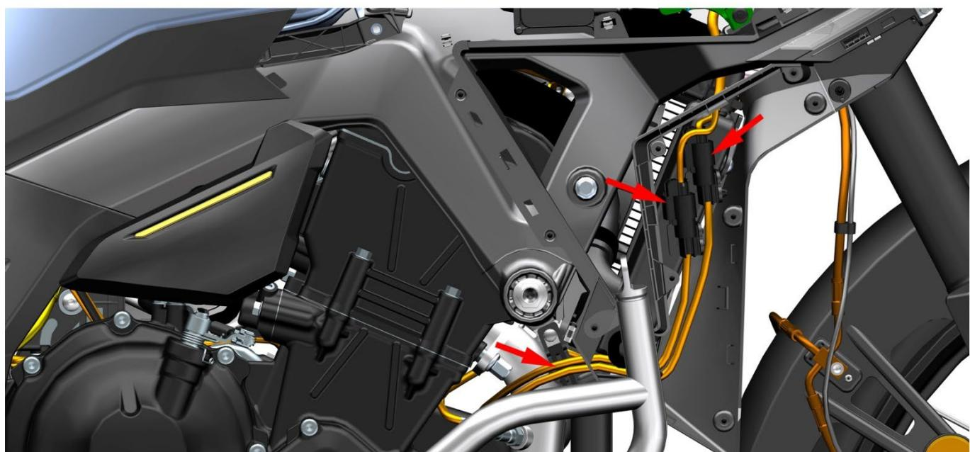
拆除覆盖件后，可以看见氧传感器固定方式如上图所示，将蘑菇头从固定孔挤出。
