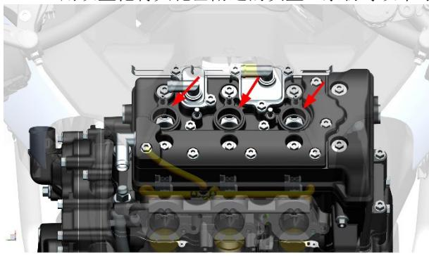
f. 用随车自带的随车工具或专用的 14# 火花塞套筒逆时针旋转将火花塞拆下。
