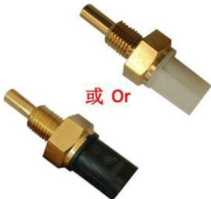
水油共用传感器位于发动机中缸位置，拔出插头后检测传感器两针脚电阻。需将副水箱拆下才能拆卸水油共用传感器。先捏住插头顶部，将防脱卡片按下后再往外拔下插头。
