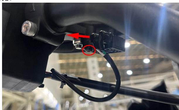
d. 用 10#套筒或梅花扳手拆下螺柱，即可更换离合手柄。
