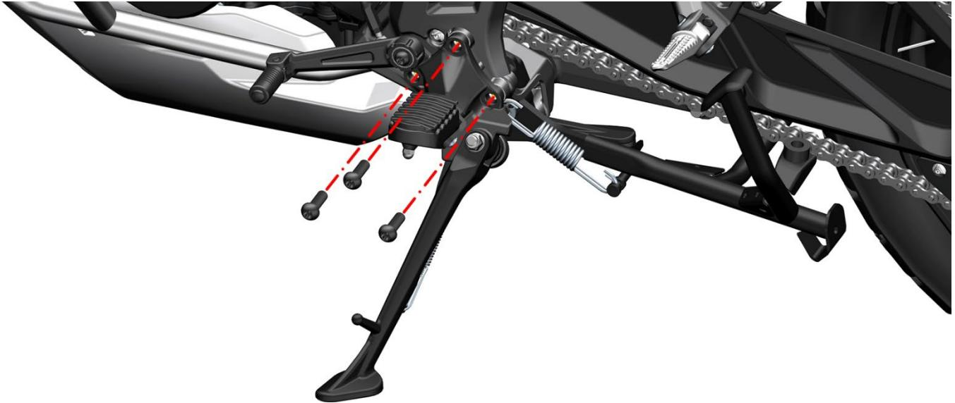
b. 用 8#套筒拆下螺栓，取下弹垫和平垫。
