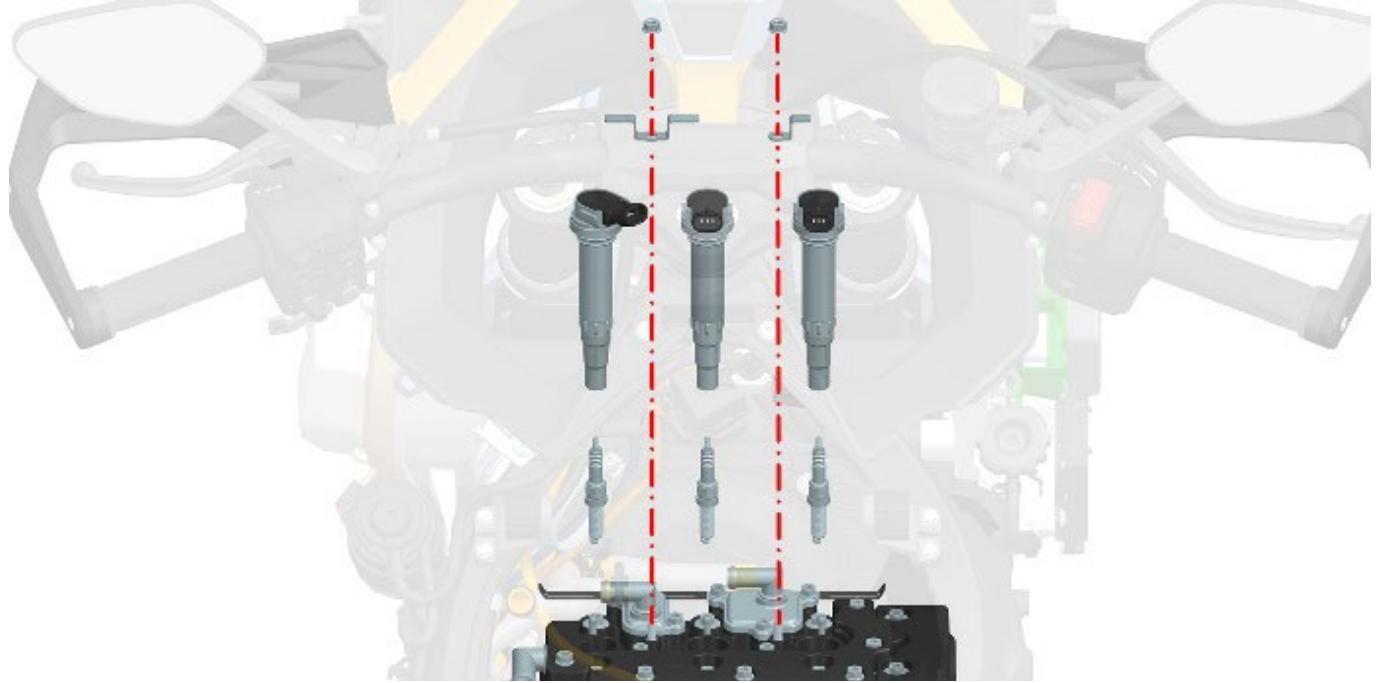
装回点火线圈时，先将点火线圈插回底部，并将点火线圈插头朝向旋至上图所示位置，随后放回压板，将螺母装回打紧，扭力标准  $11.5 \pm 1\text{N.m}$ 。
