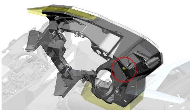
c. 从头部内衬上取下所有开关接头，拔下所有位置灯、摄像头的接头，取下头部内衬总成。
