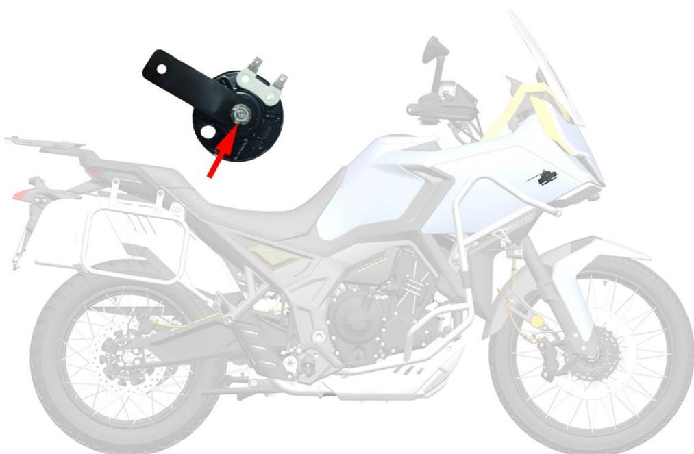
如需拆下喇叭，如已安装护杠的可从前泥板上方的护杠前安装支架处伸入 T25 梅花扳手将螺栓取下。将喇叭拉出拔掉插头后即可拆下。
