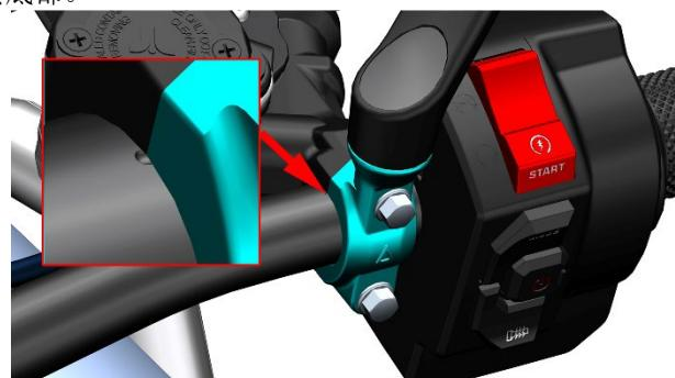
d. 将方向把上的长刻度对准垫块的上表面，将压块装回。
