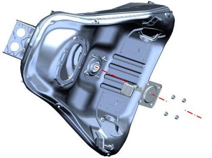
重新装配时需先对角预紧然后再拧紧 4 颗螺栓，否则油位传感器的密封胶圈压缩不均匀容易导致渗漏造成安全隐患。
