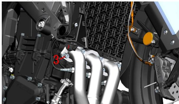
g. 使用带中孔的 T50 花型扳手和带中孔的 T45 花型扳手拆下固定在车架上的 2 处螺栓(7)、(8)。取下消声器。注意：拆下螺栓(7)、(8)时需托着消声器前部，完全拆下时需注意消声器连接发动机处的发动机排气口密封垫(4)不要遗漏。
