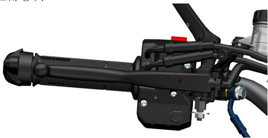
b. 用注射器吸取缝纫机油多次少量从油门线帽与线芯间的缝隙注入，边注入边转动油门。
