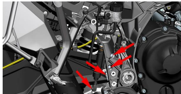
b. 用T25梅花扳手拆下后刹开关支架上的两颗螺栓，佩戴好防水手套后用12#套筒拆下碟刹油管螺栓，取下铜垫后移开RMC~HU油管，将主泵内的制动液倒出。碟刹油管螺栓标准扭力：32N·m(3.3 kgf·m, 24 lbf·ft)。
