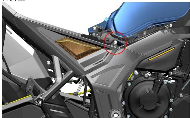
c. 拔下充电口座装饰盖，使用 T25 梅花内六角拆下 1 颗 M6×12 的螺栓(1), 1 颗 M6×14 轴肩螺栓(2), 2 颗 M6×16 的螺栓(3), 取下车架右侧盖，取下时注意磕碰发动机护板。
