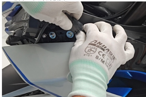
i. 使用 8#T 型套筒拆下 1 颗 M6×16 螺栓(1)，2 颗 M6×22 螺栓(2)，取下左大灯(3)。
