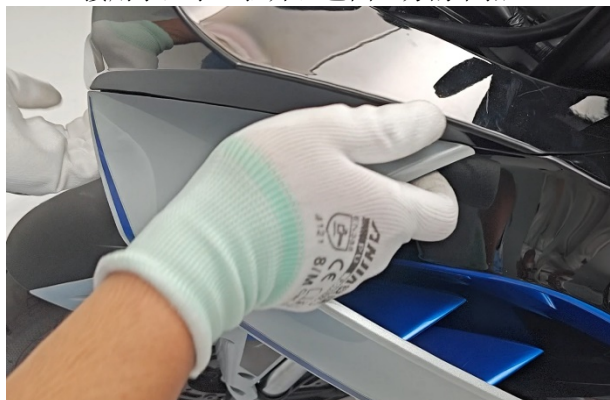
f. 使用钩针拆下前面板左部 2 颗膨胀钉。
