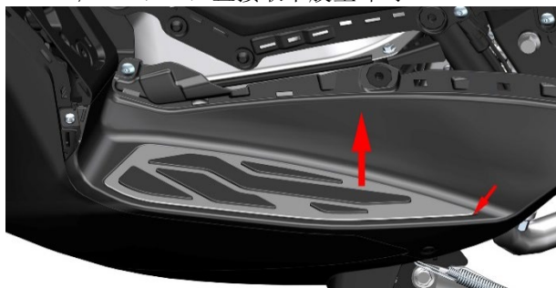
b. M310/350/150/368 使用 4#内六角，M368 (ETC) 使用 T25 梅花扳手拆下左踏板上的 7 处 M6×14 的轴肩螺栓。
