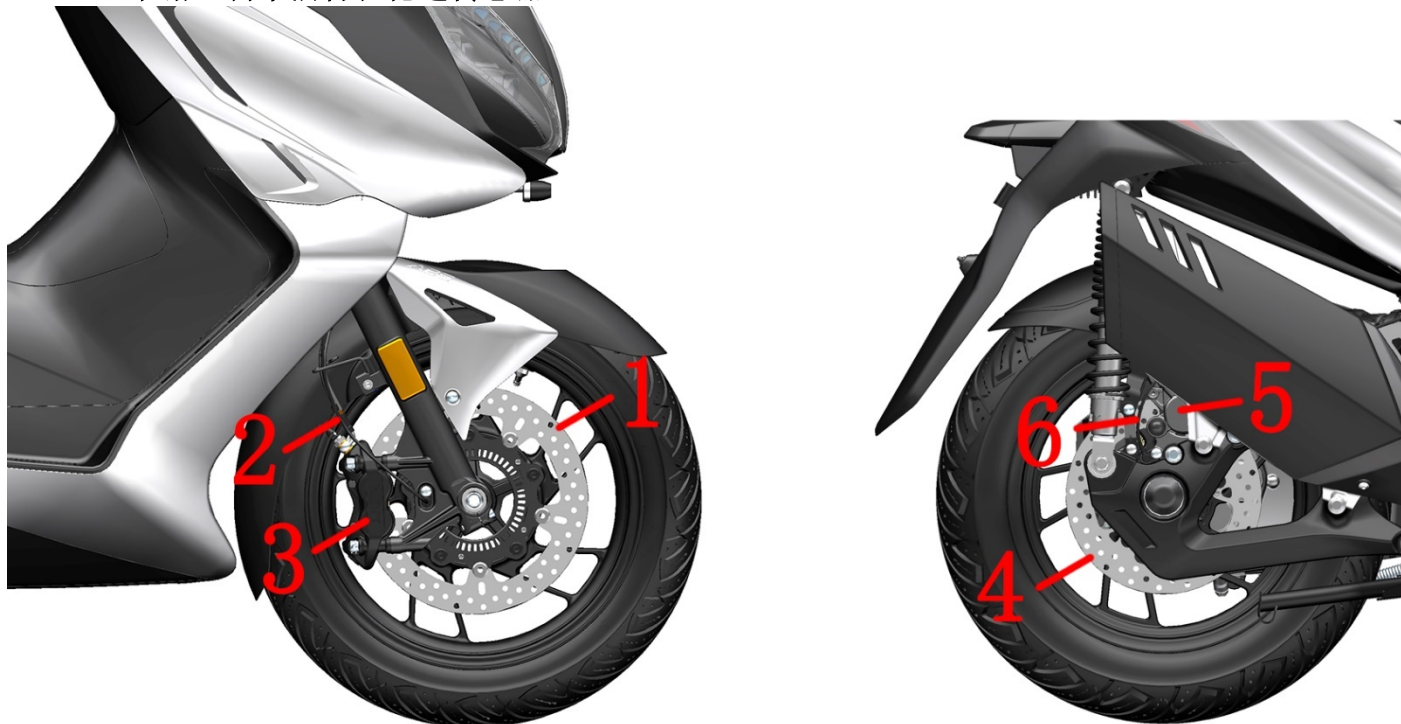
1-前制动盘组件 2-轮速传感器（前轮） 3-前碟刹卡钳 4-后制动盘组件 5-后碟刹卡钳 6-轮速传感器（后轮） 5、E368 制动系统配件分布图
