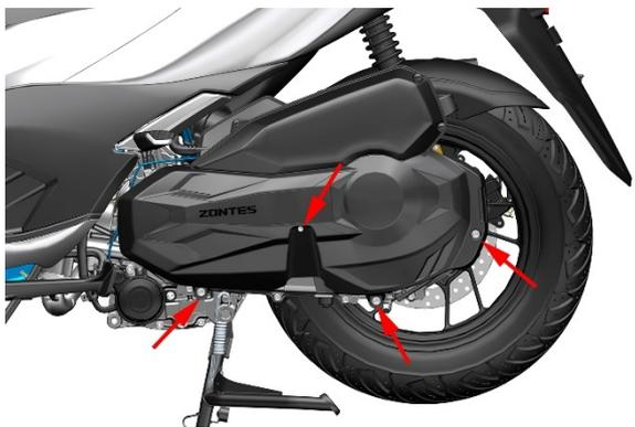
c. 拔出将空滤器装饰罩上的 2 处蘑菇扣，取下空滤器装饰罩。
