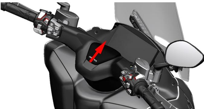
b. 使用十字批拆下方向把下罩处的 2 颗自攻钉(1)，使用一字批撬开①处和②处的卡扣。
