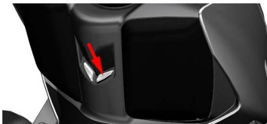
打开右储物盒盖，用 4#内六角将储物盒盖板处膨胀钉中心圆柱销按下，然后将膨胀钉取下。用指甲或薄的一字螺丝刀往箭头方向扣，然后取下右储物盒盖板(1)。
