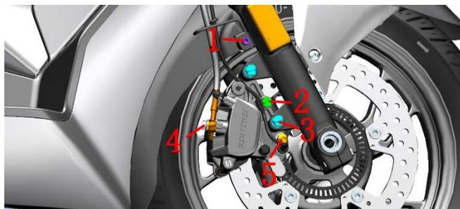
b. 戴上防水手套后，松开螺栓(4)。用 12# 套筒，将卡尺倒置，使螺栓(4)的头部朝下，将制动液排入接油盘。拆下螺栓(4)和铜垫(6)，拆下 FC-HU 油管。参考制动液步骤拆下前盘式制动主泵上盖，加快制动液排出。
