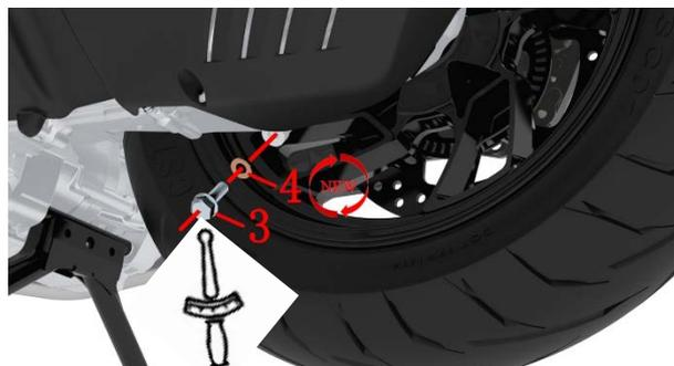
c. 将 M8×25 放油螺栓(3)和 8.3×16×1.5 铜垫(4)取下。
