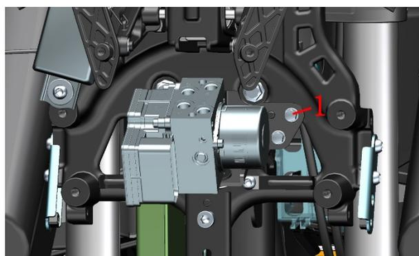
d. 抓牢液控单元后用 4#内六角拆下螺栓(2)，即可将液控单元(5)拆下。如需更换支架(4)，则需将翻边衬套(3)和缓冲胶(6)取下。
