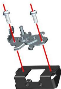
h. 使用十字螺丝刀拆下 3 颗 M4×25 螺栓后将电子储物盒锁拆下。
