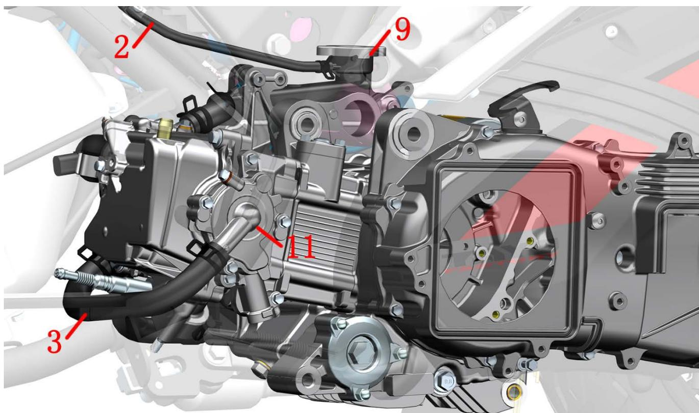
1-副水箱 2-副水箱连接管 3-发动机进水管 4-节温器出水管 5-节温器 6-水箱进水管 7-水油共用传感器 8-水箱出水管
