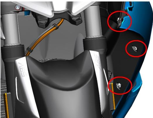
m. 用 4#内六角拆下包围底部的 1 处 M6×14 轴肩螺栓 (1)。用 4#内六角将左侧 2 处膨胀钉的中心圆柱销按下，然后将膨胀钉取下。关于膨胀钉拆装说明详见本章节的服务前须知。
