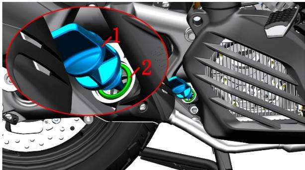
d. 放油螺栓底下放置接油盘后用 14# 套筒将 M12×1.5×15 放油螺栓(3)及 12×Φ20×2 组合密封(4)垫取下。用 24# 套筒拆下滤网盖(5)，取下橡胶(6)、过滤器弹簧(7)和帽式过滤器(8)。将曲轴箱内的油放干。
