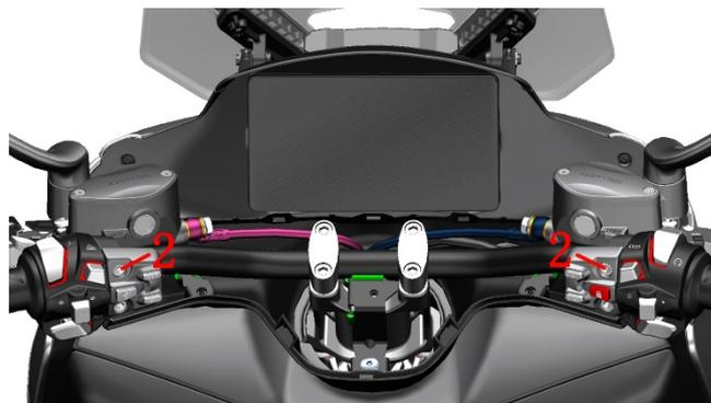
b. 使用 4#内六角拆下 1 颗非标 M6×14 轴肩的螺栓(3)；最后使用 6#内六角拆下 4 颗 M8×35 的螺栓(4)，取下 2 个压块，拿出方向把。
