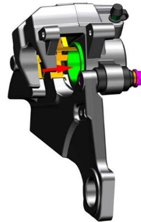
d. 左手抓住外侧制动片，右手插入销轴②，注意不要插到底。将内侧制动片装入到位后再将销轴插到底并使用5#内六角锁紧销轴②。注意切勿装反，有凹槽的一面朝向制动盘；黑色金属背板朝向卡钳。
