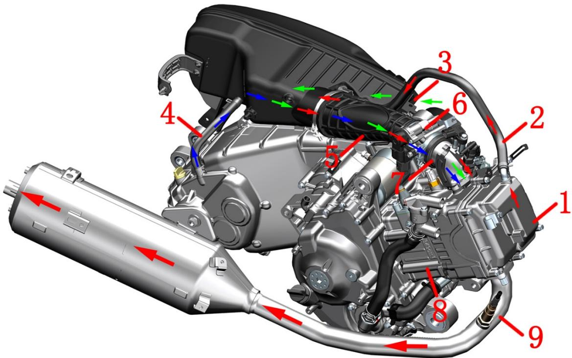
1-缸头 2-缸头废气管 3-空滤器进气口 4-齿轮箱废气管 5-空滤器出气管 6-节气门阀体组件 7-进气歧管 8-气缸
