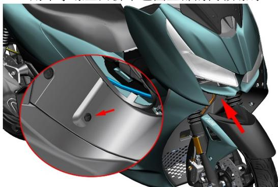
c. 使用 8#套筒拆下油箱盖板右部上的 1 颗 M6×22 的螺栓(1)，取下衬套(2)、缓冲胶(3)；用手抓住油箱盖板右部标记处(绿色矩形)按照箭头方向往斜上方拔，直至油箱盖板右部与油箱盖板中部、尾裙右部连接处(红色区域)的扣位分离。
