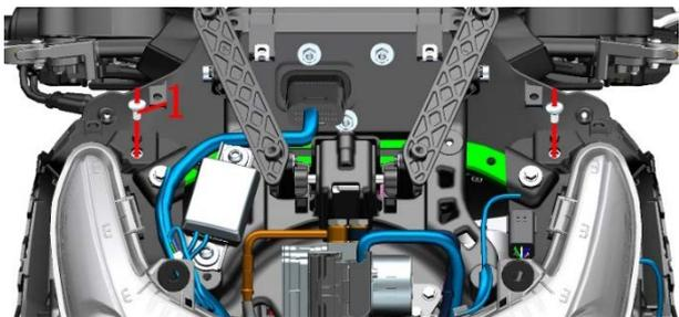
b. 使用 4#内六角拆下前大灯左处的 M6×14 轴肩的螺栓(1)。用 4#内六角拆下膨胀钉。用同样的方法将另一边的螺栓和膨胀钉拆下。
