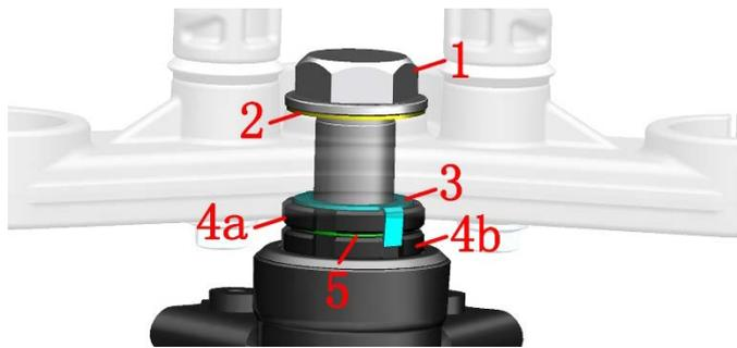
e. 前轮悬空将方向把摆正，用手轻推拉方向把感受转向机构是否顺畅无卡滞。将前叉组件稍偏向一侧时应能在自身重量下缓慢偏转到底，若快速到底则需重新调整。
