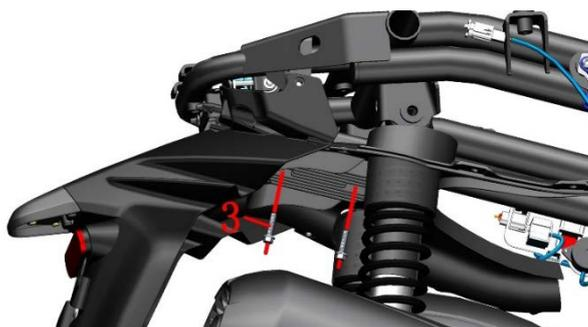
e. 整理好整流器的线束后抓住后内泥板按照箭头指示将后内泥板往下拉，直至车架与后内泥板之间的缝隙足够将整流器的2处接头依次穿过后内泥板上预留的孔，
