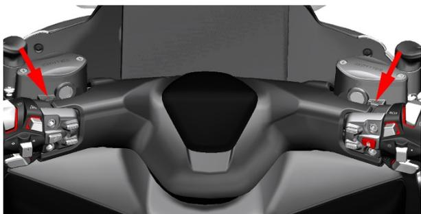
b. 将车辆停放在平地或升降平台上，放下主支架。检查主泵、ABS 液控单元和卡钳的油管接头处是否有制动液渗漏。可借助带 LED 的内窥镜便于检查 ABS 液控单元和主泵的油管接头，或者拆卸相应的覆盖件检查。
