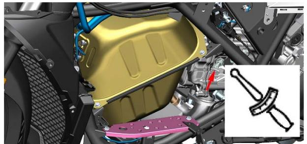
l. 建议用美纹纸或其它软质塑料袋等将火花塞安装孔封好，避免异物进入发动机内部。
