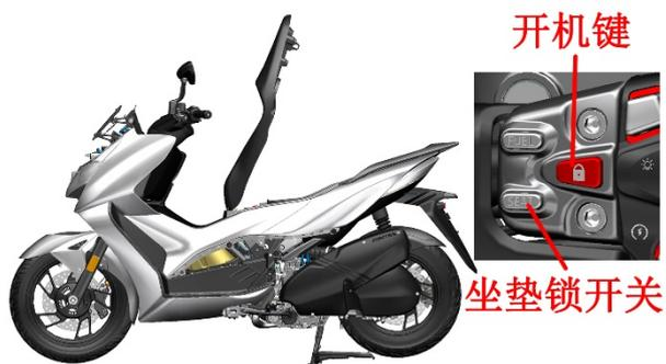
b. 一手扶住坐垫，一手使用 10#梅花扳手或 10#套筒拆下坐垫固定在坐垫支架上的 3 颗 M6 的螺母，双手抓住坐垫按照螺柱的角度往斜上方抽出坐垫。
