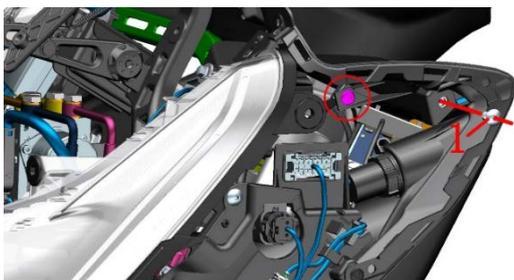
c. 一手抓住仪表面板按照大箭头方向轻微抬起，一手拔下连接仪表的仪表插头。
