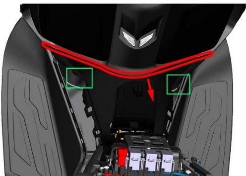
c. 从油箱左侧找到并拔下油箱锁接头，整理好油箱锁的线束。
