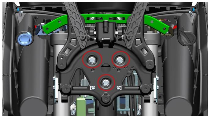
d. 用尖嘴钳拆下 2 件卡簧, 抓牢左挡风玻璃支架后将销轴和缓冲胶取下, 将摇臂弹簧取下。用同样的方法拆下右挡风玻璃和摇臂弹簧。
