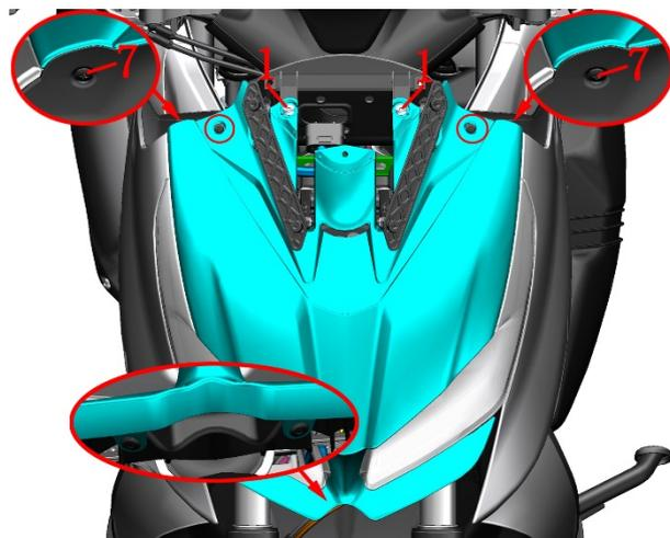
i. 用 4#内六角拆下前部左面板的 M6×14 轴肩螺栓(1)。用 4#内六角拆下前部左面板与前部左面板底衬连接的 M6×12 螺栓(8)。用 4#内六角将膨胀钉的中心圆柱销按下, 然后将膨胀钉取下。取下前部面板。(注意: D150 火花塞位置在右侧, D350 火花塞位置在左侧。)
