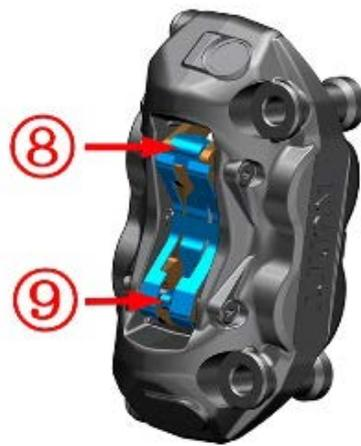
h. 用手将箭头⑧所指处的片体向箭头方向往里按住，将用销轴②插入孔位固定住制动片(1)。用 T25 内六角梅花扳手上紧销轴②。
