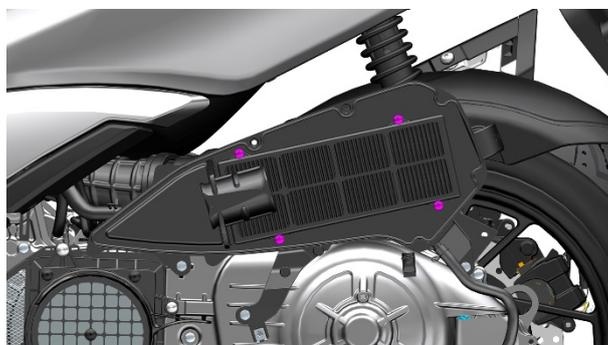
b. 将旧的空滤器滤芯取下。用吹尘枪将进气管内侧的灰尘吹干净后再用干净的无纺布将内壁擦拭干净。
