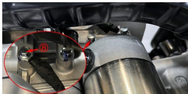
h. 使用 10#梅花扳手拆下启动电机上的 1 颗螺母，取出连接启动电机的正极线⑨。
