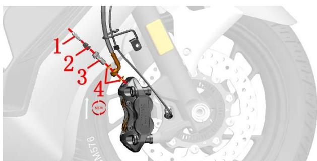
c. 参照拆制动片的步骤拆下制动片
