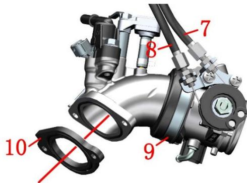
g. 用节气门阀体清洗剂分别对进气歧管和节气门阀体出气口的积碳进行清理。禁止用任何液体直接浸泡节气门阀体组件和进气歧管组件。
