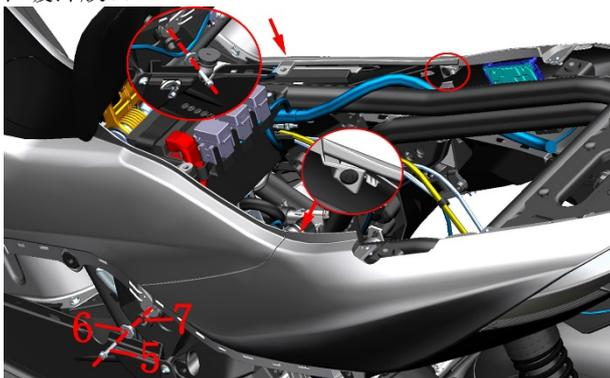
e. 使用 4#内六角拆下左尾裙与尾裙中部连接的 3 颗膨胀钉 (紫色)。
