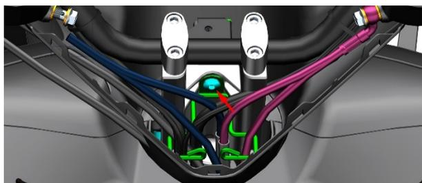
c. 使用棘轮扳手+加长杆+30#套筒拆下上联板盖形螺母(2), 取下方向把垫块。
