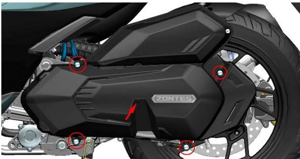
b. 逆时针旋转加油口螺帽(1)，取下螺帽(1)和 O 环(2)。加油口螺帽所用 O 环规格为：13.8×2.5。将螺帽(1)搭在加油口处不需取走，防止异物掉入发动机内部。
