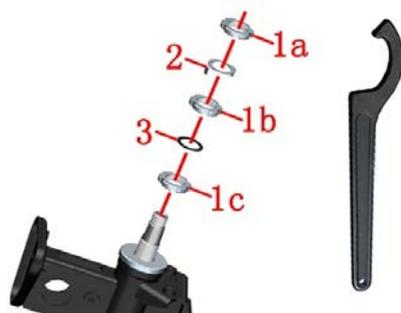
c. 如果转向较重，逆时针拧松调节螺母(1c)。然后顺时针旋转到 35N.m (3.6 kgf.m, 26 lbf.ft)，接着逆时针松开 1/4 转，最后拧到 13N.m (1.3 kgf.m, 10 lbf.ft)。
