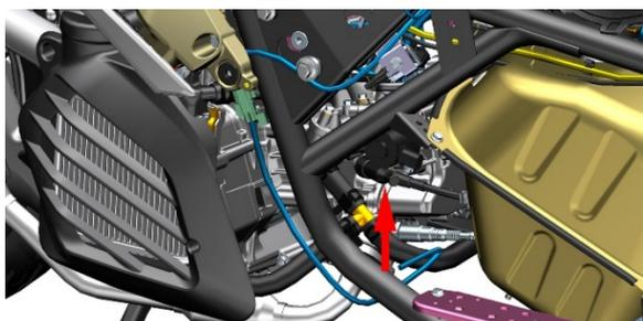
c. 参照《拆节气门阀体组件清理积碳》中的步骤拔掉节气门阀体上的传感器①、步进电机②的插头。📖
