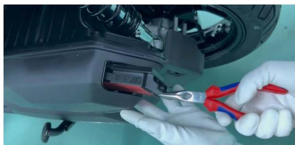
c. 在新的空滤器滤芯胶圈上个涂抹适量润滑脂，再按步骤装回去。
