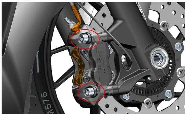
b. 前碟刹卡钳底下放置好接油盘。先揭开螺钉橡胶帽(1)，戴上防水手套后用 8# 梅花扳手拆下螺栓(2)，用 14# 梅花扳手拆下螺栓(3)，取下两个铜垫圈(4)。
