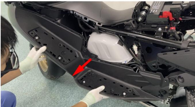
f. 使用同样的方法拆下包围右部及右踏板。
