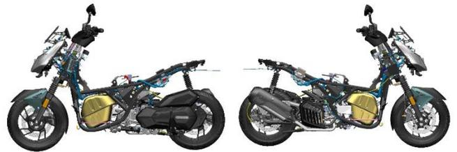
b. 检查图示的后摇架连接车架的 2 处螺母是否松动。检查发动机螺栓是否松动。
