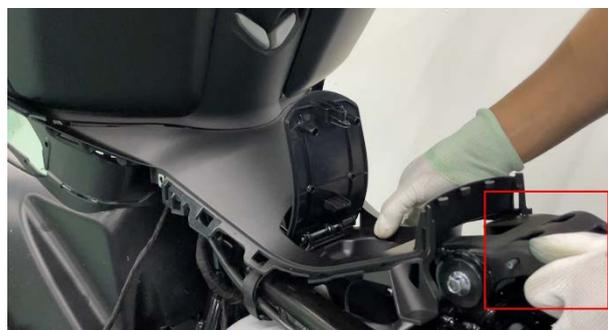
e. 按大箭头将固定油箱锁的卡扣往两侧掰开后取下油箱锁；按小箭头将油箱外盖及油箱支架的卡扣往中间按下后取下油箱外盖及油箱锁注意掰开卡扣时的力度避免掰断。
