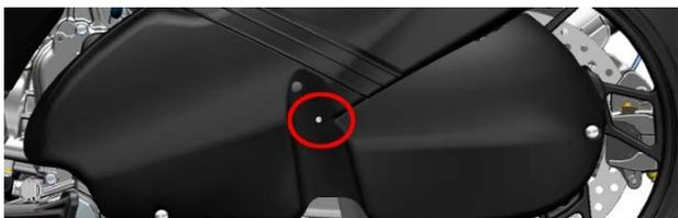
c. 用 4#内六角拆下图示的 3 颗 M6×14 轴肩螺栓。用 4#内六角将空滤器装饰罩的膨胀钉中心圆柱销按下，然后将膨胀钉取下。取下装饰罩。
