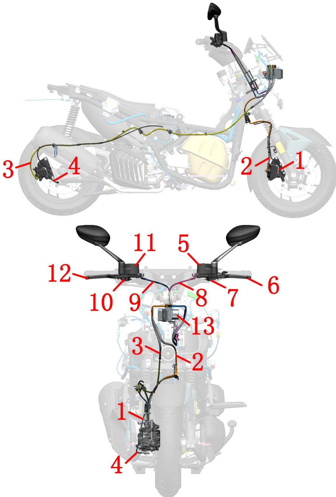
1-轮速传感器（前轮） 2-FC-HU 制动软管 3-RC-HU 制动软管 4-轮速传感器（后轮） 5-后碟刹主泵 6-后制动手柄 7-后
