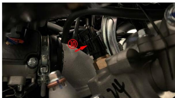
j. 在节气门阀体下部找到并拔下节气门阀体连接碳罐的管。
