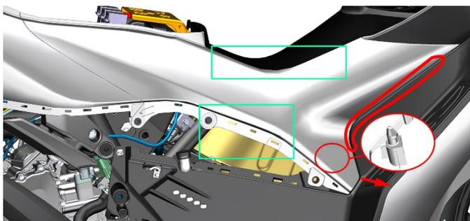
e. 使用同样的方法拆下油箱盖板左部。
