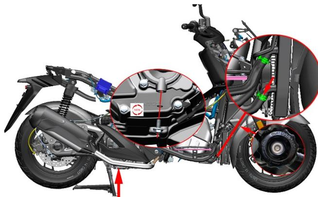
b. 拔下发动机头部的高压包插头。(D350 高压包位置在左侧，D150 高压包位置在右侧。)
