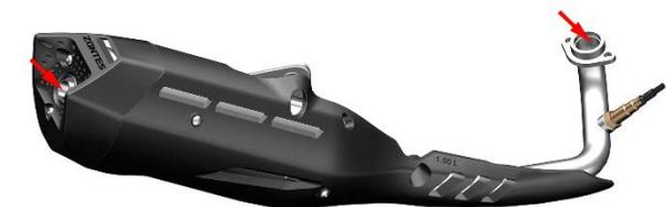
b. 如无漏气迹象则使用 6#内六角检查发动机排气口处的 M8 螺母是否有松动。
