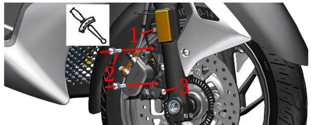
c. 使用 4#内六角拆下前泥板左右两侧的 2 颗 M6×14 轴肩螺栓(4)；再使用 5#内六角拆下 1 颗 M6×30 的螺栓(1)，取出弹垫(5)。
