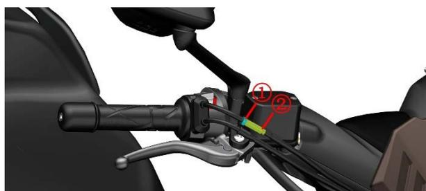
b. 若上述调整无法达到预期效果可参照“拆节气门阀体组件清理积碳”中的描述拆出节气门阀体组件。用 10# 开口扳手松开支架上的 2 颗螺母来调整。扭力：3.0 N.m (0.3 kgf.m, 2.2 lbf.ft)。
