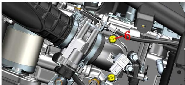
f. 将隔热垫和 O 环组件取下, 取下 O 环(10)。用 4#内六角松开卡箍(9)后将进气歧管与阀体组件分离。用 2 把 10#开口扳手将加油线(8)的两个螺母松开后往外拉出从支架中取下; 将油门线圆柱头从转盘上取出。回油线(7)的两个螺母松开后将底部的螺母完全松出螺纹套管后再往轴心方向拉出支架, 不能直接往外拉, 将回油线圆柱头从转盘上取出。
