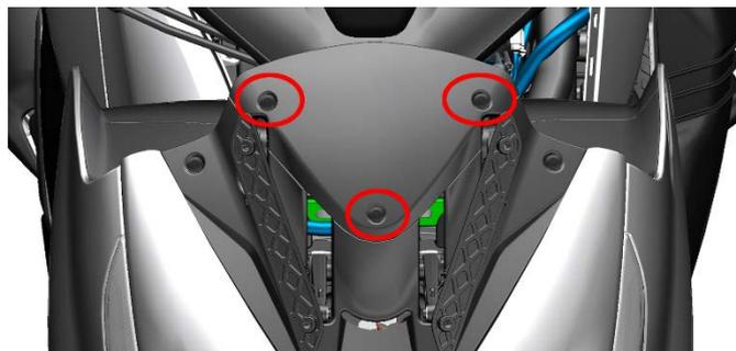
h. 用 4#内六角将 4 处膨胀钉中心圆柱销按下, 然后将膨胀钉取下。用十字劈拆下螺丝(7)。用 4#内六角拆下挡风玻璃的 2 处 M6×14 轴肩螺栓(1)。最后将图中蓝色部分一起取下来。
