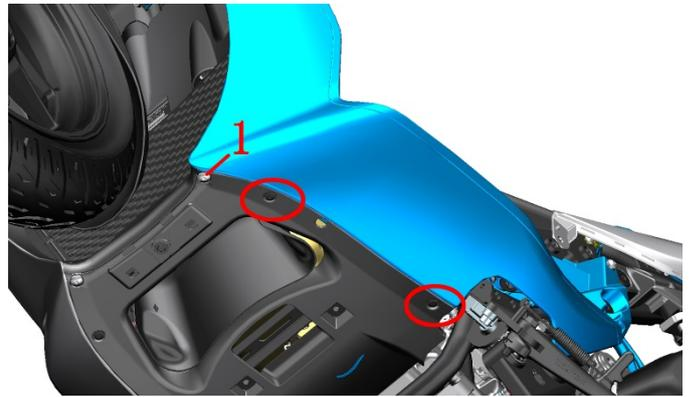
n. 用 4#内六角拆下蓝色部分的 3 处 M6×14 轴肩螺栓 (1)。然后将整个蓝色部分取下。
