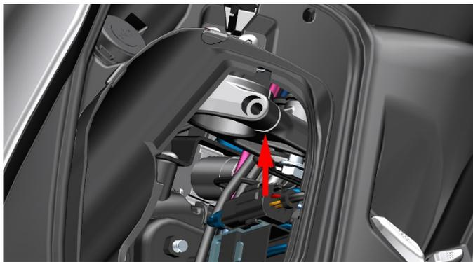
c. 将下联板 2 颗 M8×35 的螺栓(6)装上，使用同样的方法装入另一根减震。
