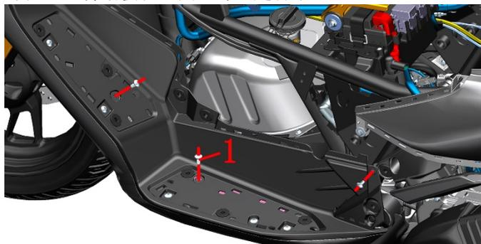
c. 使用 4#内六角拆下包围中部连接包围左部的 2 处 M6×14 轴肩的螺栓(1)。
