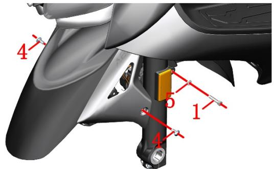
d. 先按照小箭头按住前泥板两侧，将前泥板箭头处的凸起往里按，再将前泥板往上移动至合适部位后按照大箭头方向抽出。
