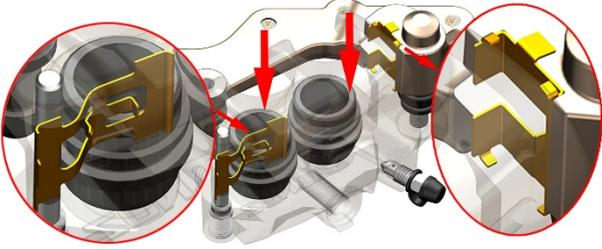
d. 取出新的刹车片，装回去。需要用手托住刹车片底部（通孔端）。注意不要反着装，有3个凹槽的一面正对着刹车盘；黑色金属后板面向着卡钳。
