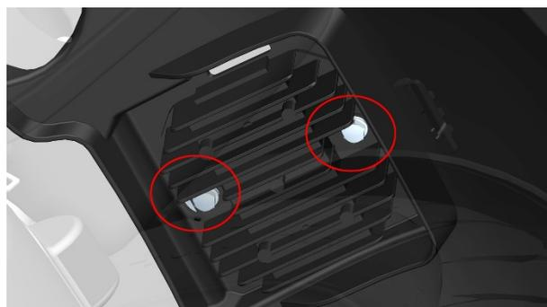
e. 将整流器往下拉，将线缆从后泥板前部的孔中拉出。将整流器从车上拆下。抽出线缆时注意不能强行拉扯以免损坏插头或拉脱导线。
