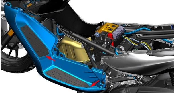
k. 使用 4#内六角拆下踏板处的 3 颗 M6×14 轴肩螺栓 (1)。
