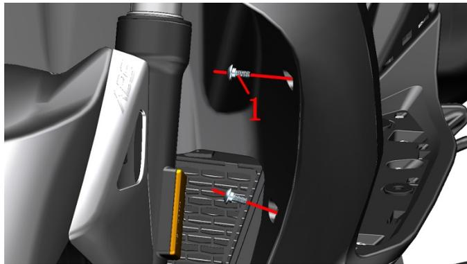
d. 使用 4#内六角拆下包围底板连接包围左部的 1 颗 M6×14 轴肩的螺栓(1); 再使用 4#内六角拆下包围底板连接包围左部的 2 颗膨胀钉(2)。
