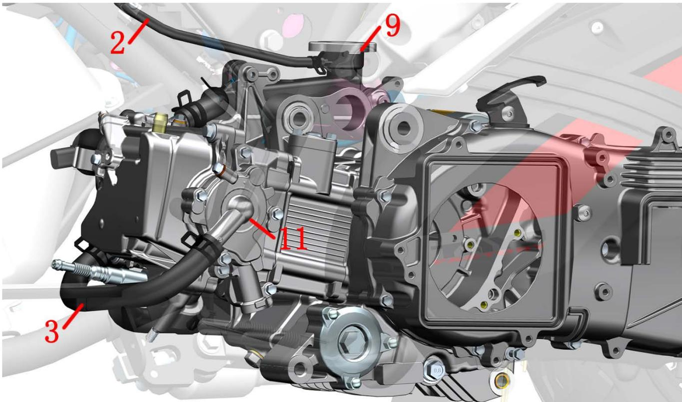
1-副水箱 2-副水箱连接管 3-发动机进水管 4-节温器出水管 5-节温器 6-水箱进水管 7-水油共用传感器 8-水箱出水管 9-水箱加水口 10-散热器组件 11-水泵盖组件
