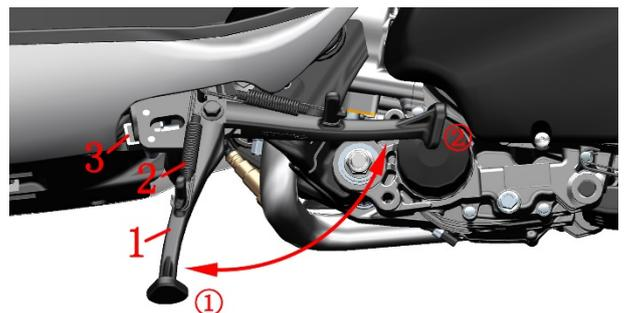
1. 侧支架 2. 侧支架弹簧 3. 侧支架熄火开关
