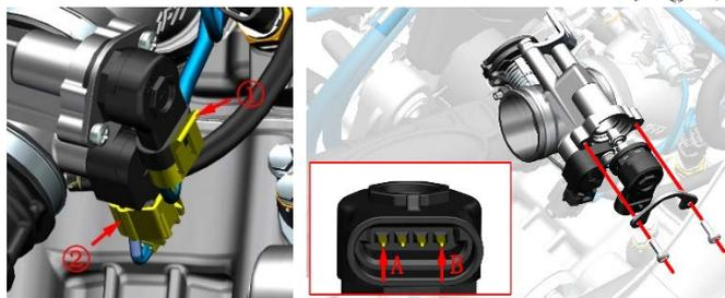
简易测试方法: 关电后将步进电机取出, 不要松开电缆插头, 在开机按下熄火开关, 不用打火, 查看电机堵头能否来回收缩, 最后将熄火开关关闭, 查看堵头是否回到原位。
