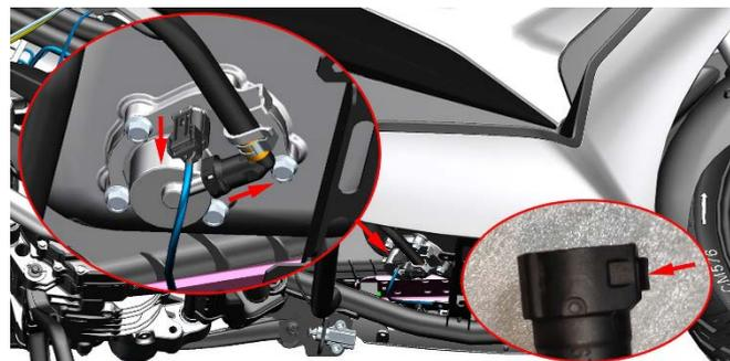
若需从车辆上拆下燃油泵，可用抽油泵将燃油箱内的燃油抽空。将车辆举升后按下图示的插头卡扣将线缆拔出。从底部用 10# 套筒拆下 5 颗螺栓，取下高压油管支架后即可拆下燃油泵。
