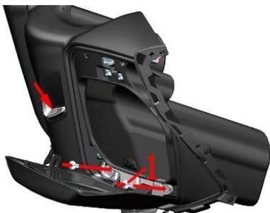
b. 用尖嘴钳取下卡簧后将旋转轴抽出。将扭簧和阻尼尼取下。安装时注意扭簧的位置。
