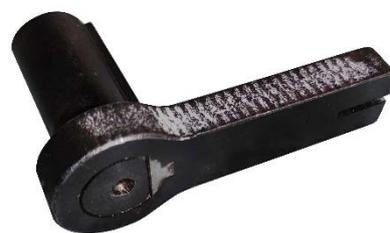
将转子从发动机上拆下，将飞轮检具按图 1 所示装好，检查转子侧面的标记线是否在开槽内（如图 2）。
