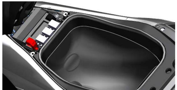
c. 将置物箱前部的 2 颗 M6×16 的螺栓(1)使用 4#内六角拧紧，注意螺栓需带衬套(2)、缓冲胶(3)；再将油箱中部盖板处与置物箱相连处（绿色标识处）使用 2 颗膨胀钉固定；将置物箱后部的 2 颗 M6×16 的螺栓(1)使用 4#内六角拧紧，注意螺栓不带衬套(2)、缓冲胶(3)，最后扣上装饰胶。
