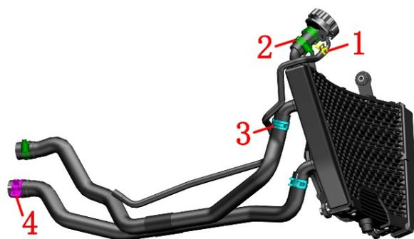
1-水管抱箍 (φ9) 2-水管卡箍 (φ26) \*3 3-水管抱箍 (φ24) \*2 4-水管抱箍 (φ26)
