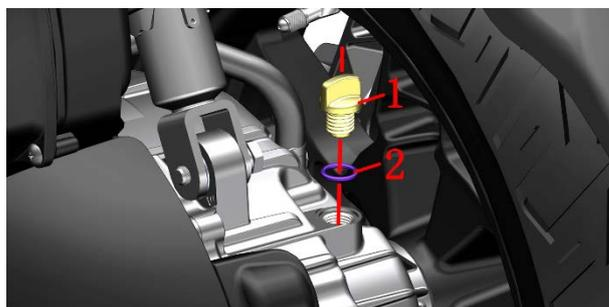
b. 在左侧发动机后部底下放置接油盘。用 14#套筒将放油螺栓(3)逆时针拧松。
