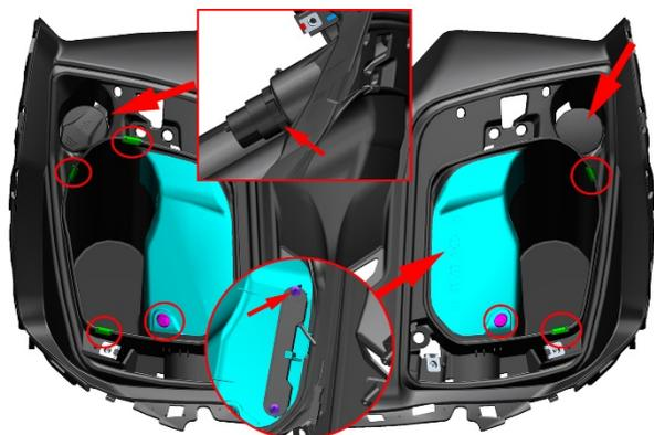
g. 使用 5#内六角拆下 2 颗 M6×16 螺栓后将右储物盒锁支架和右储物盒锁分离。
