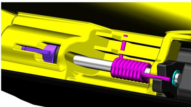
c. 用 4#内六角拆下 3 颗 M6×14 的轴肩螺栓，将内外盖分离。从外盖上取下 3 件夹板螺母。
