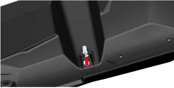
b. 将螺栓对好安装孔后打紧。再用 4#内六角将另外 4 颗 M6×14 轴肩螺栓装回，塞回胶塞。
