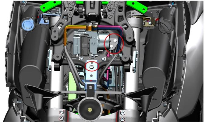
c. 抓牢风挡基座组件后用 12# 套筒拆下 3 颗 M8×25 螺栓, 将风挡基座组件从车辆上取下。
