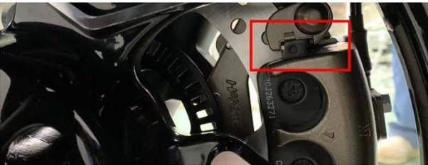
f. 确认刹车片上部组装到位后，插入销轴②，用5#内六角锁紧。
