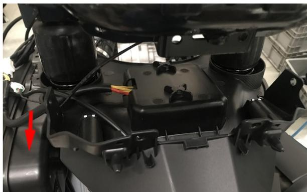
f. 一人抬着车架尾部或两侧按照大箭头方向往上抬，直至车架与后减震之间的缝隙足够后内泥板取出，一人抓住后内泥板两侧或中部按照小箭头方向先往上穿过后减震再取出；（注意：取出后内泥板时需后减震会往前倒，为防止划伤漆面或损坏零件，应一手取后内泥板，一手扶住后减震。）取出后内泥板后将后减震对准车架上的安装点，将车架缓缓放下，直至后减震上部套入车架上的安装点。
