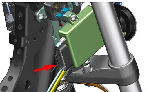
d. 将 RC-HU 软管和轮速传感器线从后内泥板中拔出。
