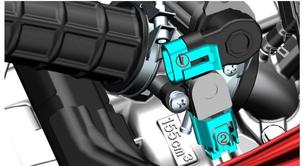
简易测试方法：关电后将步进电机取出，不要松开电缆插头，在开机按下熄火开关，不用打火，查看电机堵头能否来回收缩，最后将熄火开关关闭，查看堵头是否回到原位。
