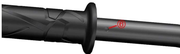
c. 安装副手把开关时需将副手把开关与碟刹主泵的结合面对齐手把开关上的三角标志，再使用 5#内六角拧紧 4 颗 M6×30 的螺栓 (2)。
