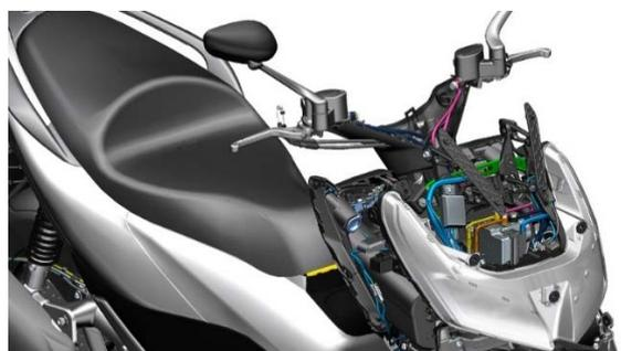
b. 先将扎带解开，再将方向把线夹内的手把开关线束和制动软管从方向把线夹缺口处一一取出，直至取完方向把线夹内所有线束。
