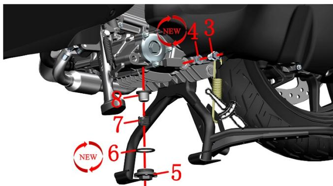
e. 检查过滤网(8)是否损坏，如损坏需更换，如无损坏应清理干净。
