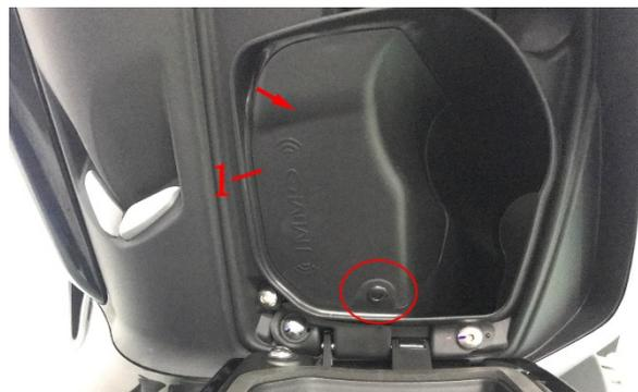
拔掉 PKE 保险，掀开胶塞插入原厂标配的充电器 DC 插头。再将 AC 座插入 110-220V 电源。充满后需插回保险。如使用劣质充电器导致电池损坏的不在三包范围。
