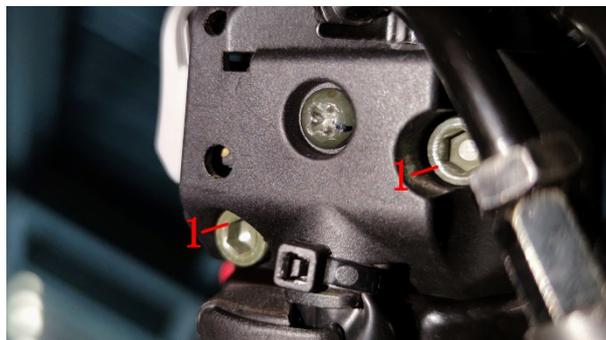
b. 用注射器吸取缝纫机油多次少量从油门线帽与线芯间的缝隙注入，边注入边转动油门。
