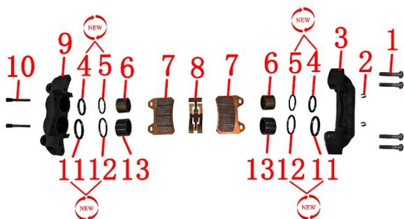
1-螺栓 2-卡簧 3-卡钳内侧壳体 4- $\phi 30$  油封 5- $\phi 30$  防尘封 6- $\phi 30$  活塞 7-制动片 8-制动片弹簧片 9-卡钳外侧壳体 10-销轴 11- $\phi 34$  油封 12- $\phi 34$  防尘封 13- $\phi 34$  活塞
