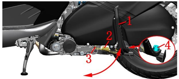
1. 主支架 2. 主支架弹簧 3. 主支架复位弹簧柱 4. 缓冲胶
