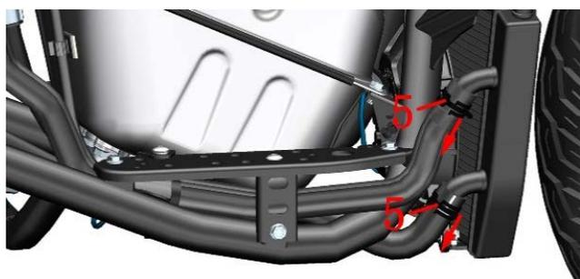
f. 放完冷却液后将覆盖件先行拆到图示。将左侧下方的主水箱散热风扇插头按箭头方向往拉出，按下防脱卡扣后将插头拔出。
