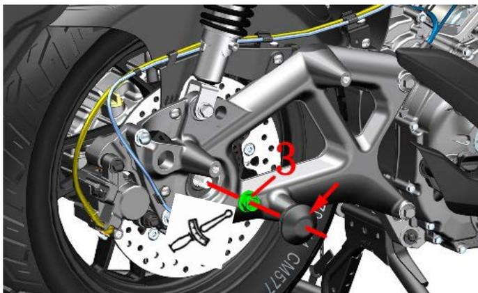
c. 用 4# 内六角拆下后内泥板右侧中部的 M6×14 轴肩螺栓(5)，用 4# 内六角拆下前部的 M6×12 螺栓(4)和后部的螺栓(5)。拆下后摇臂底部的 2 颗螺栓(4)，将轮速传感器(6)移开。将箭头指示的 3 处卡钉拔出后取下发动机右盖装饰罩(7)。
