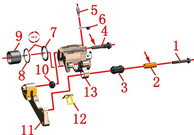
1-卡钳安装板销轴 2-衬套 3-胶帽 4-卡钳销轴 5-放气嘴 6-放气嘴胶帽 7-油封 8-防尘封 9-活塞 10-卡钳销轴胶帽 11-卡钳安装板 12-制动片弹簧 13-卡钳壳体
