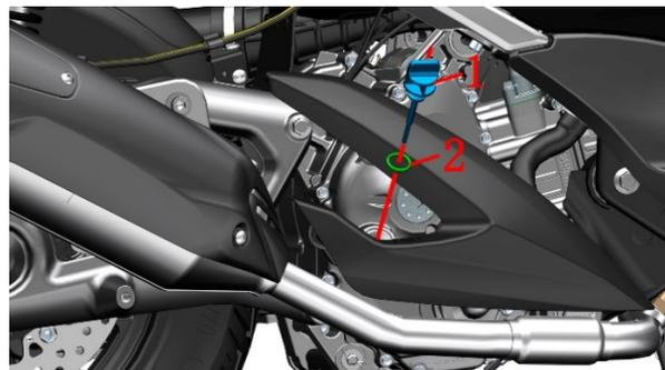
e. 擦拭干净机油尺, 用手顺时针旋转将机油尺(1)和 O 环(2)装回发动机右曲轴箱盖。
