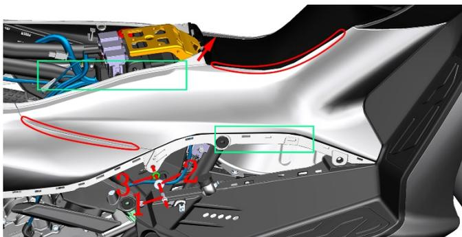
d. 用手抓住油箱盖板右部装饰罩的标记处(绿色矩形)按照箭头方向往外拔，直至将油箱盖板上的蘑菇扣(红色圆圈)拔出，取下油箱盖板右部。
