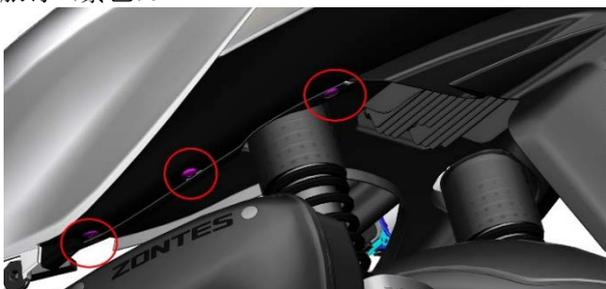
f. 使用 4#内六角拆下右围裙与尾群中部连接的 3 颗膨胀钉 (紫色)。
