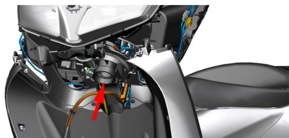
b. 依次在下联板上方放入涂抹好润滑脂的轴承(9)、轴圈(8)、防尘盖(7), 再拧入 1 颗方向柱调节螺母(5), 使用四爪套筒将方向柱调节螺母(5)拧紧, 扭力: 50N.m (5.1 kgf.m, 37 lbf.ft), 确保上联板不上下串动后将方向柱调节螺母(5)逆时针松 1/4 圈, 最后使用扭力扳手拧紧。扭力: 15N.m (1.2 kgf.m, 11 lbf.ft)。在方向柱调节螺母上放入橡胶胶垫(6); 再拧入第二颗方向柱调节螺母(5), 将第二颗方向柱调节螺母(5)拧到与第一颗方向柱调节螺母(5)的缺口对齐, 最后放入卡式垫圈(4)。
