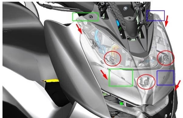
d. 用 4#内六角拆下前部盖板上的 4 颗 M6×14 轴肩螺栓(1)。将前部面板和前部盖板分离。
