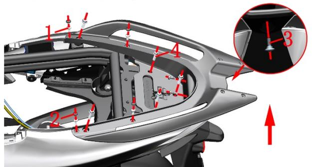
b. 将后右脚踏放下，使用 4#内六角拆下右侧盖连接后右脚踏支架的 1 颗 M6×14 轴肩的螺栓(3)和 1 颗膨胀钉；用手抓住左侧盖标记处（绿色矩形），按照小箭头的方向由外朝内的顺序上下交替的往外拔，直至左侧盖上的 5 处蘑菇扣（红色圆圈）全部拔出，取下左侧盖。
