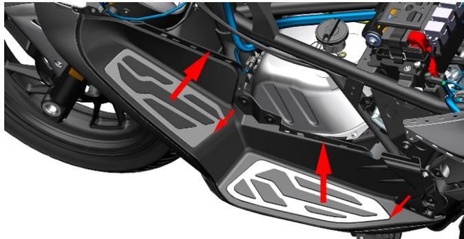
b. 使用 4#内六角拆下左踏板上的 3 处 M6×14 轴肩的螺栓(1)。将踏板和包围左部一起拆下。
