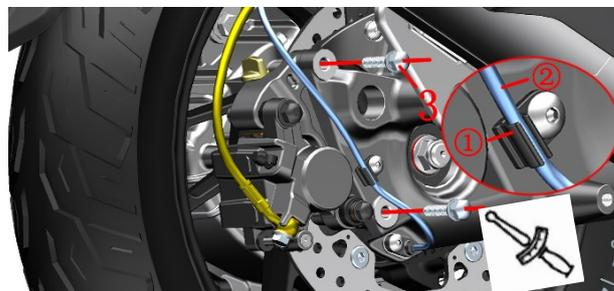
g. 将后卡钳组件拉出,检查制动片磨损情况。如将近磨损或已磨损到极限位置则需成对更换新的制动片。
