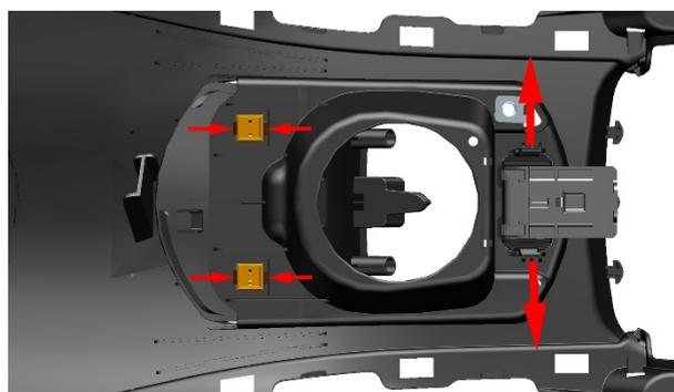
f. 用尖嘴钳取下卡簧后将旋转轴抽出。将扭簧和阻尼取下。安装时注意扭簧的位置。
