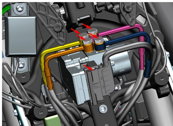
c. 拆下前面装回去的 2 颗螺栓(1)将液控单元和支架组件从车上拆下。
