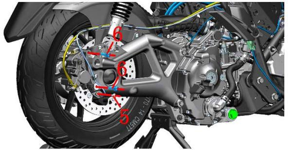
d. 一人使用 21# 套筒从精滤器前方伸入固定车辆左侧固定发动机的 1 颗螺母(2)，另一人使用 24# 套筒装回车辆右侧固定发动机的 1 颗螺栓(1)
