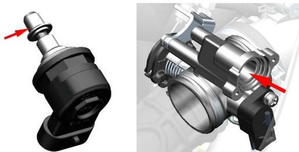
g. 将步进电机装回阀体上，注意不能漏装密封圈。将插头插回。
