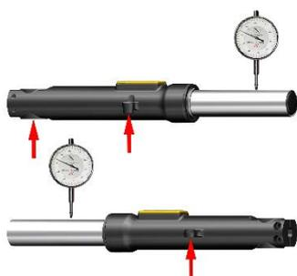
变形量 $<0.2\text{mm}$  ( $0.008\text{ in}$ ) 的轻微变形可用 V 形铁块将前叉管支撑好并在接触面放置软胶或橡胶、铜片等防止前叉管划伤，使用压力机缓慢小压力小行程分多次校直，边校直边测量，矫正后径向跳动应 $<0.05\text{mm}$  ( $0.002\text{ in}$ )。若矫正后原弯曲变形部位失圆则应更换。过大的变形则应更换减震。
