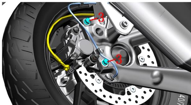
c. 参照更换制动片步骤将制动片先拆下。
