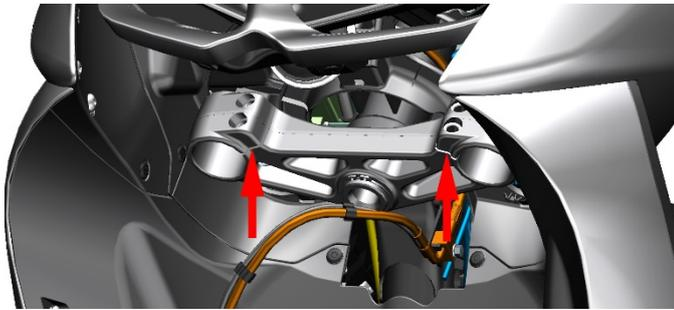
b. 使用一字批撬开上联板上的一处缝隙，套入对应减震，将减震装到位后取下一字批。拧入 M8×35 的螺栓(6)，使用 6#内六角拧紧。扭力：25N.m(2.6 kgf.m, 18 lbf.ft)。
