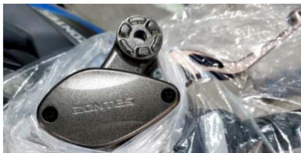
d. 佩戴好防水手套后用十字螺丝刀拆下螺栓①，取下上盖②、盖板③、密封胶垫④。
