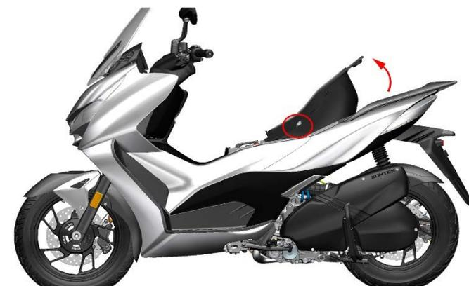
d. 用 4#内六角拧松管夹自带的 2 个螺栓。
