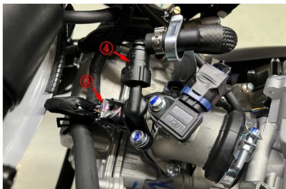
e. 在车架右侧的水箱前找到并拔下曲轴位置传感器插头⑤、磁电机定子充电线⑥的插头和水温传感器⑦的插头。
