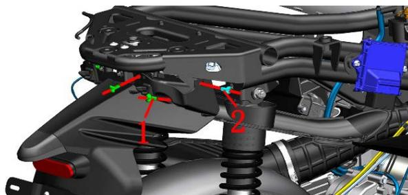
b. 从车架左侧的胶套中找到并拔出后牌照灯、左转向灯、整流器的接头。
