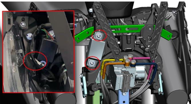
b. 用 8# 套筒拆下液控单元支架上的两颗 M6×16 螺栓, 将液控单元移开。用 6# 内六角拆下喇叭支架上的 M8×30 的螺栓, 将喇叭移开。
