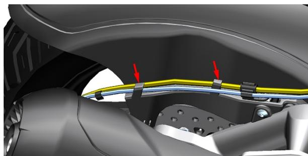
e. 将轮速传感器从线夹(4)中拔出，用 4# 内六角拆下螺栓(5)后将轮速传感器(1)从车上拆下。如需拆下线夹(4)可用 4# 内六角拆下固定线夹的螺栓(5)即可取下。
