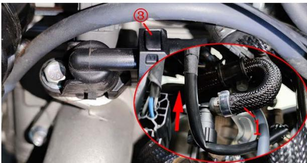
c. 在阀体底部找到卡簧(2)用手捏住卡簧两端往外移出, 然后拔下脱附管(3)。
