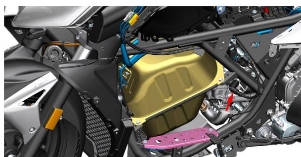
c. 参照《拆节气门阀体组件清理积碳》中的步骤拔掉节气门阀体上的步进电机①、传感器②的插头。
