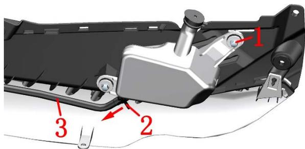
b. 将 2 根水管从水管夹中拔出，水管夹为塑料材质需注意力度。
