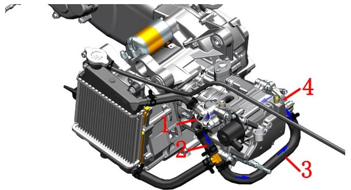
1-节温器 2-节温器出水管 3-发动机进水管 4-水泵盖
