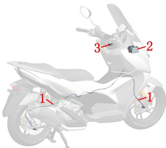
1-前、后轮轮速传感器 2-ABS 液控单元 3-OBD 诊断接口
