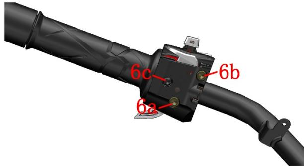
e. 使用 5#内六角逆时针拧松右侧平衡块自带的 M6×80 的螺栓 5 圈，注意不能拧过多圈数否则平衡块自带的螺母会掉到方向把内部增加拆平衡块的难度。将 5#内六角套到螺栓头部后再用胶锤将 M6×80 螺栓往里敲击，让平衡块的缓冲胶和螺母松动便于取下平衡组件。抓牢平衡块后上下左右晃动的同时往外拔出。使用同样的方法拔出左侧平衡块，用热水浸泡大约 10 分钟后再用吹尘枪按箭头指示吹入左手把胶套与方向把管间，再将方向把和左手把胶套往相反方向拔，取出左手把胶套。
