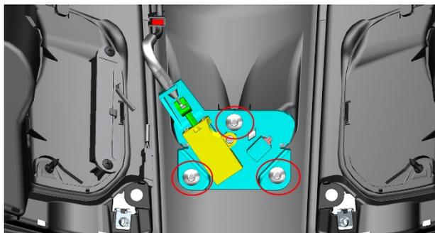
f. 使用 4#内六角拆下 2 颗膨胀钉, 取下储物盒左右盖板。用十字螺丝刀将前左储物盒盖板上的两颗十字自攻钉拆下, 取下无电感应天线。扣下五颗前左储物盒后胶。松开箭头所指的塑料螺帽, 取出 USB 充电线, 将对位的充电口胶套取下。
