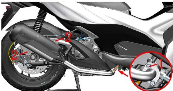
b. 先取下箭头所指的防尘盖。一人捏住后制动手柄，一人使用 21# 套筒+冲击扳手将后轮螺母(3)拆下。螺母(3)的标准扭力： $125\text{N}\cdot\text{m}$  (12.8 kgf.m, 92 lbf.ft)。
