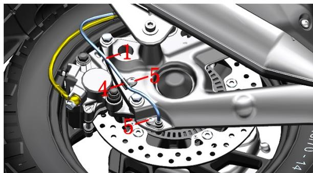
f. 检查取下的软管表面是否有老化龟裂、破损、磨损等不良现象。用无纺布擦拭干净残留的制动液后用保鲜膜或塑料袋将软管两端面包好，防止异物进入。检查轮速传感器线的线缆外皮是否有破损，若有磨破外皮可用电工胶布粘好防止短路。
