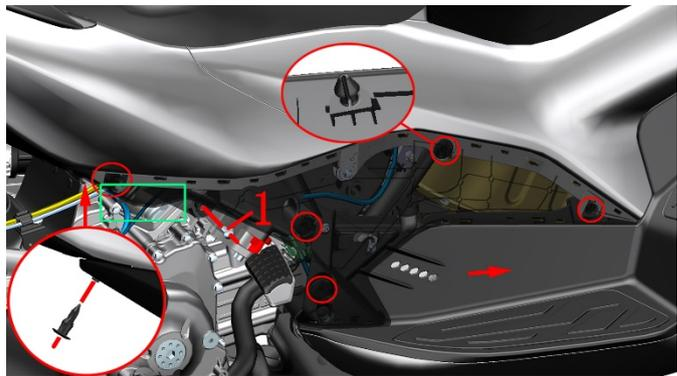
b. 掀开副水箱胶盖,借助漏斗往里添加适量的冷却液。将车辆扶正借手电筒观察副水箱液面是否在“H”和“L”之间。注意地面尽量平整水平,不要在斜坡上检查。并且发动机需处于冷机状态。
