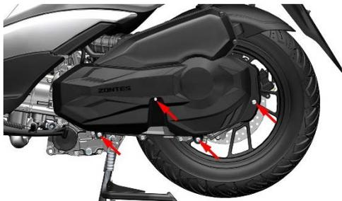
c. 拔出将空滤器装饰罩上的 2 处蘑菇扣，取下空滤器装饰罩。
