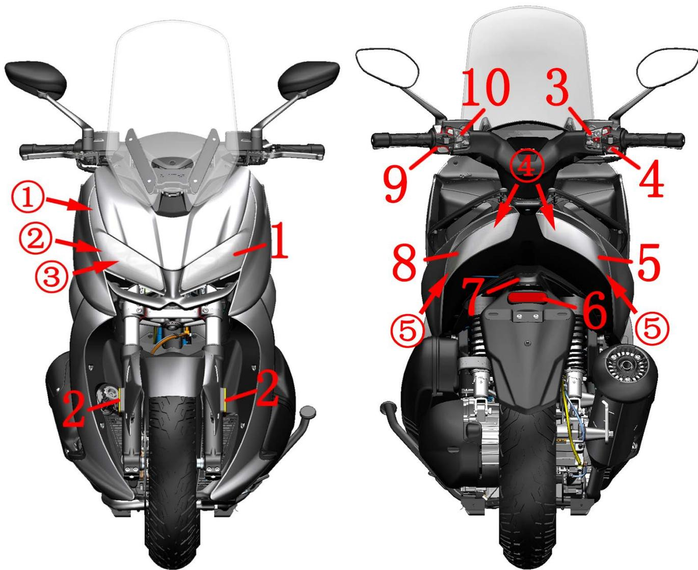
1-大灯 (①-前转向灯位置 ②-位置灯/日行灯位置 ③-远近光灯位置) 2-侧反射器 3-右手把副开关 4-右手把开关 5-右后转向灯 (④-位置灯/制动灯位置 ⑤-后转向灯位置) 6-后反射器 7-牌照灯 8-左后转向灯 (④-制动灯/位置灯位置 ⑤-后转向灯位置) 9-左手把开关 10-左手把副开关
