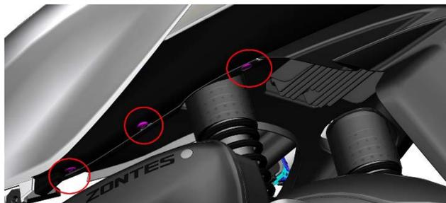
b. 使用 4#内六角拆下右围裙与尾群中部连接的 3 颗膨胀钉（紫色）。
