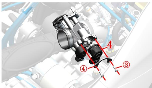
f. 使用节气门清洗剂清理步进电机头部的积碳。往阀体孔内喷入少量清洗剂。禁止用任何液体浸泡步进电机。
