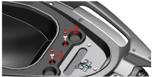
e. 将置物箱微微抬起，直到置物箱左侧露出氛围灯接头，拔下接头后将整个置物箱取出。
