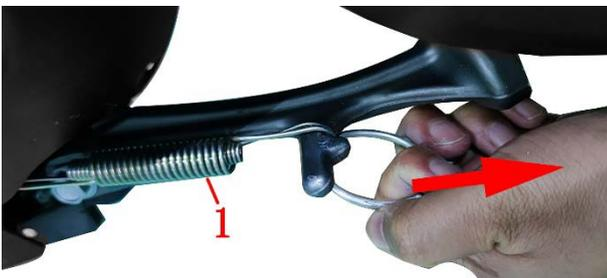
c. 一手抓住侧支架，一手往箭头方向拉，将弹簧取下。
