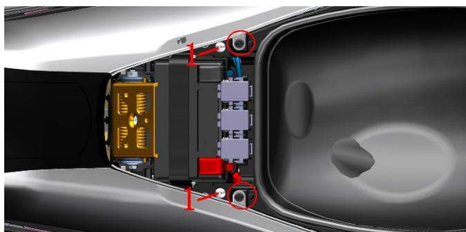
b. 取下 2 颗螺栓装饰扣(2)，再使用 4#内六角拆下 2 颗 M6×16 的螺栓(1)。
