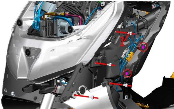
c. 将固定在左面板内衬上的插头解开，整理至一边。取下左面板底衬。
