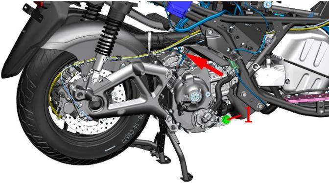
b. 一人扶住整车并将车架后部稍微抬起，一人将 2 根后减震转动至车架安装凹槽处，再将右侧减震转动至与车架安装孔位对齐，从左侧穿过 1 颗 M10×1.5×66 的螺栓(3)，右侧使用 1 颗 M10 螺母(4)锁紧，扭力：30N.m (3.1 kgf.m, 22 lbf.ft)。安装左侧减震时需将车架稍微左右晃动，直至减震安装孔与车架安装点对齐，再使用同样的方法固定左侧减震。
