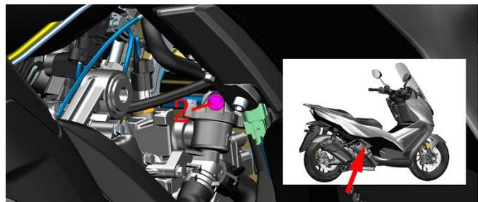
c. 佩戴好防水手套借助加长漏斗往主水箱加水口添
