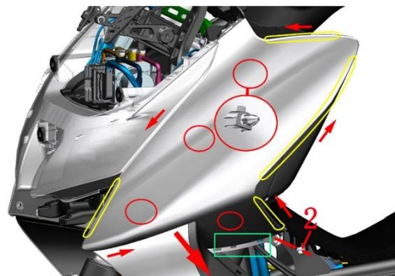
c. 使用相同的方法拆下前右面板。
