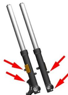
c. 若前叉管上附着大量液压油，则先擦拭干净后骑行观察。若无油迹或轻微油迹则为防尘封处装配时积存的液压油，可判断为油封未漏油。若附着少量油渍或油泥混合物则拆下防尘封后擦拭干净前叉管和油封表面，先压缩一次前减震再擦拭干净再压；重复 10 次上述操作。观察前叉管上是否仍然有，若有则前减震漏油需更换防尘封和油封，若无则是装配时积存的少量液压油为正常现象。
