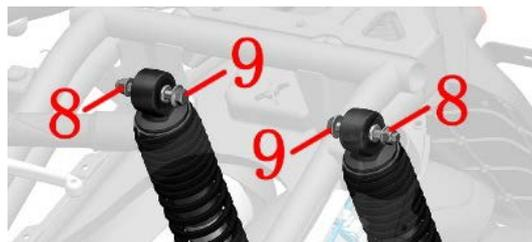
f. 抓住后右减震后用 16#套筒或棘轮扳手拆下螺栓(10)，再将螺栓(9)取下，更换后右减震。更换减震时换完一侧减震后再更换另一侧。左侧需用 16#棘轮扳手拆下螺栓(10)。螺栓(10)标准扭力：24N.m(2.4 kgf.m, 18 lbf.ft)。
