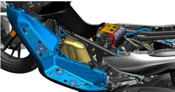
l. 使用 4#内六角拆下包围中部左侧的 3 处 M6×14 轴肩螺栓(1)。
