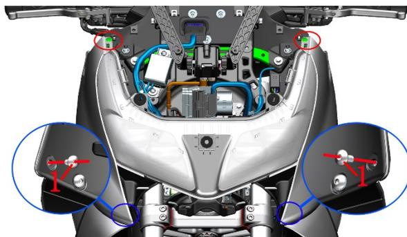
b. 使用 4#内六角拆下左部面板下部的 M6×14 轴肩螺栓(2)。两手抓住前部左面板标记处(绿色矩形)，按照大箭头方向小心往外拔，拔的时候需要按照小箭头的指向顺序依次将前部左面板与油箱中罩、前储物盒面板、仪表面板、前部左面板内衬上的连接处(红色区域的 4 处卡扣，黄色区域；油箱中罩 5 处，前储物盒面板 8 处，仪表面板 6 处)的扣位分离，取下前部左面板。
