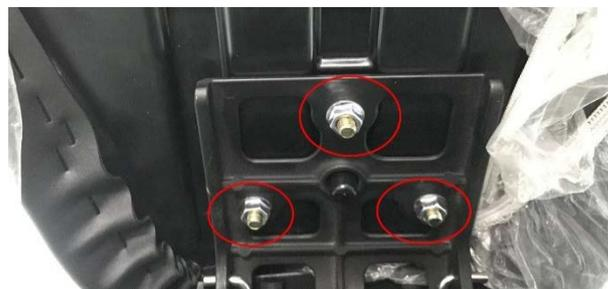
b. 将电池舱内的线缆理顺。先扣下 2 处螺栓装饰扣(3)。用 4#内六角拆下后置物箱的 4 处 M6×16 螺栓(2)。用 4#内六角将 2 处膨胀钉中心圆柱销按下，然后将膨胀钉取
