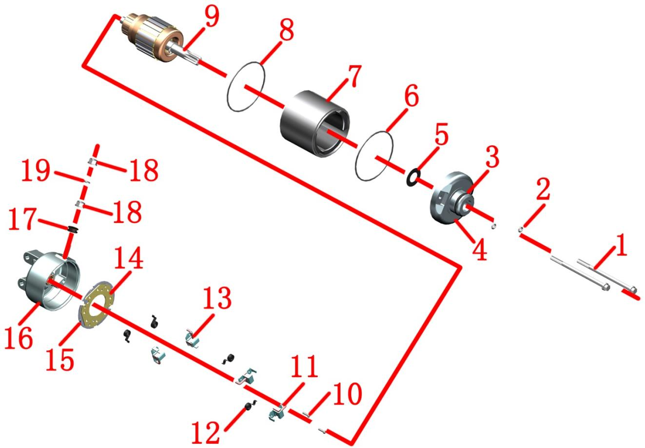
1-M6×90 螺栓×2 2-O 环×2 3-O 环 4-起动电机前盖 5-垫片 6-矩形密封圈 7-起动电机外过壳 8-矩形密封圈 9-电枢
