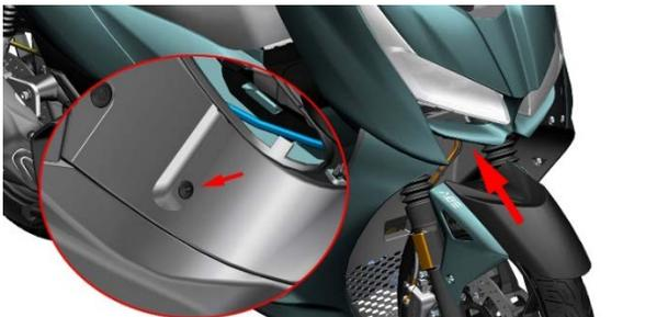
e. 用 8#套筒拆下后置物箱的 M6×22 螺栓(4), 取下衬套(5)和缓冲胶(6)。用 4#内六角将油箱盖板左部的膨胀钉中心圆柱销按下, 然后将膨胀钉取下。最后拆下油箱盖板左部。
