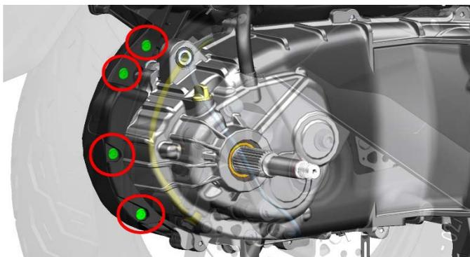
b. 用 4#内六角拆下图示的 M6×14 轴肩螺栓，此处的螺栓暂无法取下，完全松开即可。
