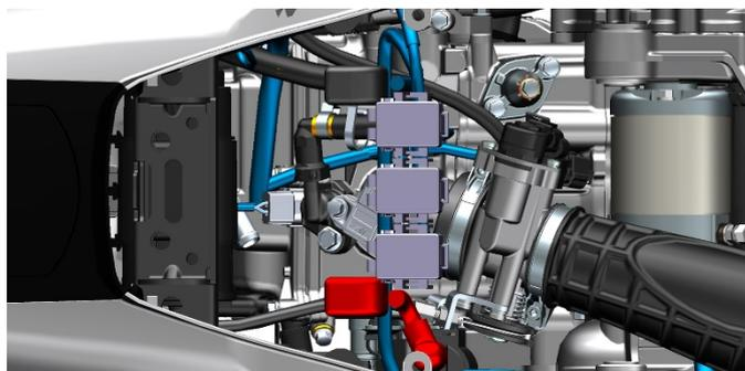
b. 将燃油泵插头拔下，起动发动机怠速运行直到发动机熄火。将发动机熄火开关打到“
