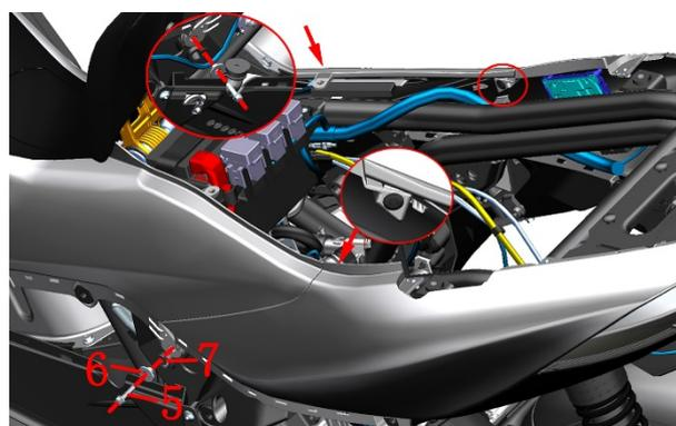
d. 用 4#内六角将 8 处膨胀钉中心圆柱销按下，然后将膨胀钉取下，将后尾群左右部、中部和左右尾灯（蓝色部分）一起取下。
