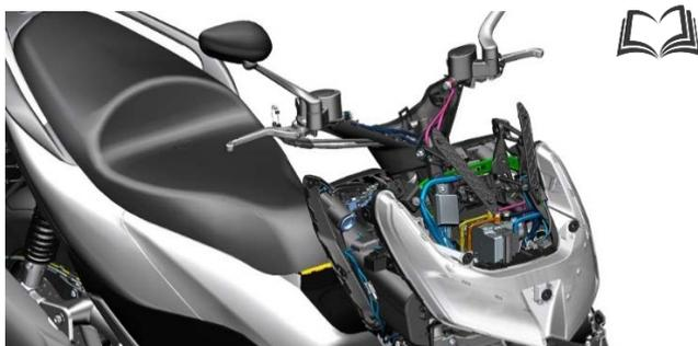
b. 将方向把线夹内的手把开关线束和制动软管从方向把线夹缺口处一一取出, 直至取完方向把线夹内所有线束。再用 4#内六角拆下 M6×12 螺栓, 取下方向把线夹。
