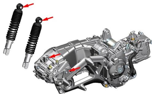
d. 检查减震底部焊缝处是否渗漏。
