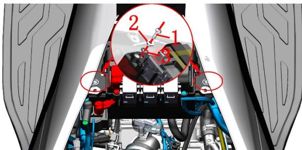
b. 参照“维护-拆火花塞”一节将左侧盖拆掉。将图中的高压线头从点火线圈上拔下。
