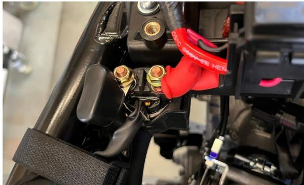
重新安装时继电器黄/红和绿/红线与主线缆线色对应，螺母处不用区分。确保螺母拧紧后将保护帽盖好。
