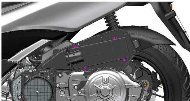
b. 将旧的空滤器滤芯取下。用吹尘枪将进气管内侧的灰尘吹干净后再用干净的无纺布将内壁擦拭干净。
