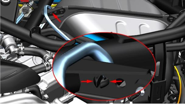
f. 用 10#套筒拆下固定油箱的 4 颗螺栓(1)。
