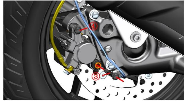
c. 借助工具将活塞按箭头方向推到底。若阻力很大时可参照前刹主泵添加制动液的方法拆下上盖后再推。若卡钳上的弹簧片掉下需按图示方向装回。
