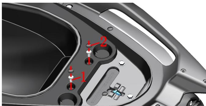
d. 将置物箱后部微微抬起，直至露出置物箱左侧的线束接头，拔下位于置物箱左侧的氛围灯插头；将插头拔下后将置物箱完整取出。
