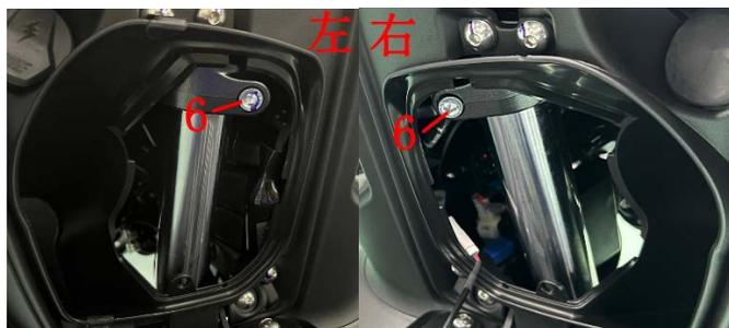
c. 使用 6#内六角拆下 M8×35 的 4 颗螺栓(6)，用一字批撬开下联板上的缝隙，取下左前减震、右前减震。
