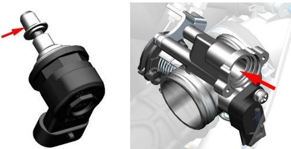
h. 将步进电机装回阀体上，注意不能漏装密封圈。将插头插回。
