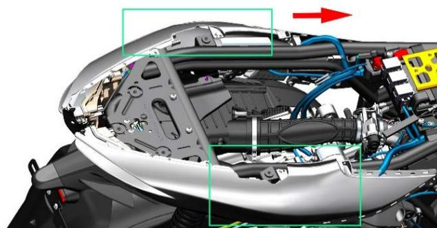
c. 另一个人将尾群底部和后泥板前部连接处的六颗膨胀钉装回。检查尾裙与周边零件的装配间隙，若有缝大等情况需重新安装。
