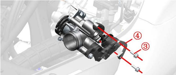
g. 使用节气门清洗剂清理步进电机头部的积碳。往阀体孔内喷入少量清洗剂。禁止用任何液体浸泡步进电机。
