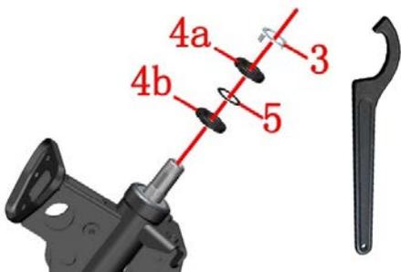
c. 将调节螺母(4b)顺时针拧到 50N.m (5.1 kgf.m, 37 lbf.ft)，转动车头，感觉很紧为正常，后逆时针松 1/4 圈，再次顺时针拧到 15N.m (1.2 kgf.m, 11 lbf.ft)。继续转动车头，略紧或略松，则微调 1/6 圈左右即可。
