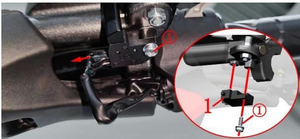
前刹车开关更换步骤与后刹车开关一致，需将油门线移开便于拆下螺栓①。
