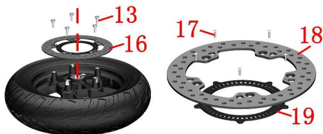
h. 参照拆卸顺序复原。注意有扭力要求的螺栓需按标准值校准。
