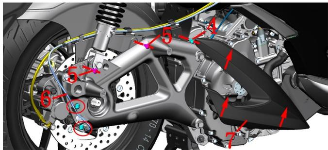
d. 在左侧空滤器与后内泥板的缝隙中，一手拉住空滤器壳体，一手将箭头指示的两处往里按后内泥板。将后内泥板与空滤器上的卡钉分离后往上抬起便于后续拆后摇臂。
