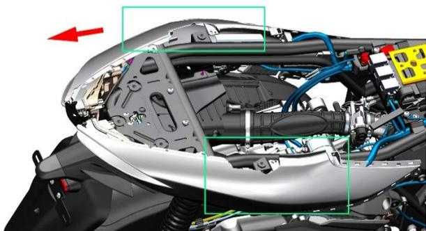
d. 使用 4#内六角拆下尾裙左部与左尾灯连接的 3 颗非标 M6×14 轴肩螺栓(4)和一颗膨胀钉；使用 4#内六角拆下尾裙左部与尾裙中部连接的 2 颗 M6×12 螺栓(1)，取下 1 个衬套(2)和 1 个缓冲胶(3)。将尾裙左部取下；
