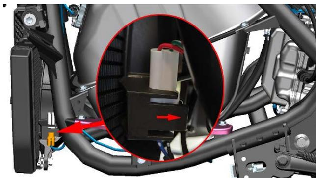
g. 用 8#套筒拆下两侧的 2 颗 M6×22 螺栓(1)后将水箱组件取下。
