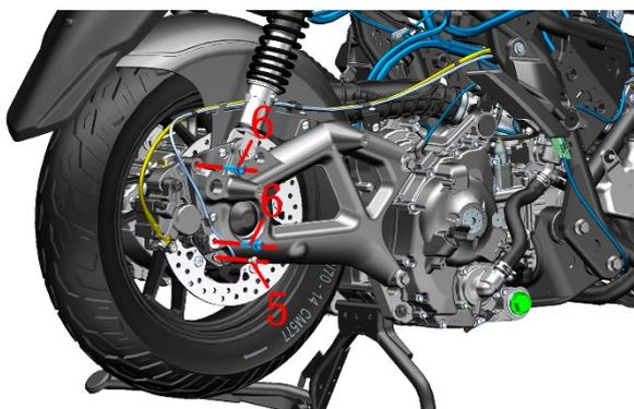
d. 一人使用 15#套筒从空滤器前方伸入固定车辆右侧固定发动机的 1 颗螺栓(1)，另一人使用 17#棘轮扳手装回车辆左侧固定发动机的 1 颗螺母(2)。扭力标准：65N.m(6.5 kgf.m, 48 lbf.ft)。
