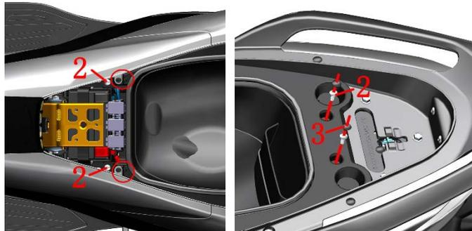
c. 抓住置物箱尾部往斜上方拉起，注意电池舱处的线缆。拉起到能看到左侧的置物箱氛围灯线头，将线头拔掉后取下置物箱组件。
