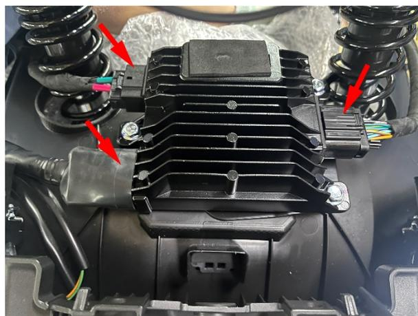
e. 使用10#套筒从启停控制器下方伸入并拆下固定启停控制器的2颗外六角螺栓(7)。接着拆下控制器与支架连接的3颗螺栓(7)。注意：此时启停控制器并不可取出，让启停控制器悬挂在空中即可。
