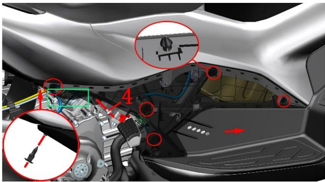
b. 使用同样的方法将左侧盖安装好。
