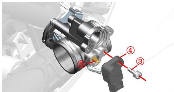
简易测试方法: 整车连接上诊断仪器, 按下熄火开关(无需打着火), 转动油门手把从初始位置到全开, 此过程查看节气门位置信号是否跟从 0 到 100 变化。
