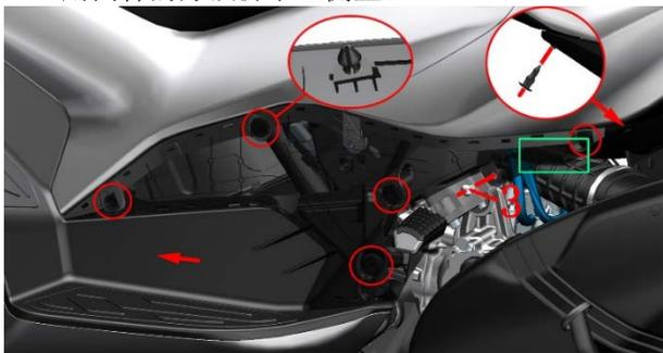
d. 使用 4#内六角和 8#套筒分别将油箱盖板左、右部与尾群连接处的两颗膨胀钉和两颗螺栓(5)拆下，取下衬套(6)和缓冲胶(7)。
