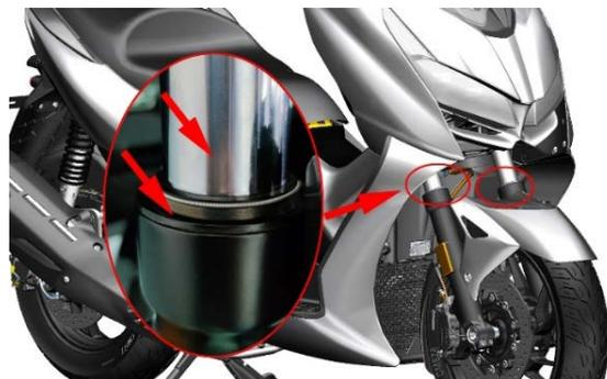
b. 检查底筒是否掉漆；前挡泥板、前轮空心轴和前刹卡钳的安装点是否断裂或开裂的迹象。检查底筒底部是否有渗漏。
