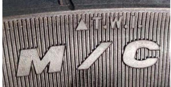
胎面凸起的磨损标记高度为 1.6mm (0.06 in)。胎侧三角形 (△T.W.I.) 标记指示磨损条位置。若磨损到标记点表明已经磨损到极限，继续驾驶会有安全隐患，必须更换新的同规格轮胎。
