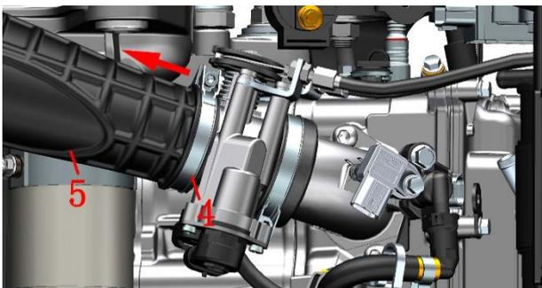
e. 用 5#内六角拆下 2 颗螺栓(6)后将阀体组件从发动机上取下。
