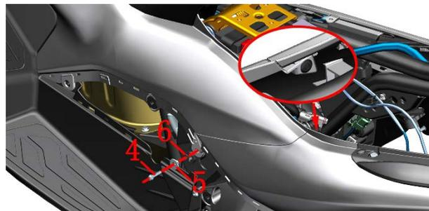
f. 先扣下 4 处螺栓装饰扣。用 4#内六角拆下挡风玻璃的 4 处 M6×14 轴肩螺栓(1)。拆下挡风玻璃装饰盖、挡风支架胶垫、遮阳板。
