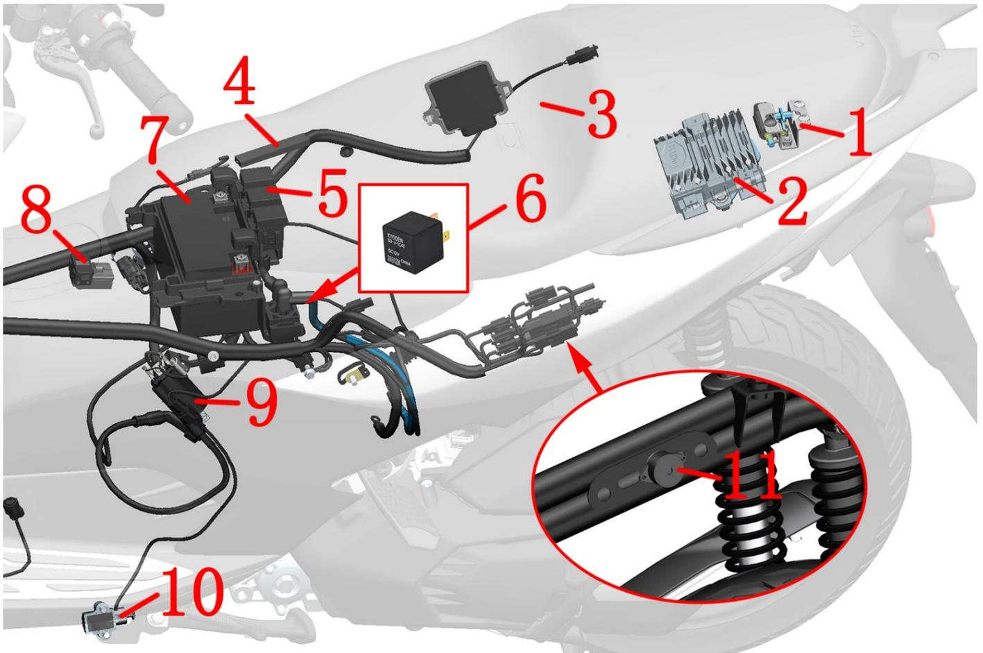
1-坐垫锁 2-启停控制器 3-发动机控制器 (ECU) 4-pke 外置天线 5-保险盒 6-起动继电器 (自动启停专用) 7-蓄电池
