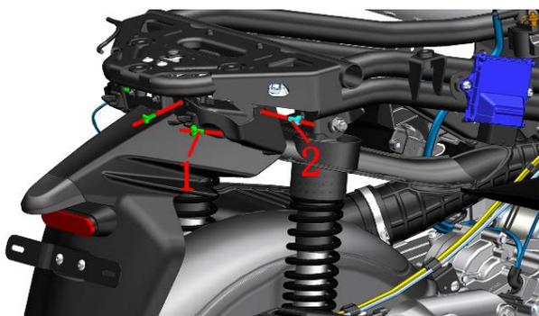
b. 从车架左侧的胶套中找到并拔下后牌照灯、左转向灯的连接头。
