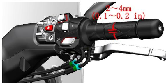
d. 启动发动机后左右转动方向把，确保转向过程中怠速不变，然后熄火。
