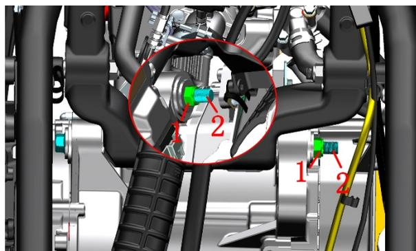
c. 一人使用 14#套筒伸入并固定左后减震上方的 1 颗螺母(4), 一人使用 14#套筒+棘轮扳手从车架中拆下固定左后减震的 1 颗螺栓(3), 并抽出螺栓(3)。使用同样方法拆下固定右后减震的 1 颗螺母(4), 一人扶住车架, 一人使用胶锤+合适工具敲出固定右后减震的 1 颗螺栓(3)。螺母(3)扭力标准: 30N.m(3.1 kgf.m, 22 lbf.ft)。
