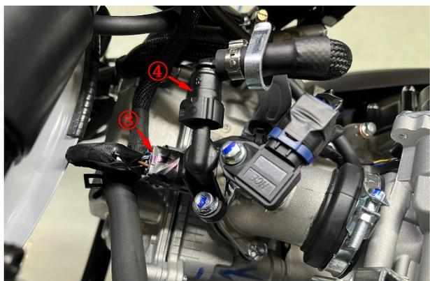
e. 在车架右内侧位置找到并拔下曲轴位置传感器插头⑤，在右脚踏支架下面找到并拔下氧传感器插头⑥。
