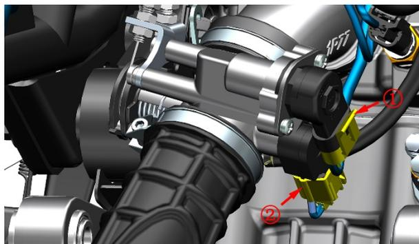
b. 将小型容器放置在高压油管底下，按下③指示的卡扣同时按箭头方向拔出高压油管(1)。拔出时会有少量燃油流出，禁止滴落到零件表面。
