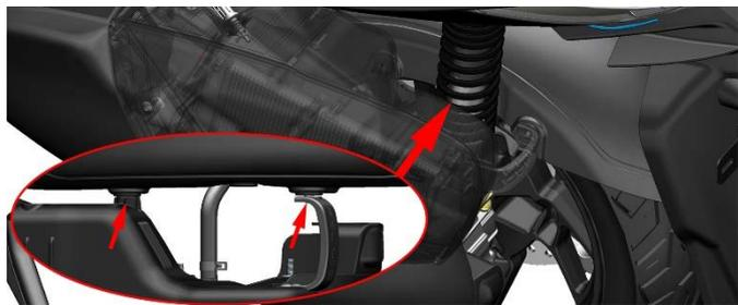
e. 用 14# 套筒拆下固定后刹卡钳的 2 颗螺栓(10)，将卡钳和轮速传感器线绑好。注意让卡钳自然下垂不影响拆卸后摇臂即可。用 14# 套筒先拧松 2 颗螺栓(8)。再用 12# 套筒拆下固定后减震的螺栓(9)，将后减震移开绑好。一手抓牢后摇臂，一手将 2 颗螺栓(8)拆下。将后摇臂往外拉，取下后摇臂，注意复装时不能遗漏轴套(11)。螺栓(8)标准扭力： $55\text{N}\cdot\text{m}$  (5.6 kgf.m, 33 lbf.ft)；螺栓(9)和(10)为  $24\text{N}\cdot\text{m}$  (2.4 kgf.m, 18 lbf.ft)。
