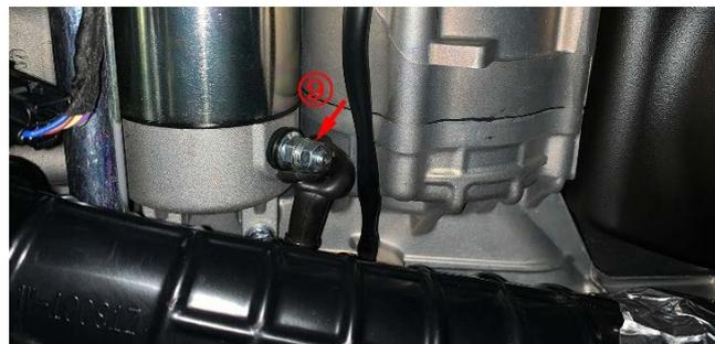
i. 在节气门阀体右边找到并拔下缸头水温传感器⑩的插头。
