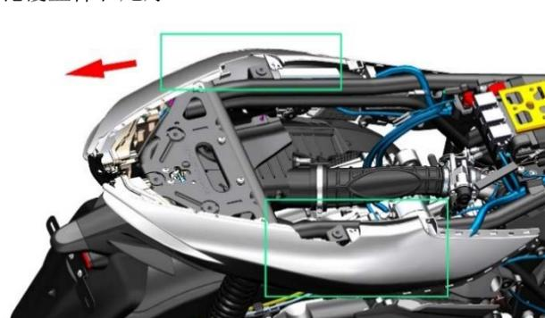
h. 参照“拆卸火花塞”步骤拆下左踏板。
