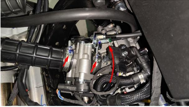
e. 旋转节气门阀体，使步进电机插头朝上。将步进电机①和传感器②的插头拔掉。
