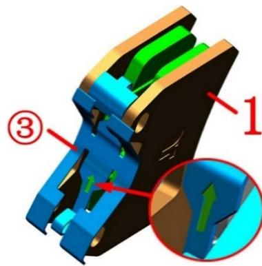
g. 用手将箭头⑧所指处的片体向箭头方向往里按住，将用销轴②插入孔位固定住制动片(1)。用 T25 内六角梅花扳手上紧销轴②
