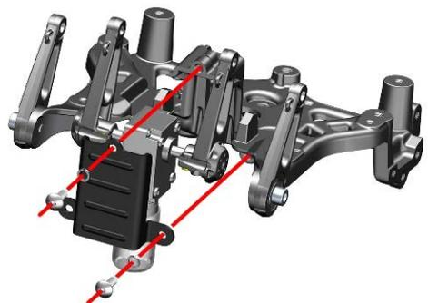
f. 使用十字螺丝刀拆下 2 颗 M4×16 螺栓，将摇臂压块和右下摇臂分离。将 2 件摇臂缓冲胶从摇臂压块上取下。用同样的方法拆下左下摇臂。
