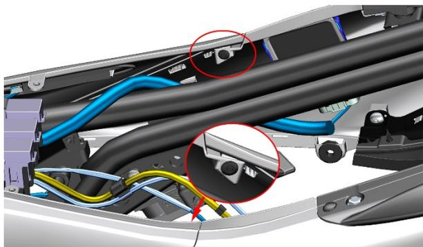
b. 用十字螺丝刀拆下包围上部的两颗螺钉。
