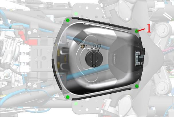
g. 确认已经拔掉高压油管、通气管和油位传感器插头后，站在车辆右侧便于取下油箱组件。托起油箱组件顺时针转动（如图 1），边转边让油箱右侧的滚焊边往下转到支架的底部（如图 2）。顺时针转动约 90 度后将油箱组件往前翻转（如图 3）。不断调整位置后取下油箱组件（如图 4）。因难以用语言详尽描述过程，故需多次耐心尝试。
