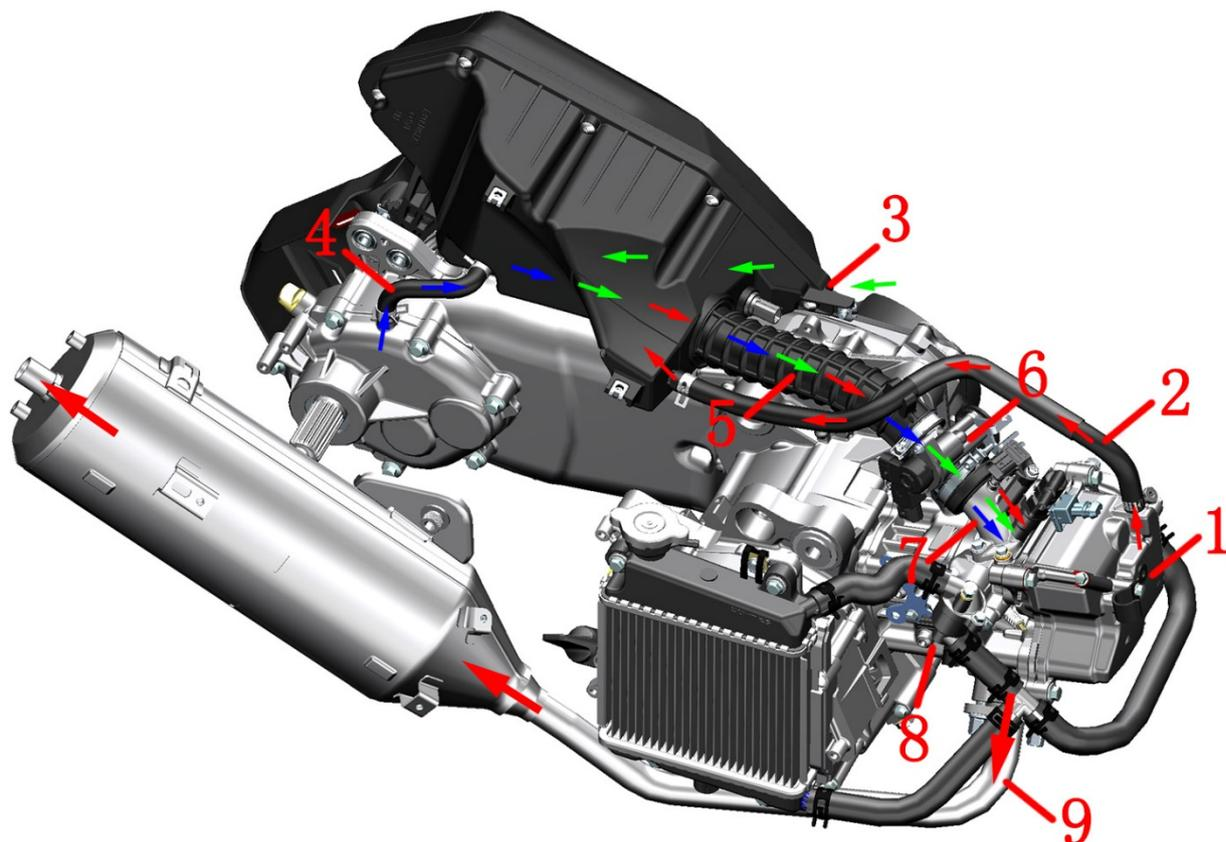
1-缸头 2-缸头废气管 3-空滤器进气口 4-齿轮箱废气管 5-空滤器出气管 6-节气门阀体组件 7-进气歧管 8-气缸
