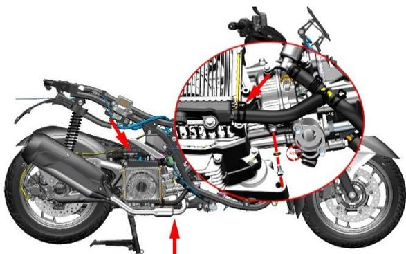
b. 拔下发动机头部的高压包插头。(D350 高压包位置在左侧, D150 高压包位置在右侧。)
