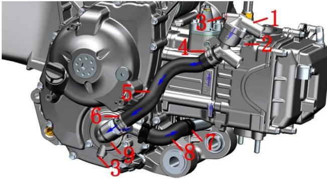
1-节温器组件 2-M6×22 螺栓\*2 3-M6×12 螺栓\*2
