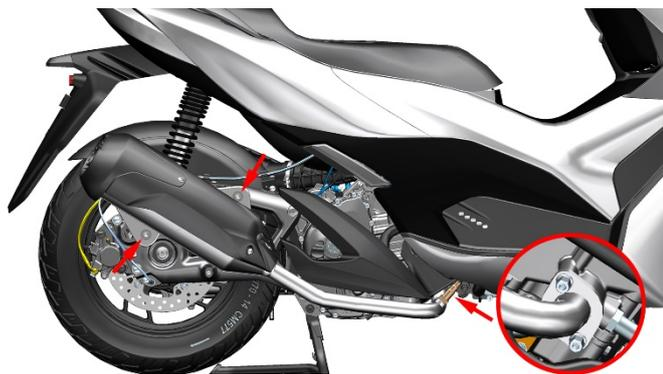
a. 如有轻微漏气可先尝试用 6#内六角紧固排气口螺母；如问题未解决则需将消声器拆下，更换新的发动机排气口密封垫。
