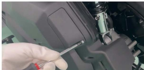
b. 用尖嘴钳将旧的空滤器滤芯取下。用吹尘枪将进气管内侧的灰尘吹干净后再用干净的无纺布将内壁擦拭干净。
