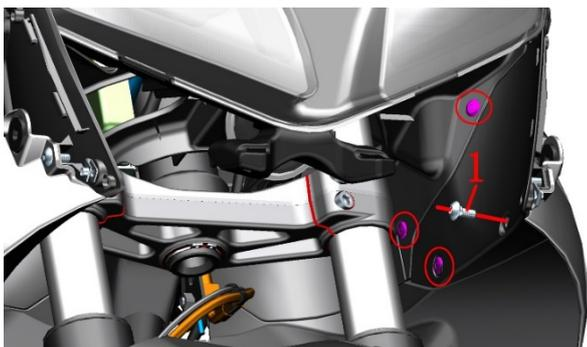
b. 使用 4#内六角拆下左面板底衬的 3 颗膨胀钉（红色圆圈）；使用 4#内六角拆下左面板底衬的 2 颗螺栓(1)和 2 颗螺栓(4)，取下衬套(2)和缓冲胶(3)。
