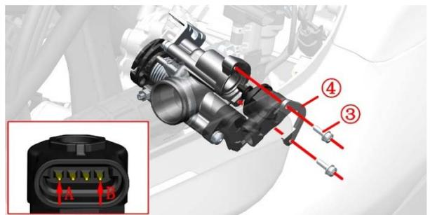
简易测试方法：整车连接上诊断仪器，按下熄火开关（无需打着火），转动油门手把从初始位置到全开，此过程查看节气门位置信号是否跟从0到100变化。
