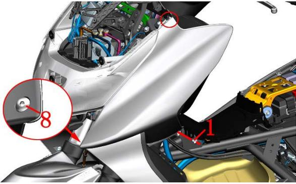
j. 用手指或塑料撬棍插入箭头指示处，先将箭头指示处撬开缝隙后再拉起。取下踏板胶垫和压板。
