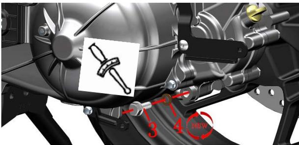
d. 将 M8×25 放油螺栓(3)和 8.3×16×1.5 铜垫(4)取下。
