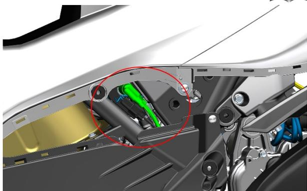
c. 按下箭头所指的位置往外拔出。将点火线圈(5)的接头拔下。然后用8#开口扳手或棘轮扳手将两颗螺栓(4)拆下。更换点火线圈。
