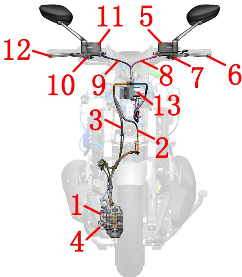
1-轮速传感器（前轮） 2-FC-HU 制动软管 3-RC-HU 制动软管 4-轮速传感器（后轮） 5-后碟刹主泵 6-后制动手柄 7-后
