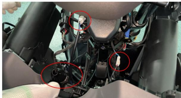
d. 翻转到背面先将拉索从锁架上按箭头方向拉出。翻回正面分别用 4#内六角拆下 M6×14 螺栓，同时在背面抓牢右储物盒锁组件①、电子前置物箱锁组件②。
