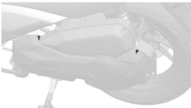
b. 用 T30 梅花扳手拆下 4 颗小法兰 M6×16+衬套+胶垫。
