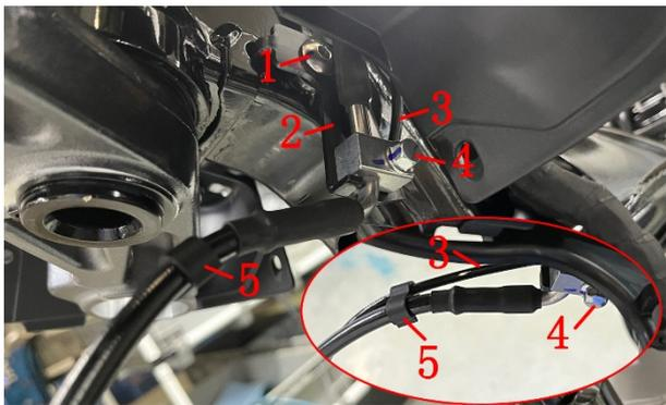
d. 检查取下的软管表面是否有老化龟裂、破损、磨损等不良现象。用无纺布擦拭干净残留的制动液后用保鲜膜或塑料袋将软管两端面包好，防止异物进入。检查轮速传感器线的线缆外皮是否有破损，若有磨破外皮可用电工胶布粘好防止短路。
