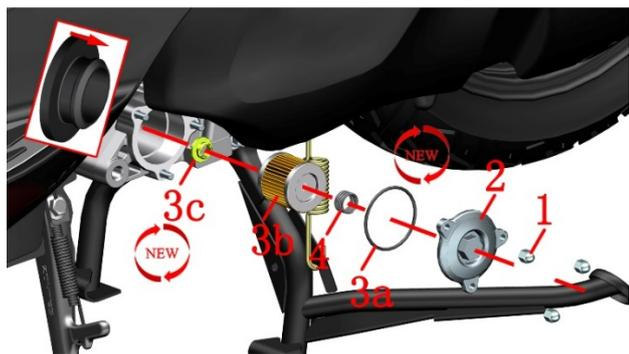
b. 用 10# 套筒松开滤器盖上的 3 个螺母。
