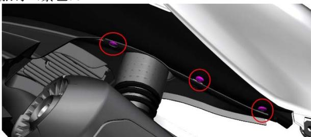
g. 用手抓住尾裙两边往箭头方向，将左、右尾裙和左、右尾灯，尾裙中部一起拔出，注意：谨慎拔出，以免刮花覆盖件和尾灯。
