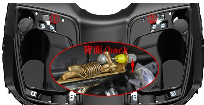
e. 翻转到背面后用 5#内六角拆下 3 颗 ST4.2×12 自攻钉后, 将前储物盒开关从面板上取下。将拉锁从开关上取下。
