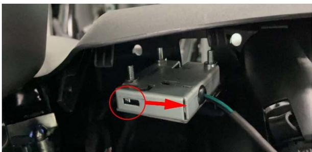
e. 参照右储物盒外盖的步骤将左储物盒外盖拆解
