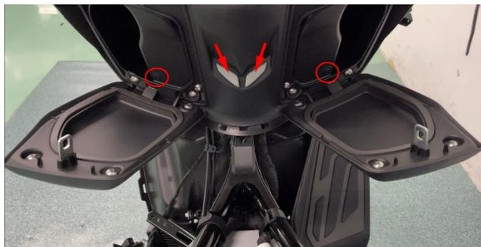
b. 将方向把打至最左，使用 6#内六角拆下 M8×35 的螺栓(6)。用相同方法，将方向把打至最右拆下螺栓(6)。用一字批撬开上联板上的缝隙。
