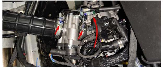
b. 拔掉底部的节气管，拔出空滤器出水管，然后拆下节气门阀体组件。
