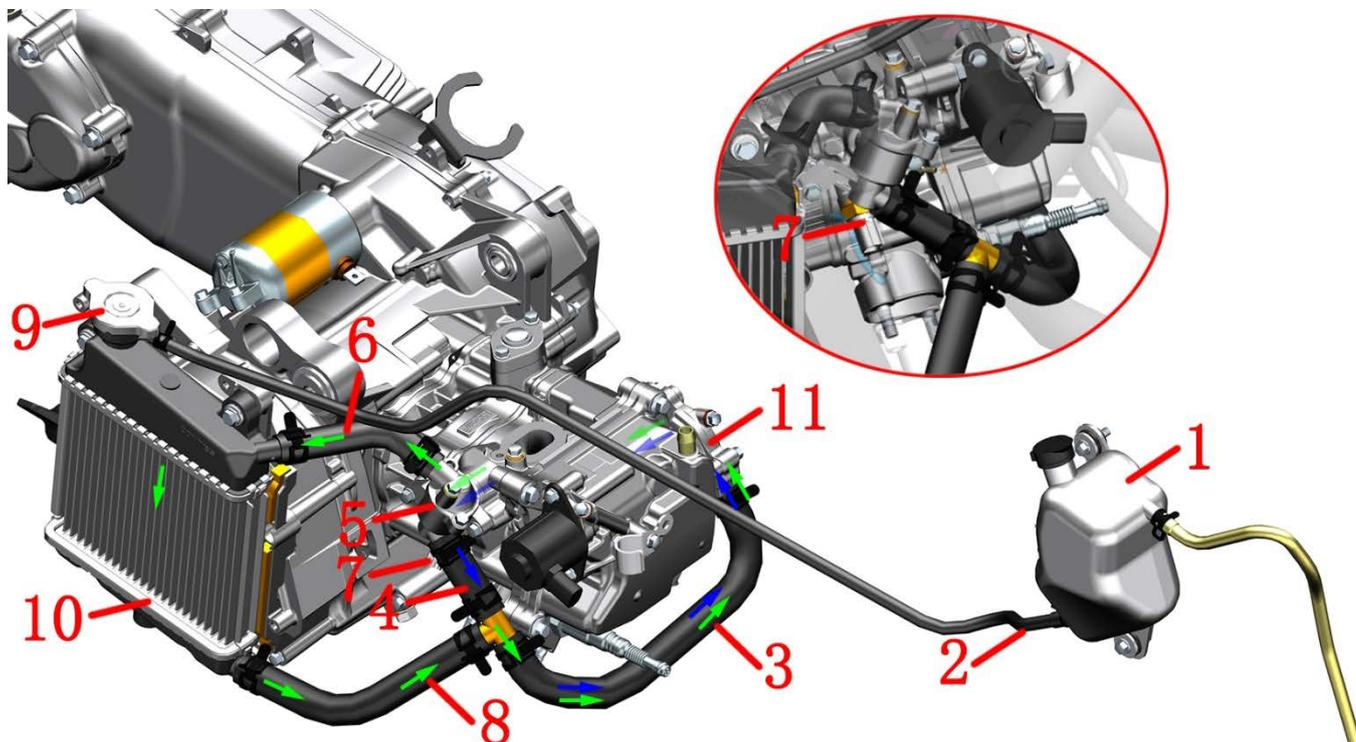
1-副水箱 2-副水箱连接管 3-发动机进水管 4-节温器出水管 5-节温器 6-水箱进水管 7-水油共用传感器 8-水箱出水管
