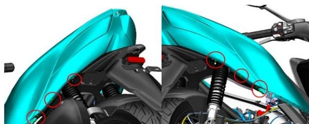
e. 将后泥板前部往下拉开，用 14#套筒固定好螺母(8)，在内侧用 14#棘轮扳手完全松开螺栓(9)，取下螺母(8)。注意先不要取下螺栓(9)。另外一侧按同样操作拆下螺母(8)。螺母(8)扭力标准：30N.m(3.1 kgf.m, 22 lbf.ft)。
