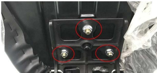
b. 将电池舱内的线缆理顺。先扣下 2 处螺栓装饰扣(3)。用 4#内六角拆下后置物箱的 4 处 M6×16 螺栓(2)。用 4#内六角将 2 处膨胀钉中心圆柱销按下，然后将膨胀钉取下。
