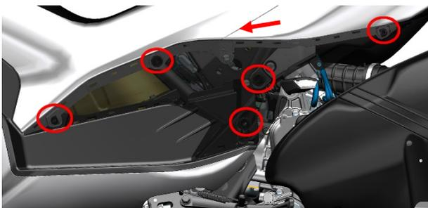
c. 先扣下 2 处螺栓装饰扣(3)。用 4#内六角拆下后置物箱的 4 处 M6×16 螺栓(2)。用 4#内六角将 2 处膨胀钉中心圆柱销按下, 然后将膨胀钉取下。最后将后置物箱拆下。
