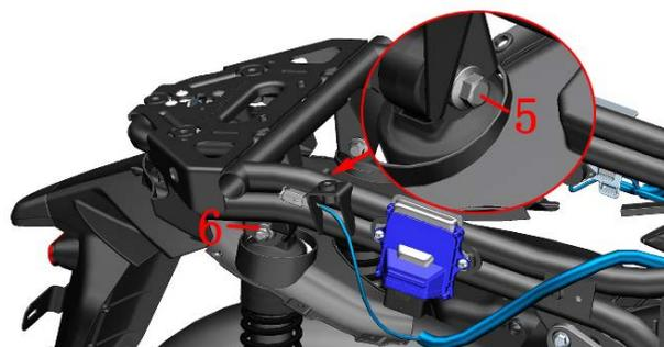
d. 使用棘轮扳手+8#套筒从整流器下方伸入并拆下固定整流器的 2 颗外六角 M6×22 的螺栓(7)。注意：此时整流器并不可取出，让整流器悬挂在空中即可。
