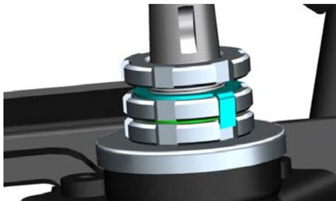
f. 前轮悬空将方向把摆正，用手轻推拉方向把感受转向机构是否顺畅无卡滞。将前叉组件稍偏向一侧时应能在自身重量下缓慢偏转到底，若快速到底则需重新调整。
