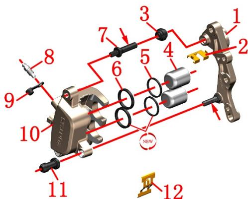
1-卡钳安装板 2-刹车片支架 3-卡钳橡胶帽 4-活塞 5-防尘封 6-油封 7-卡钳销 8-排气喷嘴 9-排气喷嘴帽 10-卡钳外壳 11-卡钳安装板橡胶帽 12-制动弹簧
