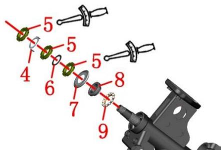
c. 将一颗GB878 M8×30（环保彩）限位销安装入方向柱的凹槽内，然后对准底座上的凹槽，拧入盖形螺母。扭力：100N.m (10.2 kgf.m, 74 bf.ft)
