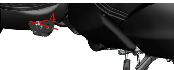
f. 使用柴油或煤油，或者干净的抹布将残留的润滑脂擦拭干净。在侧支架内侧 2 个安装平面、与熄火开关配合的面涂抹适量润滑脂，尽量不要涂抹到螺纹孔内。
