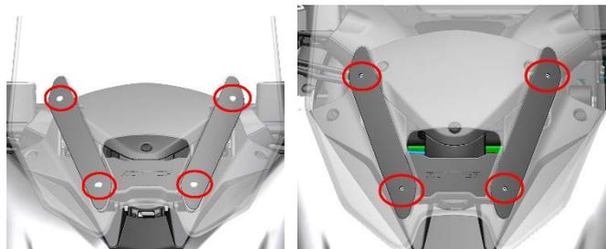
g. 用 4#内六角将 3 处膨胀钉中心圆柱销按下, 然后将膨胀钉取下。最后将前部遮阳板拆下。
