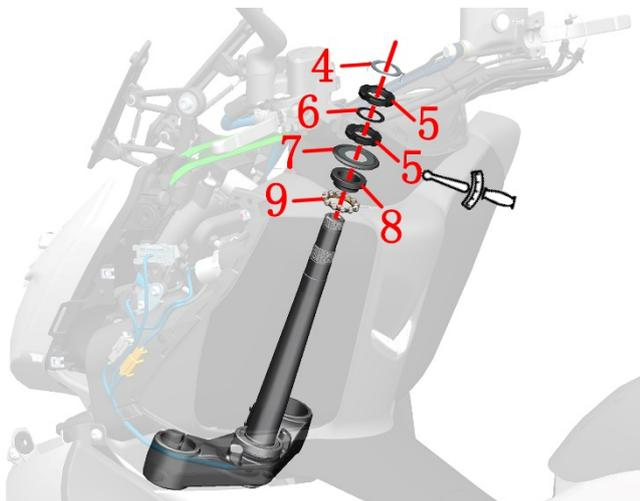
c. 将方向把垫块和下联板的装入，放入垫片(3)，最后拧入盖形螺母(2)，扭力：100N.m (10.2 kgf.m, 74 bf.ft)
