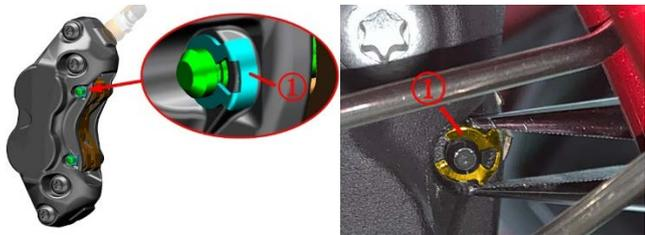
b. 用 T25 内六角梅花扳手取下两根销轴②，将弹片③和制动片取(1)下。清理干净活塞外缘和销轴的灰尘等异物。
