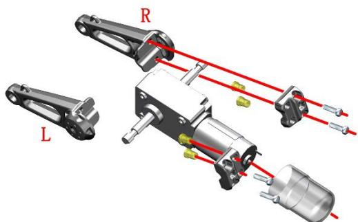
g. 用 6# 内六角拆下 M8×16 螺栓，取下垫片、轴承和上摇臂。
