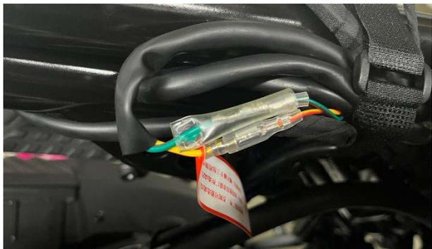
b. 解锁车辆，发动机熄火开关打到“ $\odot$ ”，收起侧支架，捏住制动手柄按下起动按钮应能听到起动继电器吸合的声音，否则应检查起动线路。
