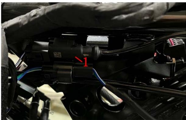
b. 先取下 3 件线夹(3)，然后将轮速传感器(1)和 RC-HU 软管从 3 件油管夹(2)中拔出。如需拆下油管夹(2)可用 4# 内六角拆下螺栓后即可取下。
