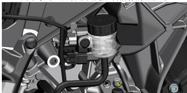
c. 用十字螺丝刀拆下固定后刹油杯的膨胀钉。
