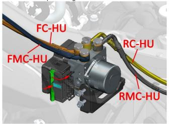
FMC-HU: FRONT DISC BRAKE MAIN PUMP - HYDRAULIC CONTROL UNIT FC-HU: FRONT DISC BRAKE CALIPER-HYDRAULIC CONTROL UNIT RMC-HU: REAR DISC BRAKE MAIN PUMP - HYDRAULIC CONTROL UNIT RC-HU: REAR DISC BRAKE CALIPER-HYDRAULIC CONTROL UNIT
