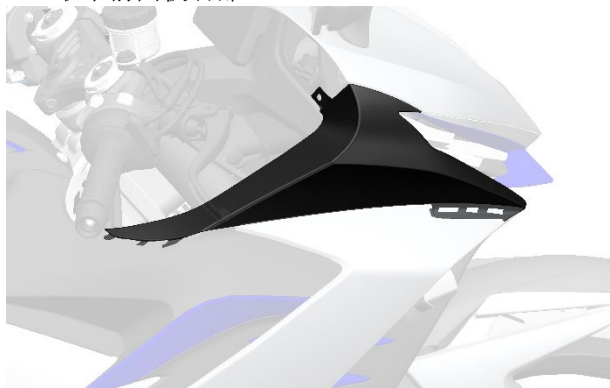
e. 直接用手，小心拉开左包围上方的卡扣。
