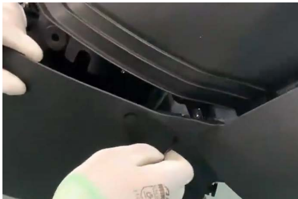
d. 用 4#内六角将另外 4 颗 M6×14 轴肩螺栓装回。
