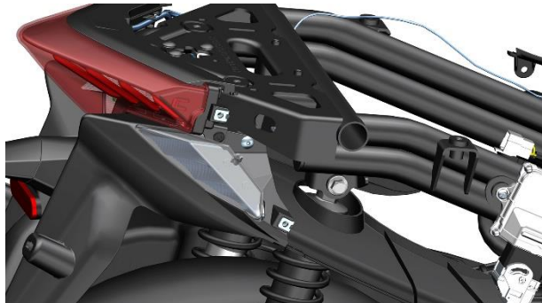
b. 使用同样的方法拆下尾裙底板右部。
