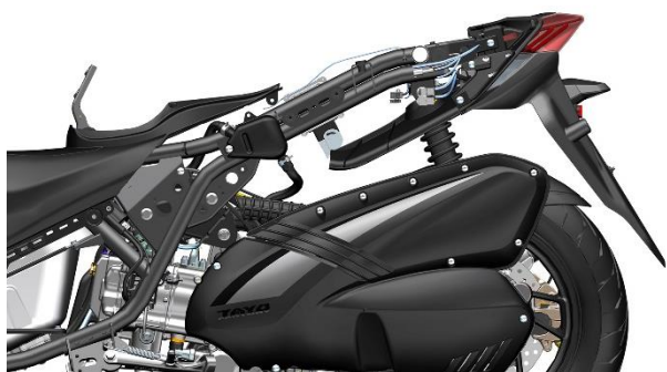
d. 使用同样的方法拆下左后尾裙。
