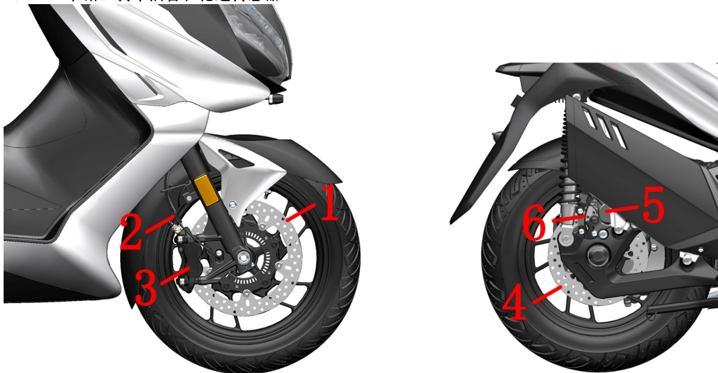
1-前制动盘组件 2-轮速传感器（前轮） 3-前碟刹卡钳 4-后制动盘组件 5-后碟刹卡钳 6-轮速传感器（后轮）
