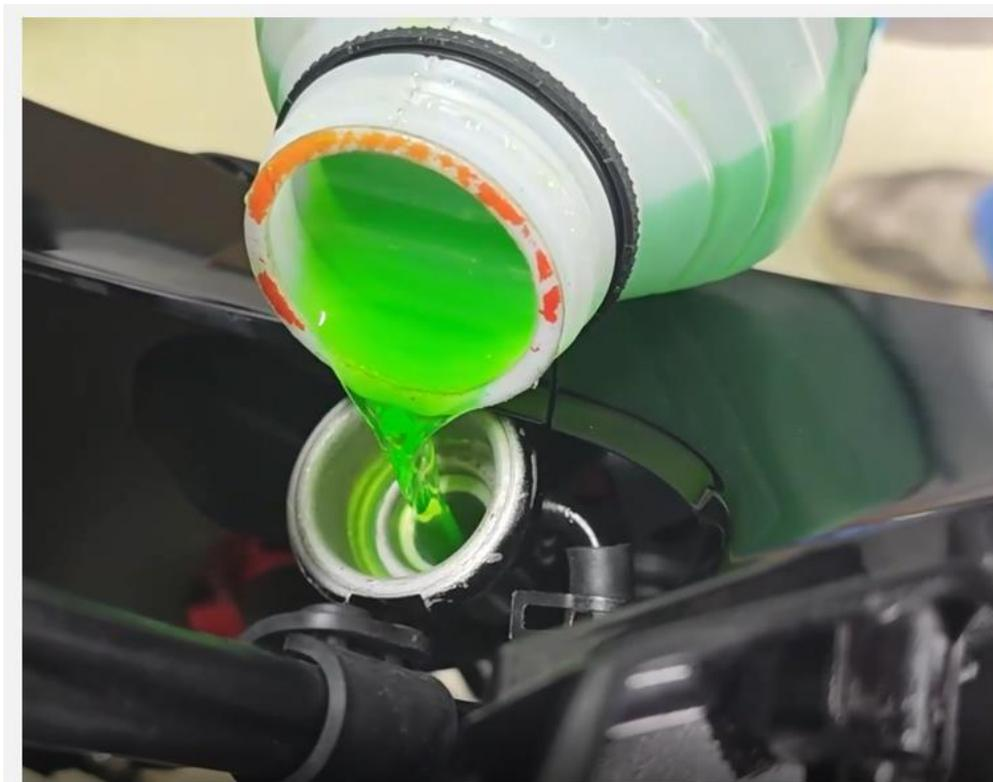
将车身向左侧倾斜，加注冷却液。
