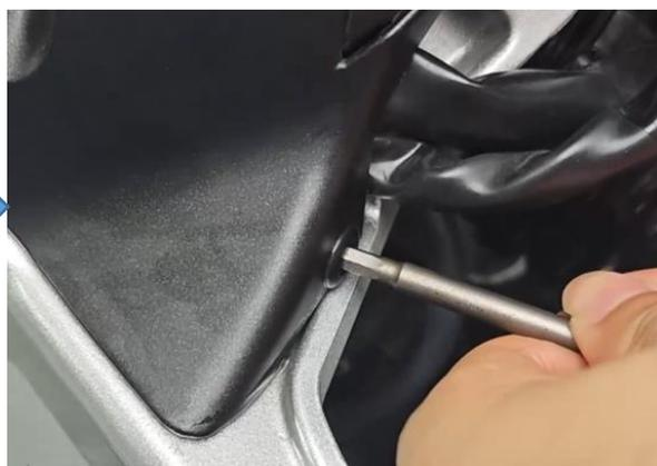
然后将装饰罩的螺丝以及膨胀钉拆下
