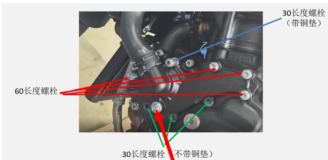
如上图所示拧紧水泵盖的固定螺栓（扭矩 11.5N.m）
