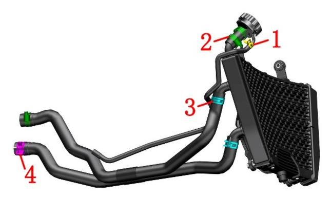
1- Water pipe clamp ( $\phi$ 9) 2-Water pipe clamp ( $\phi$ 26)\*3 3-Water pipe clamp ( $\phi$ 24) \*2 4-Water pipe clamp ( $\phi$ 26)
