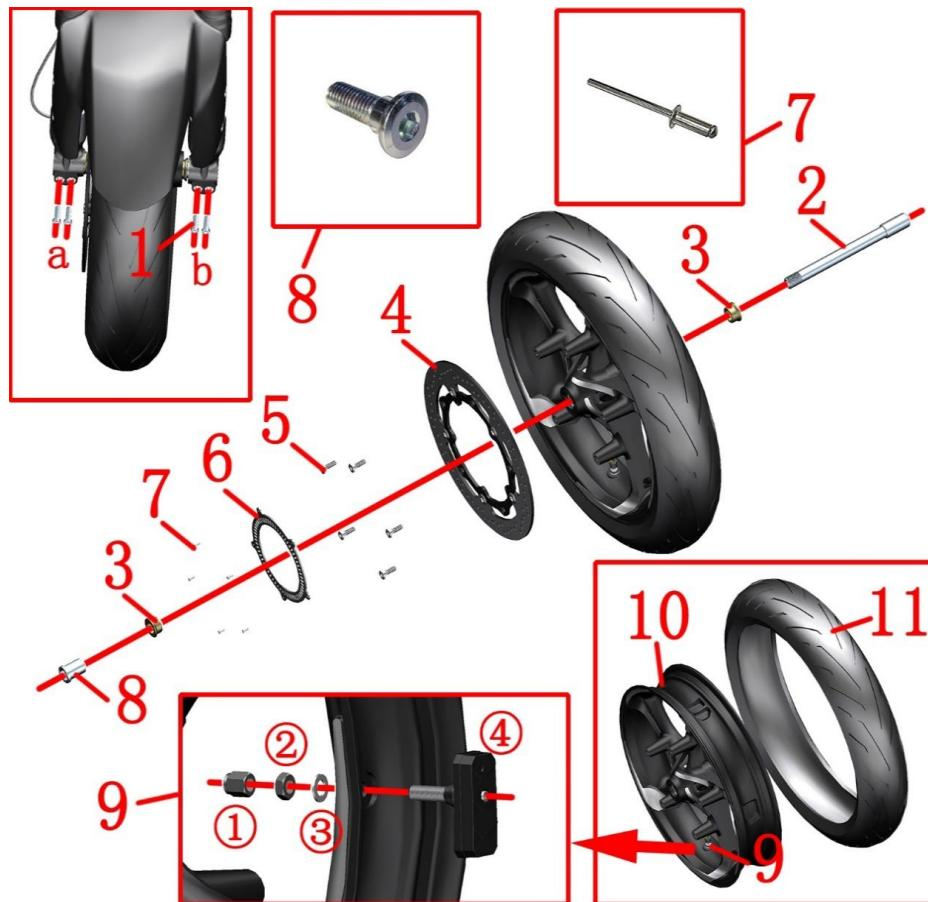
**轮辋:** 检查轮辋是否有变形、裂纹等不良现象。将轮辋水平支撑好旋转检查是否存在卡滞、摆动等。
