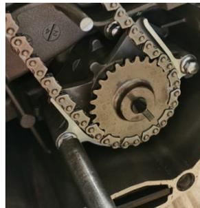
②取出 2 颗机油泵螺栓，将机油泵总成和机油泵链条一同取出。
