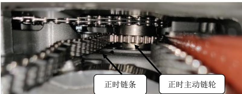
3、如图示，确认无漏装、错装后，将气缸头装入发动机对应位置。均匀对角预紧缸头螺母以及侧面两根锁紧螺栓后，分别使用定扭扳手打紧（M10 $\times$ 1.25 六角法兰面螺母定扭  $55 \pm 5\text{N}\cdot\text{m}$ ，M8 $\times$ 1 $\times$ 117 六角法兰面 9.8 级螺栓定扭  $20 \pm 2\text{N}\cdot\text{m}$ ）。
