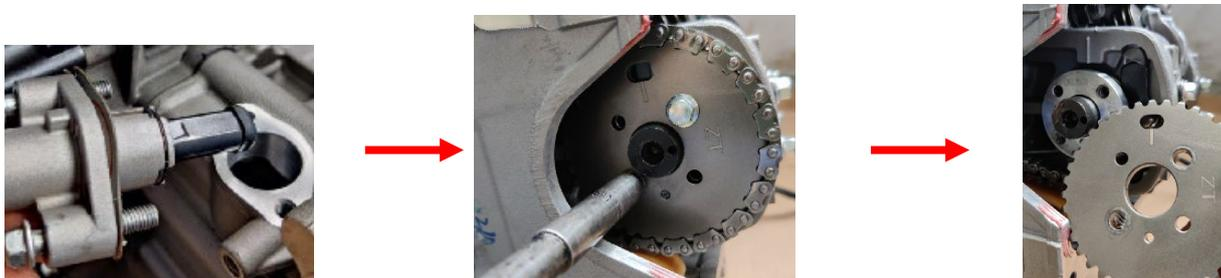
4、如图所示，先用 T 杆-10# 拆下气缸头侧面 2 颗 M8×1×117 六角法兰面螺栓，再用扳手-14# 对角拆下气缸头 4 颗 M10×1.25 锁紧螺母。
