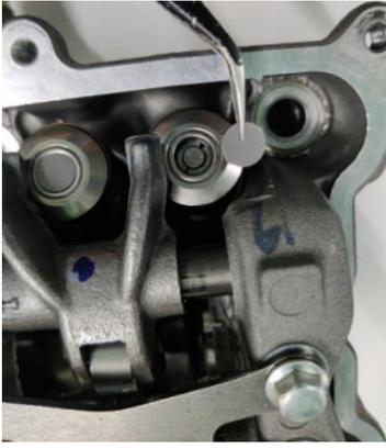
5、如图所示，气门间隙调整完毕后，安装摇臂限位块以及限位块锁紧螺栓（螺栓需涂抹螺纹胶，扭力  $7 \pm 1 \text{N}\cdot\text{m}$ ）。安装气缸头压板，分别用 4 颗 M6×10 螺栓锁紧（涂抹螺纹胶，扭力  $10 \pm 1 \text{N}\cdot\text{m}$ ）。
