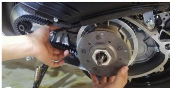
8、捏住主滑动轮分部件和里面的斜坡板，连同主动轮轴套一起取下。
