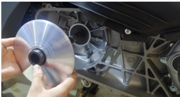
9、最后取出  $\phi 23.2 \times \phi 40 \times 3.25$  垫圈，即完成了无极变速离合器分总成部分的拆解。
