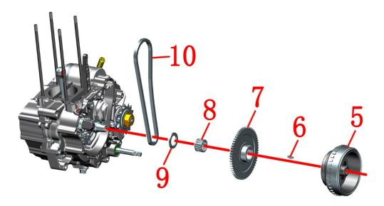
●磁电机总成的拆卸
