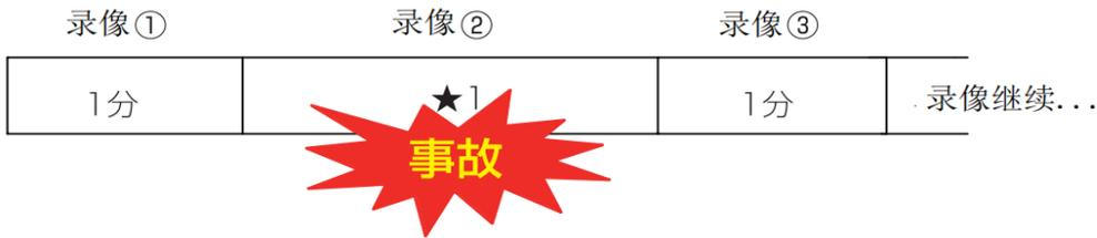
如上图，设置循环录像时间 1 分钟时，录像②的录制过程中，G-sensor 感知到碰撞后，主机将前后摄像头的视频文件（录像②的 1 分钟和录像③的 1 分钟）保存到 Event 文件夹。假设录像时间是 17:06:33 开始，碰撞或手动启动加锁视频功能时，录像视频处于 17:06:56，最终保存不能覆盖的录像文件是 17:06:33-17:08:33（两个视频文件，本段视频+下一段视频）
