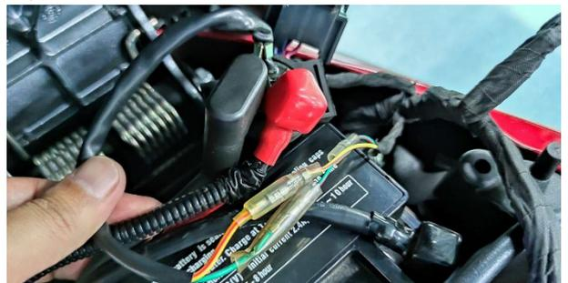
b. 解锁车辆，发动机熄火开关打到“
