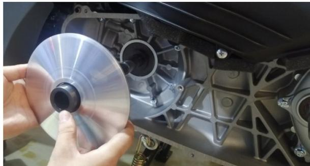
i. 最后取出  $\phi 23.2 \times \phi 40 \times 3.25$  垫圈，即完成了无级变速器离合器分总成部分的拆解。
