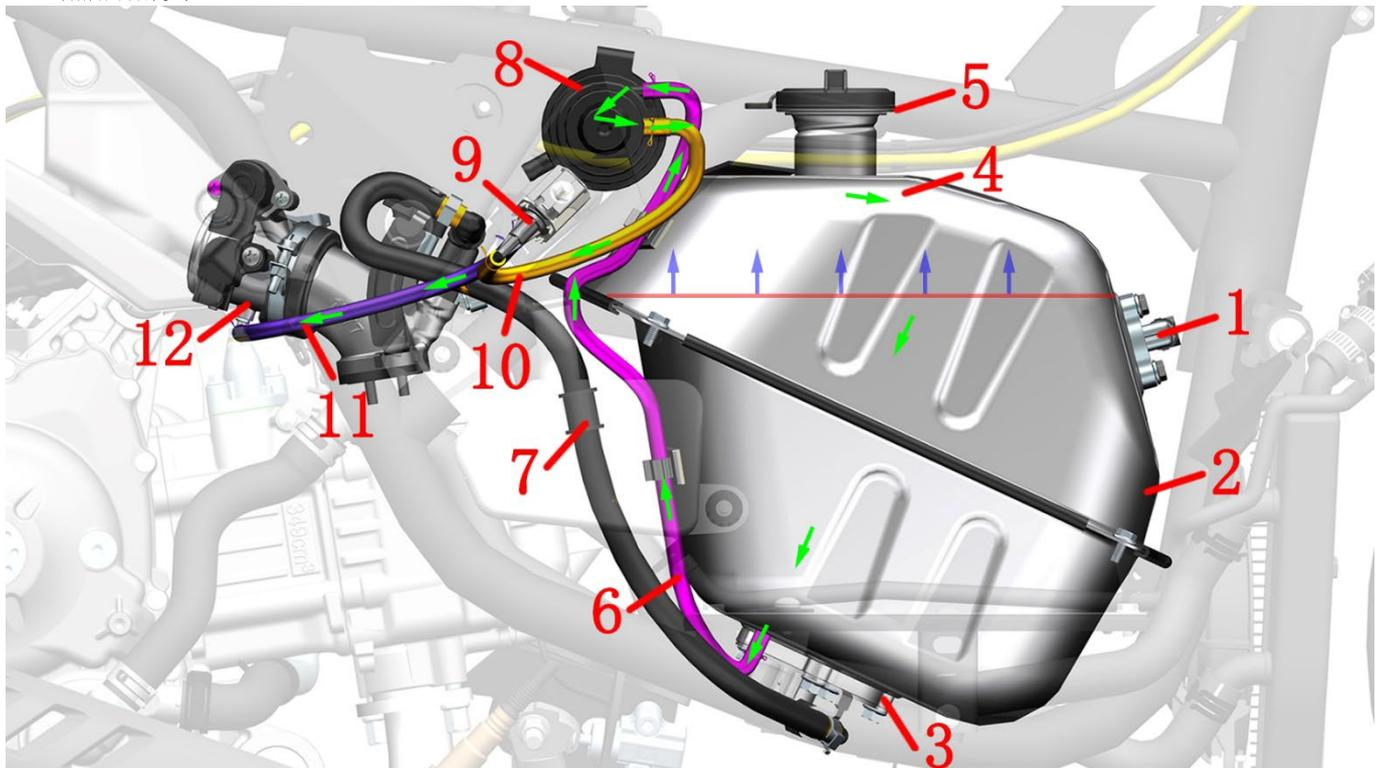
1-油位传感器 2-燃油箱 3-燃油泵 4-油气分离器（焊接在油箱内部） 5-油箱盖 6-吸附/通气管 7-高压油管 8-碳罐 9-碳罐电磁阀 10-电磁阀进气管 11-电磁阀出气管 12-节气门阀体组件
