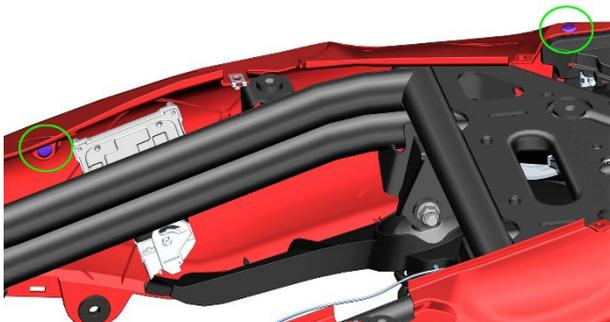
f. 一手将尾裙前部与油箱盖板右部（金色）接触的部分往下压，一手将油箱盖板右部（金色）往外拔，直至将尾裙前部拔出；再一手抓住油箱中部盖板（蓝色）往下按，一手抓住尾裙前部往上方拔，直至尾裙前部和油箱中部盖板（蓝色）分开；最后一手抓住尾裙后部（绿色标识处），一手抓住尾裙前部按箭头方向取出。用同样的方法拆下左侧尾裙。
