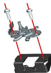
i. 使用十字螺丝刀拆下 3 颗 M4×25 螺栓后将电子储物盒锁拆下。
