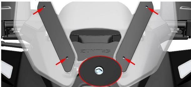
c. 依次取出挡风玻璃左、右装饰盖、挡风玻璃、挡风玻璃支架胶垫。
