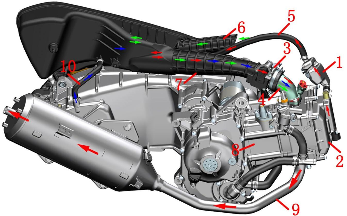
1-外置油气分离器 2-缸头 3-节气门阀体组件 4-进气歧管 5-缸头废气管 6-空滤器进气管 7-空滤器出气管 8-气缸 9-消声器 10-齿轮箱废气管
