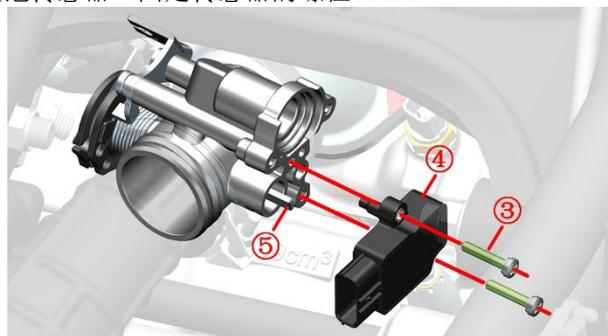
d. 擦拭干净传感器头部或更换新的三合一传感器，将三合一传感器对齐转轴⑤装回阀体上。将步进电机装回。
