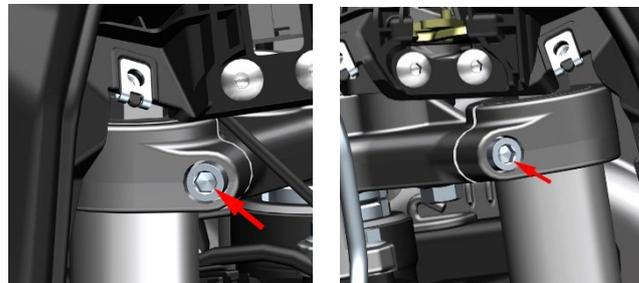
c. 使用 6#内六角拆下 M8×30 的 4 颗螺栓，用一字螺丝刀撬开下联板上的缝隙，取下左前减震、右前减震。
