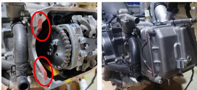
k. 将 13×2.8 0 型圈套在 M14×1.5 螺塞上，拧入右曲轴箱盖对应螺孔，用 5#内六角扳手拧紧，扭矩值  $10 \pm 2\text{N}\cdot\text{m}$  ( $1 \pm 0.2 \text{ kgf}\cdot\text{m}$ ,  $7.4 \pm 1.5 \text{ lbf}\cdot\text{ft}$ )；将 27.4×2.65 0 型圈套在 M30×1.5 铝螺塞上后，拧入右曲轴箱盖对应
