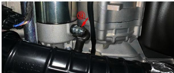
i. 在节气门阀体右边找到并拔下缸头水温传感器⑩的插头。**注意：**缸头水温传感器直接连接发动机，不要拔错。
