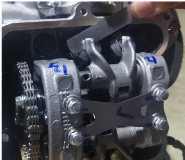
i. 将两只气门摇臂限位块套在 M5×15-5#内六角圆柱头螺栓上，然后在 M5×15-5#内六角圆柱头螺栓螺纹上涂抹适量螺纹防松胶。将两只气门摇臂限位块连同 M5×15-5#内六角圆柱头螺栓分别安装在进气门摇臂轴和排气门摇臂轴上，锁紧扭矩值  $5 \pm 1\text{N}\cdot\text{m}$  ( $0.5 \pm 0.1 \text{ kgf}\cdot\text{m}$ ,  $4 \pm 0.7 \text{ lbf}\cdot\text{ft}$ )。
