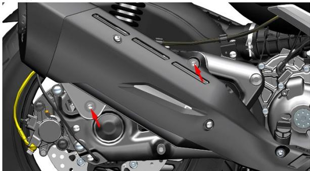
a. 如有轻微漏气可先尝试用 6# 内六角紧固排气口螺母；如问题未解决则需将消声器拆下，更换新的发动机排气口密封垫。
