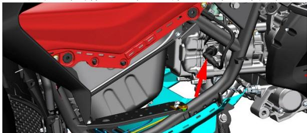
l. 将点火线圈高压帽往外拔下。
