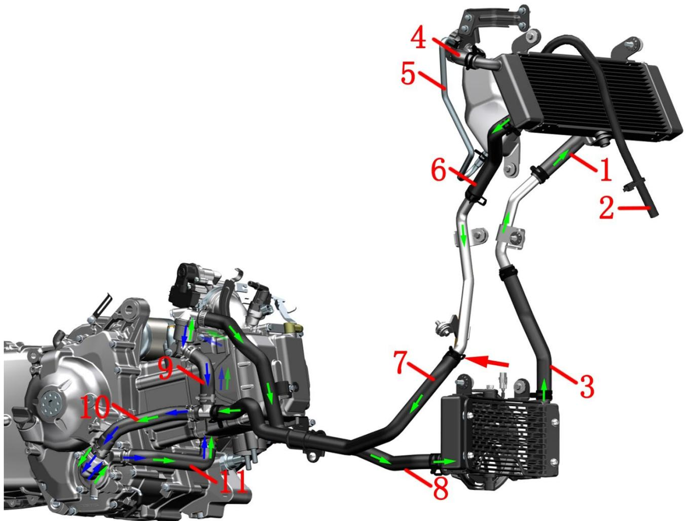
1-主水箱进水管 2-漏水管 3-小水箱出水管 4-加水口水管 5-副水箱连接水管 6-主水箱出水管 7-发动机进水管 8-小水箱进水管 9-小循环出水管 10-水泵盖进水管 11-气缸进水管
