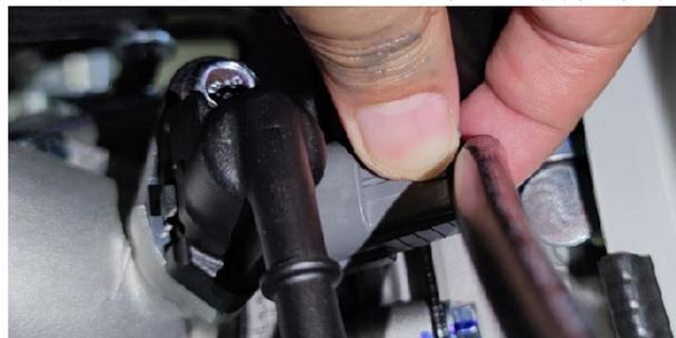
如需更换喷油器，待发动机和消声器冷却后才能进行。底部放置接油容器后，参照拆除高压油管的步骤将燃油泵端的高压油管拔出，将残留的燃油放出。用 10# 套筒拆下螺栓(1)，取下喷油嘴固定器(2)后即可取下喷油器(3)。
