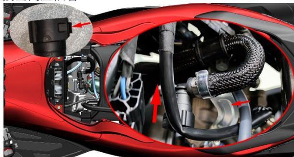
c. 将原车高压油管接上压力表，另外找一根高压油管连接压力表和喷油嘴。
