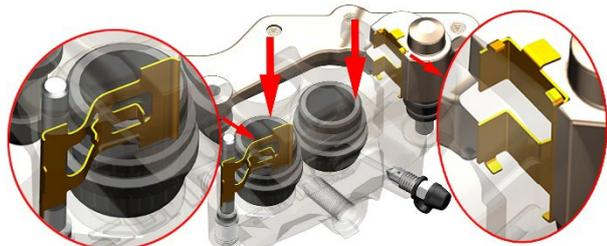
d. 拿出新的制动片装回，需用手顶住制动片底部（通孔端）。注意切勿装反，有 3 条凹槽的一面朝向制动盘；黑色金属背板朝向卡钳。
