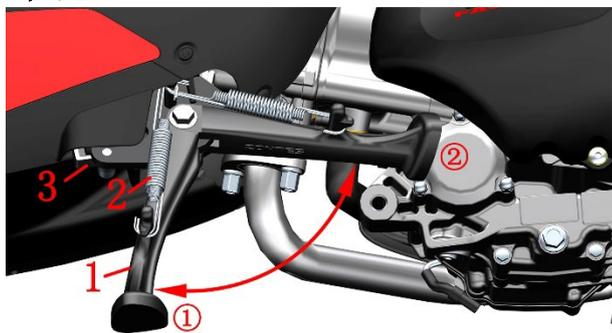
1. 侧支架 2. 侧支架弹簧 3. 侧支架熄火开关
