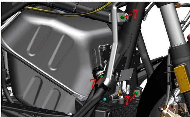
e. 用 8#套筒拆下固定铝进水管的 1 颗 M6×22 螺栓 (7)；固定主水箱左侧上部和小水箱右侧上部的 2 颗 M6×30 螺栓(8)。
