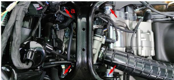
c. 用 4#内六角拆下 M6×14 螺栓。抓住后左脚踏总成后用 12#套筒拆下 2 颗 M8×35 螺栓，将脚踏总成取下。以同样方法拆下后右脚踏总成。
