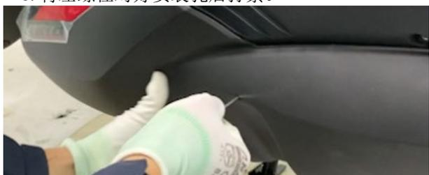
f. 安装其它螺栓前先装外露的海绵塞回左罩内部。
