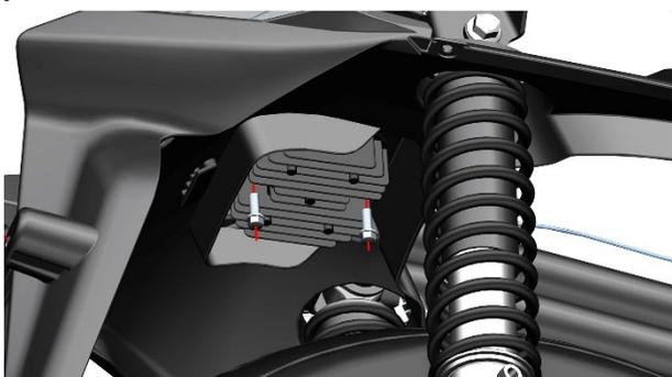
e. 整理好整流器的线束后抓住后内泥板按照箭头指示将后内泥板往下拉，直至车架与后内泥板之间的缝隙足够将整流器的 2 处接头依次穿过后内泥板上预留的孔，**（注意：**后内泥板上的孔位不足以让 2 个整流器接头同时取出，所以需一个接一个的将整流器接头取出。）取出整流器。
