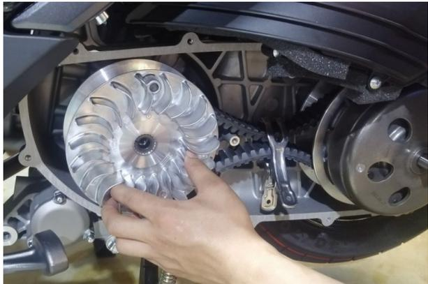
g. 将  $\phi 12.3 \times \phi 40 \times 4$  垫圈套在 M12 $\times$ 1.25 $\times$ 35 六角法兰面螺栓上，然后将 M12 $\times$ 1.25 $\times$ 35 六角法兰面螺栓旋入曲轴螺纹孔内。
