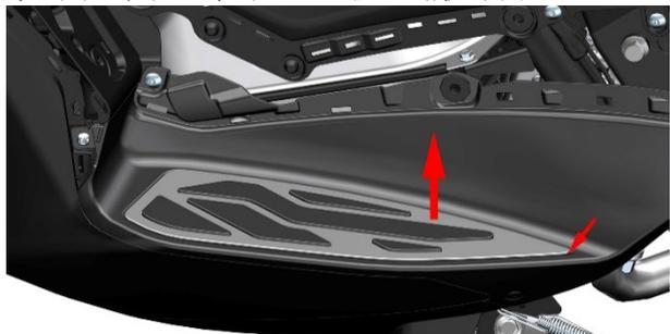
b. 使用 4#内六角拆下左踏板上的 7 处 M6×14 的轴肩螺栓。用 5#内六角拆下左踏板头部 M6×16 的螺栓，取下衬套。
