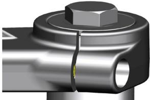
c. 将下联板 2 颗 M8×30 的螺栓装上，使用同样的方法装入另一根减震。
