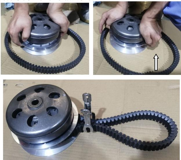
e. 将组合好的从动轮和 V 形传动皮带整体拿起，使从动轮离合器外罩朝向外侧，从动轮中心内孔对准驱动轴后，将从动轮向里推装到位（驱动轴上用于装  $\phi 14.5 \times \phi 25 \times 16$  从动轮衬套的一截光轴露出），并且使 V 形传动皮带的另一部分套在外露的曲轴花键外圈。
