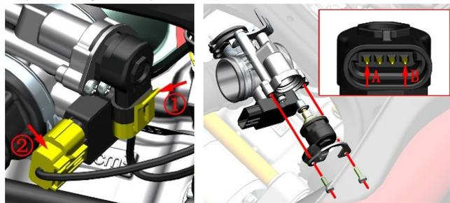
简易测试方法：关电后将步进电机取出，不要松开电缆插头，在开机按下熄火开关，不用打火，查看电机堵头能否来回收缩，最后将熄火开关关闭，查看堵头是否回到原位。
