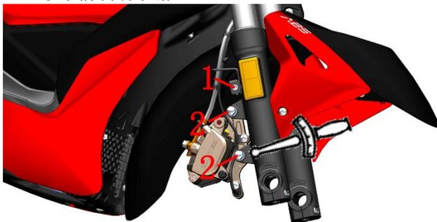
c. 使用 4#内六角拆下前泥板左右两侧的 2 颗 M6×14 的螺栓(3)；再使用 5#内六角拆下 1 颗 M6×30 的螺栓(1)，取下垫片(4)。
