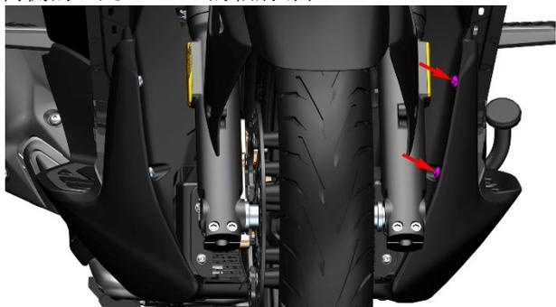
d. 使用 4#内六角拆下包围底板连接左踏板装饰罩的 1 颗 M6×14 的轴肩螺栓；再使用 4#内六角拆下包围底板连接左踏板装饰罩的膨胀钉，左踏板连接包围底板的膨胀钉。
