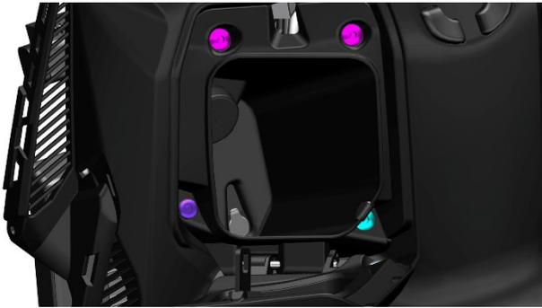
f. 将前左储物盒取出至合适位置，拔下前左储物盒上的 USB 接头，取下前左储物盒。参照右储物盒外盖的步骤将左储物盒外盖拆解。
