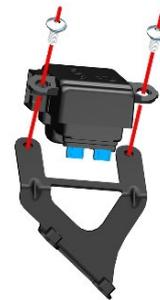
h. 使用 5#内六角拆下 2 颗 M6×16 螺栓后将右储物盒锁支架和右储物盒锁分离。
