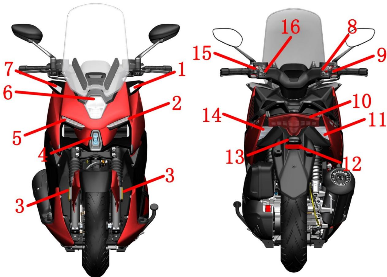
1-左前转向灯 2-左日行灯 3-侧反射器 4-位置灯 5-右日行灯 6-大灯 7-右前转向灯 8-右手把副开关 9-右手把开关
