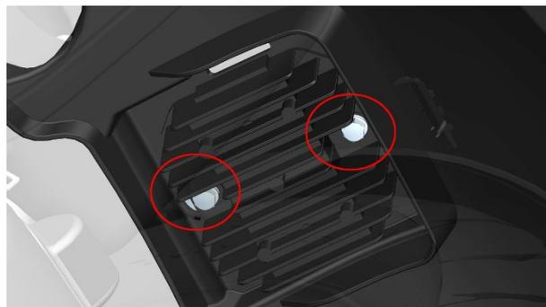
d. 将整流器往下拉，将线缆从后泥板前部的孔中拉出。将整流器从车上拆下。抽出线缆时注意不能强行拉扯以免损坏插头或拉脱导线。
