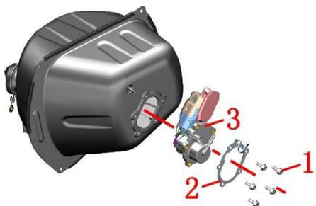
重新装配时需先对角预紧然后再拧紧5颗螺栓，否则燃油泵的密封胶圈压缩不均匀容易导致渗漏造成安全隐患。
