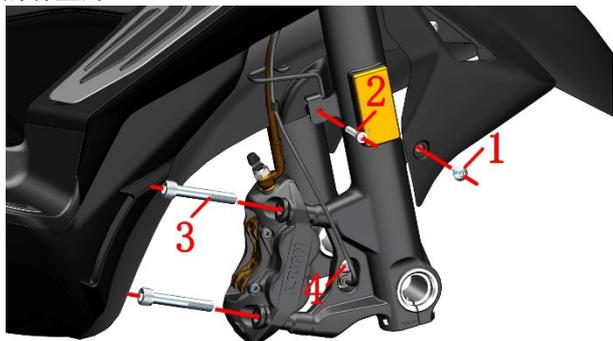
c. 使用 4#内六角拆下前泥板左右两侧的 2 颗 M6×14 轴肩螺栓(1)；再使用 5#内六角拆下 1 颗 M6×30 的螺栓(2)，取出垫片(5)。
