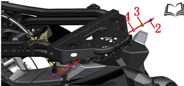
之后生产的用4#内六角拆下M6×14螺栓。
