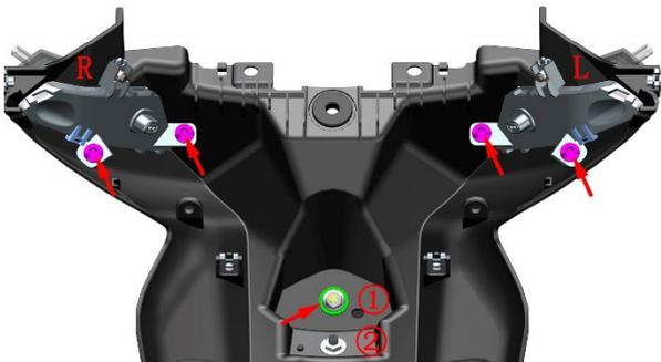
k. 如需更换后挡泥板则需取下 4 件夹板螺母、1 件侧盖圆胶和 1 件后牌照缓冲胶。注意后牌照缓冲往装后牌照的一侧拉出。
