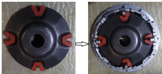
c. 将装好普利珠和斜坡板的主动轮滑动盘整体翻转过来，再将定距筒装入主动轮滑动盘内孔。然后一手捏住滑动盘和斜坡板（防止散开后的普利珠掉落），一手扶着外露的定距筒使定距筒内孔对准曲轴后，将斜坡版、普利珠、滑动盘、定距筒组合整体推进装配到顶住  $23.2 \times \phi 40 \times 3.25$  垫圈。
