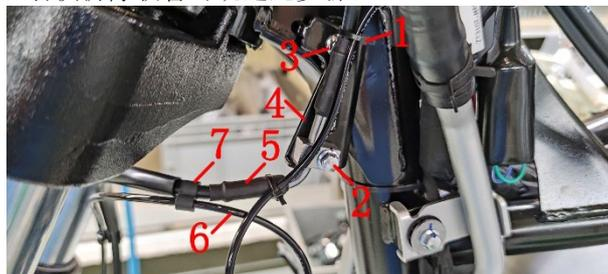
d. 检查取下的软管表面是否有老化龟裂、破损、磨损等不良现象。用无纺布擦拭干净残留的制动液后用保鲜膜或塑料袋将软管两端面包好，防止异物进入。检查轮速传感器线的线缆外皮是否有破损，若有磨破外皮可用电工胶布粘好防止短路。
