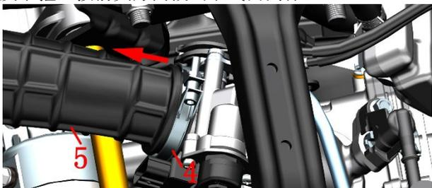
e. 用 5#内六角拆下 2 颗螺栓(6)后将阀体组件从发动机上取下。
