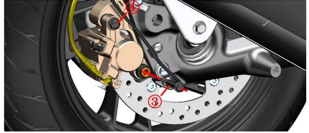
c. 借助工具将活塞按箭头方向推到底。若阻力很大时可参照前刹主泵添加制动液的方法拆下上盖后再推。若卡钳上的弹簧片掉下需按图示方向装回。
