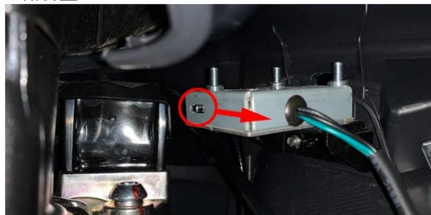
e. 使用 4#内六角拆下上方 2 颗 M6×14 的轴肩螺栓和下方的 M6×16 螺栓；使用 4#内六角拆下固定前左储物盒的 1 颗膨胀钉。
