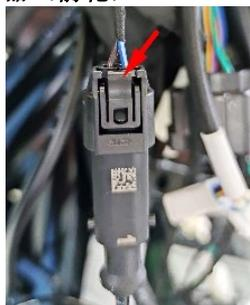
a. 在车架左侧找到轮速传感器的插头，按下防脱卡片后拔出插头。
