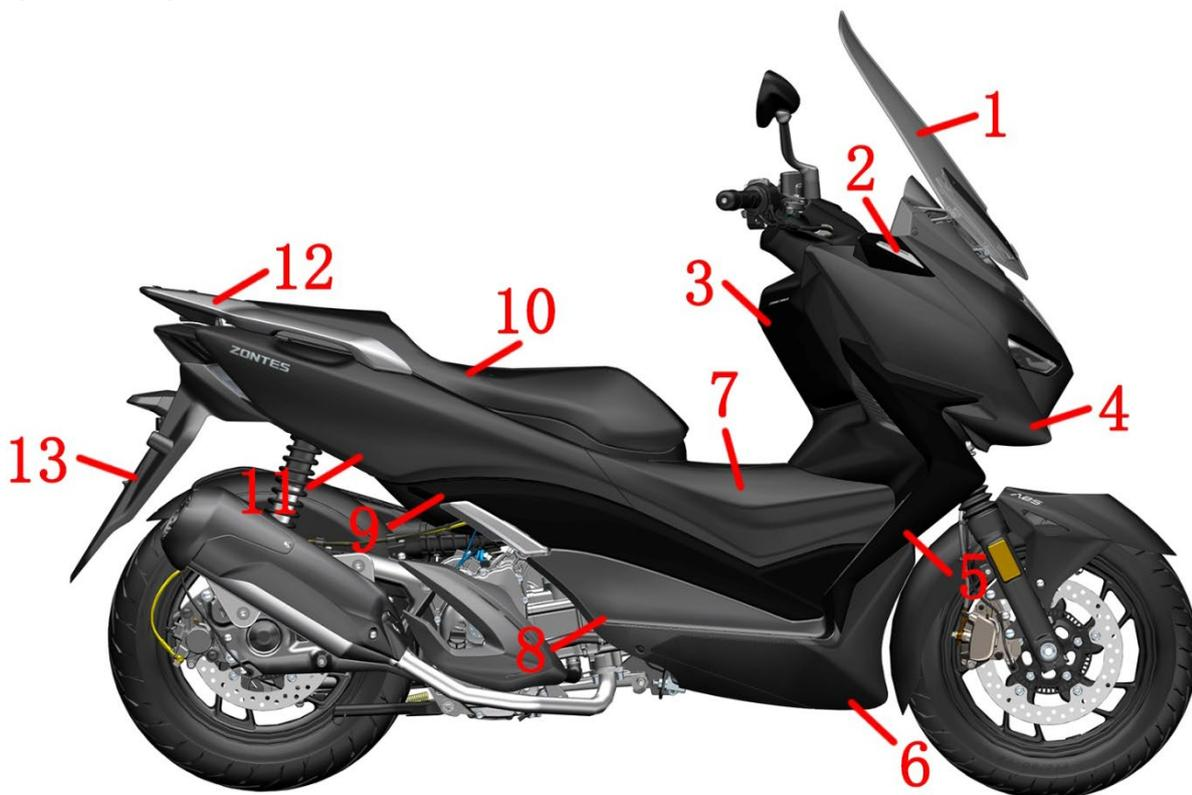
1. 挡风玻璃 2. 右转向灯 3. 前右储物盒 4. 前部右面板 5. 前储物盒面板右装饰罩 6. 右踏板装饰罩 7. 油箱盖板右部 8. 右踏板 9. 右侧盖 10. 坐垫 11. 尾裙右部 12. 后扶手 13. 后挡泥板
