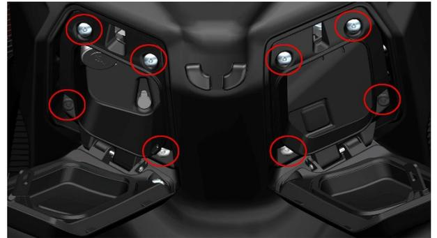
c. 将 10# 梅花扳手从储物盒处的缺口处伸入，拆下龙头锁支座上的 2 处 M6×20 的螺栓，取下龙头锁和龙头锁支座，不需要将龙头锁和龙头锁拆下，放在旁边合适位置即可。
