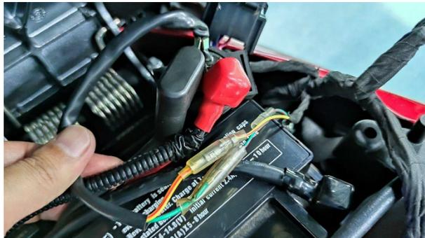
重新安装时继电器黄/红和绿/红线与主线缆线色对应，螺母处不用区分。确保螺母拧紧后将保护帽盖好。
