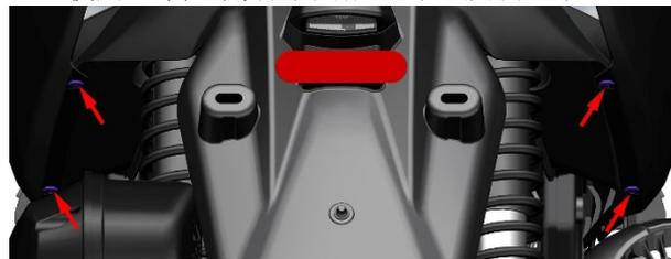
b. 使用 4#内六角拆下固定尾裙前部的两侧共 4 颗 M6×14 的轴肩螺栓。
