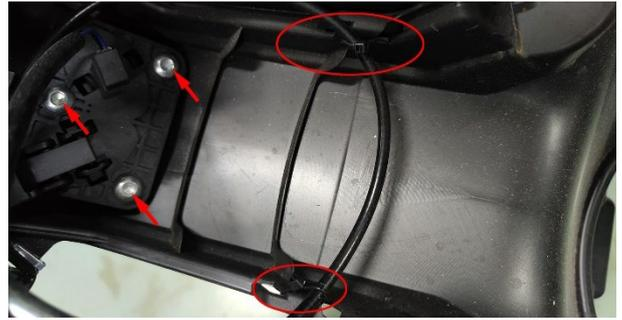
g. 使用 4#内六角拆下 2 颗 M6×14 的轴肩螺栓后将 PKE 支架和 PKE 分离。关于 PKE 的使用和故障现象详见随车配送的驾驶手册。
