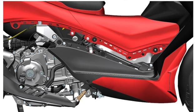
c. 将右踏板螺栓固定螺栓拆除后翻转到背面。用 8# 套筒拆下 2 颗 M6×22 螺栓(1)后将右踏板(2)取下。底下放置接油盘, 用抱箍钳夹住 φ10.5 抱箍(3)后再往箭头方向移开约 40mm (1.6 in), 双手佩戴好防水手套后将副水箱连接水管(4)拔出并将水管内和副水箱内可能残留的冷却液用接油盘承接。
