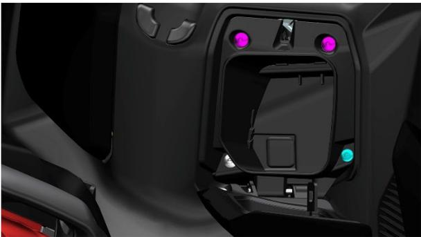
将膨胀钉取下。关于膨胀钉拆装说明详见本章节的服务前须知。
