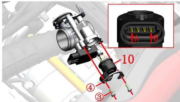
n. 使用节气门清洗剂清理步进电机头部的积碳。往阀体孔内喷入少量清洗剂。禁止用任何液体浸泡步进电机。
