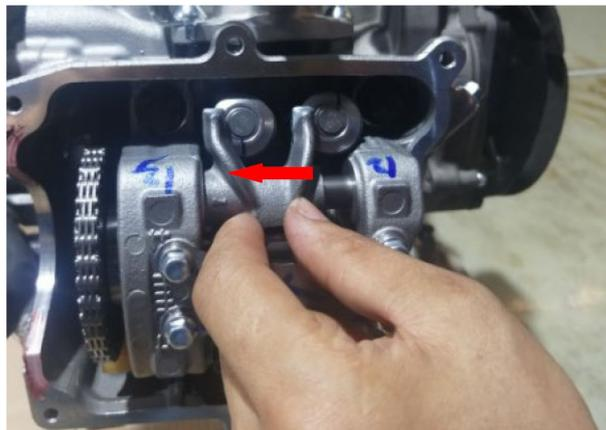
g. 调整垫片较小，取出时容易掉入发动机内部，可以用磁铁棒将原配的调整垫片吸出。然后用镊子放入要更换上去的调整垫片。在更换完同一侧两个调整垫片后须将气门摇臂向火花塞一侧推回，以压住气门调整垫片防止自行滑出。然后按同样的方法更换另一侧气门间隙调整垫片。
