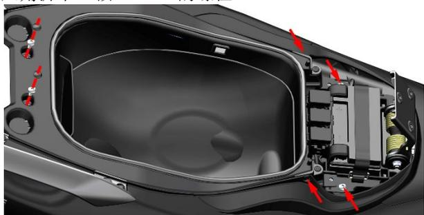
d. 将置物箱微微抬起，直到置物箱左侧露出氛围灯接头，拔下接头后将整个置物箱取出。
