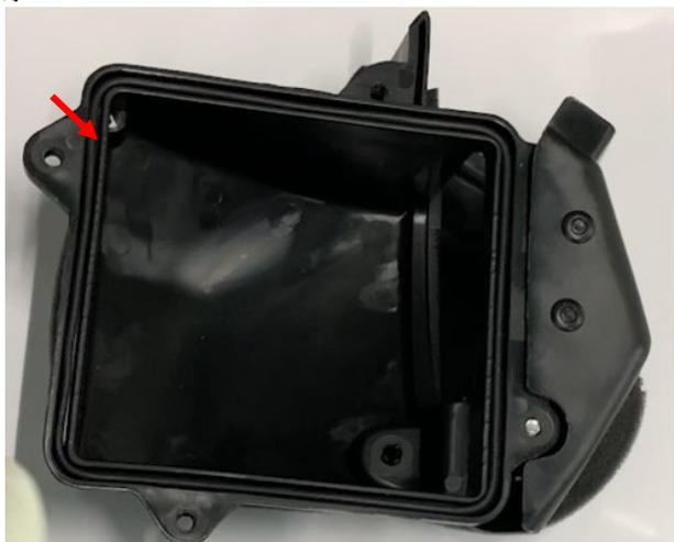
b. 换上 2 根新的胶条（一根装在进风口盖，一根装到箱体）。拿出新的进风口滤芯按图示方向装入进风口盖。
