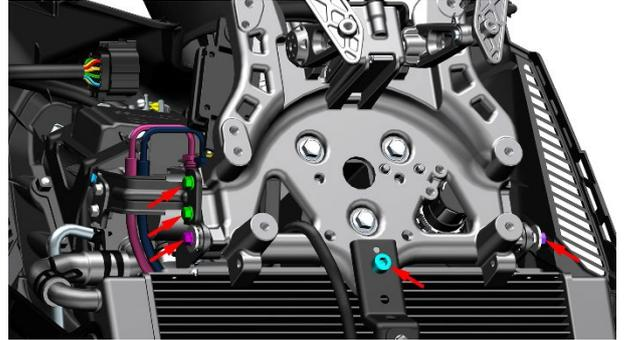
c. 抓牢风挡基座组件后用 12#套筒拆下 3 颗 M8×25 螺栓，将风挡基座组件从车辆上取下。
