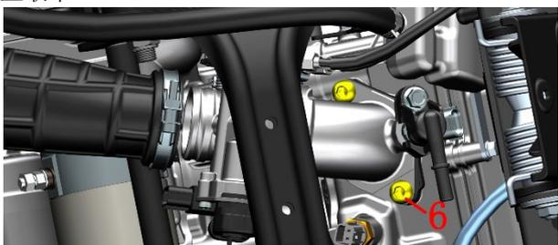
f. 将隔热垫和 O 环组件取下，取下 O 环(10)。用 4#内六角松开卡箍(9)后将进气歧管与阀体组件分离。用 2 把 10#开口扳手将加油线(8)的两个螺母松开后往外拉出从支架中取下；将油门线圆柱头从转盘上取出。回油线(7)的两个螺母松开后将底部的螺母完全松出螺纹套管后再往轴心方向拉出支架，不能直接往外拉，将回油线圆柱头从转盘上取出。
