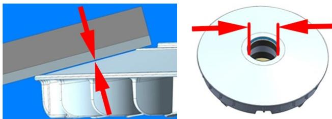
b. 用游标卡尺或外径千分尺测量定距筒外径。直径  $\leq \phi 34.9\text{mm}$  (1.374 in) 时需要更换。
