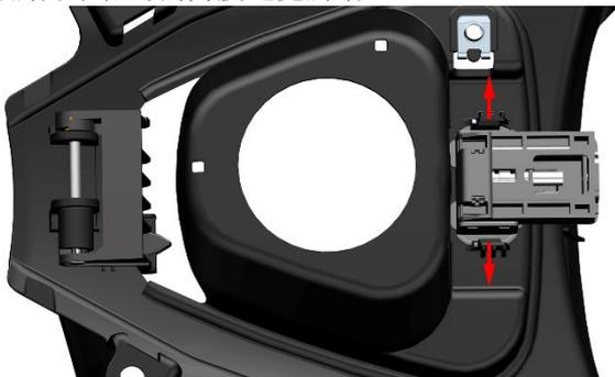
f. 用尖嘴钳取下卡簧后将旋转轴抽出。将扭簧和阻尼取下。安装时注意扭簧的位置。
