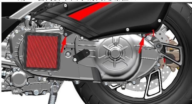
c. 用尖嘴钳将空滤器尾部内侧的废气管卡箍夹住再往上移动约 20mm (0.8 in)。再用手将废气管拔出曲轴箱。
