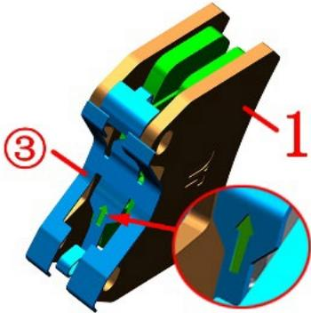
i. 用手将箭头(8)所指处的片体向箭头方向往里按住，将用销轴(2)插入孔位固定住制动片(1)。用 T25 内六角梅花扳手上紧销轴(2)。
