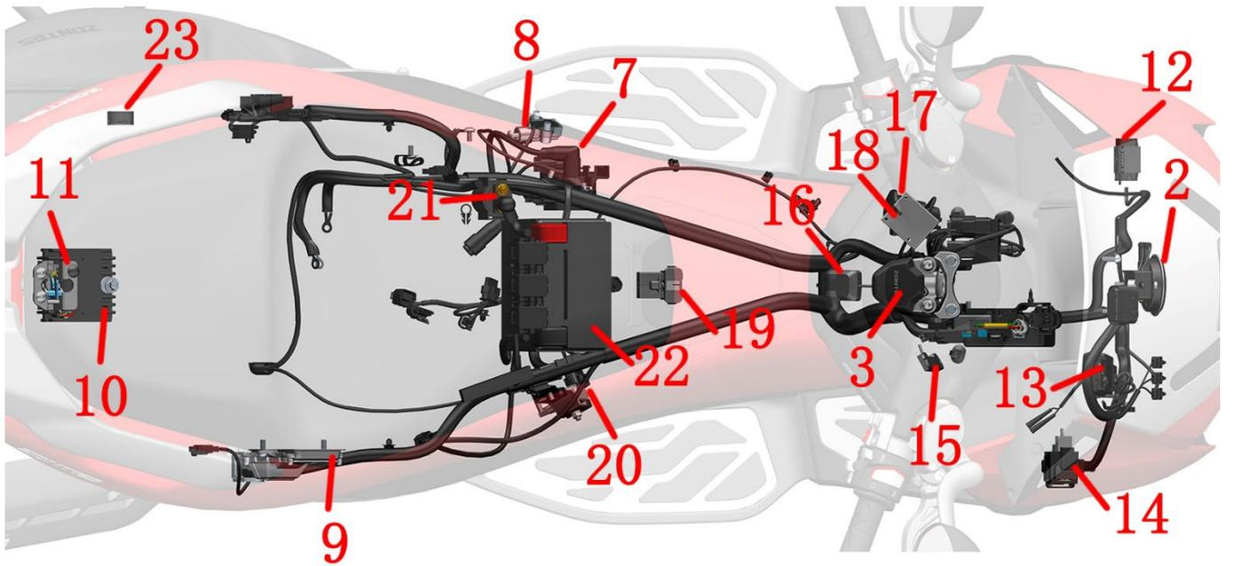
1-TFT 仪表 2-喇叭 3-龙头锁 4-充电口座 5-PKE 6-主电缆 7-电喷高压线 8-侧支架熄火开关 9-发动机控制器 (ECU)
