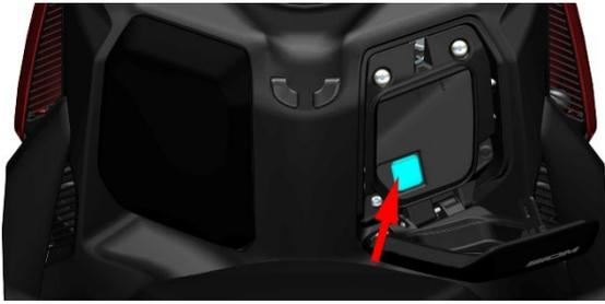
c. 将车辆扶正借助手电筒观察副水箱液面是否在“H”和“L”之间。注意地面尽量平整水平，不要在斜坡上检查。并且发动机需处于冷机状态。
