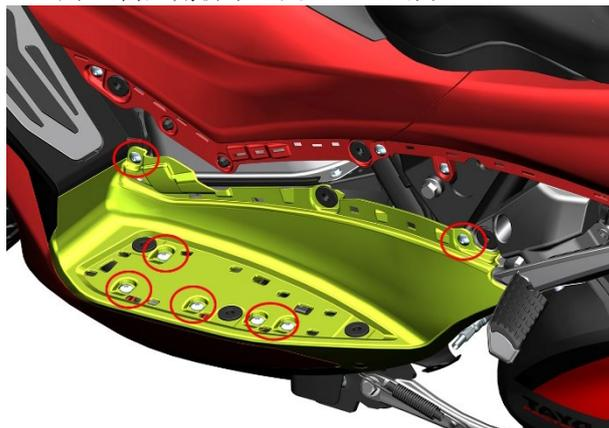
i. 用 4#内六角将左侧 4 处膨胀钉中心圆柱销按下，然后将膨胀钉取下。用 4#内六角拆下左前部的 2 颗 M6×14 螺栓。关于膨胀钉拆装说明详见本章节的服务前须知。2022 年 5 月 18 日之前生产的 M310 车辆左侧有 4 件膨胀钉，之后的车辆为 3 件；5 月 18 日当天生产的需注意区分。
