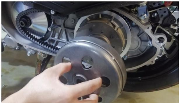
g. 捏住 V 形传动皮带的中间部位，将皮带和从动轮皮带盘一起取下。
