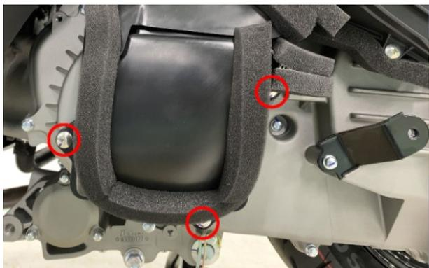
c. 将进风口盖和进风口滤芯一起取下。取下箱体上的胶条。
