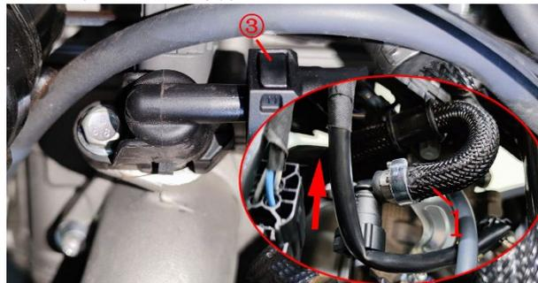
c. 在阀体底部找到卡簧(2)用手捏住卡簧两端往外移
