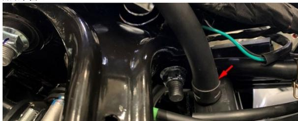
l. 使用 4#内六角拆下后摇臂上固定轮速传感器的 1 颗 M6×16 的螺栓，取出轮速传感器并将其从固定线夹上取出。再使用 14#套筒拆下固定制动卡钳的 2 颗 M8×37 的螺栓，将制动卡钳和轮速传感器从减震中间按箭头方向穿过。
