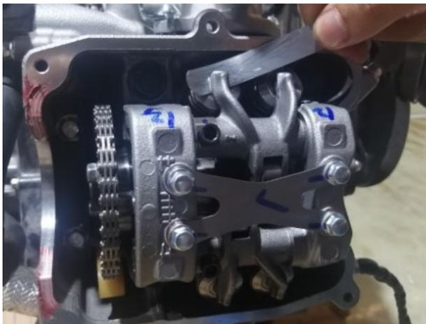
f. 将进气门摇臂和排气门摇臂推向正时从动链轮一侧，露出气门调整垫片。然后根据气门间隙标准值（进气门：0.08~0.12mm(0.003~0.005 in)，排气门：0.18~0.22mm(0.007~0.009 in)）来确定需要更换的调整垫片的规格。例如：测得左侧的进气门间隙值为0.04mm(0.002 in)，小于标准值。则需要增加0.04~0.08mm(0.002~0.003 in)的间隙。发动机上原配的调整垫片厚度规格为2.36mm(0.093in)，则需要将调整垫片更换为2.28~2.32mm(0.09~0.091 in)的。按此方法分别确定好四处气门需要更换的调整垫片规格，并对应之前做的记录放置，防止混用。
