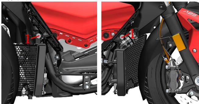
h. 用抱箍钳松开抱箍后, 将散热器组件分解。各抱箍分布图见下图。
