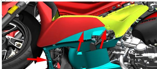
d. 一手将前部（靠前轮处）中心的包围底板往下拉，一手往后轮方向抽约 20mm(0.8 in) 后再将包围底板往下拉。小图所示处有支架故无法直接往下拉。
