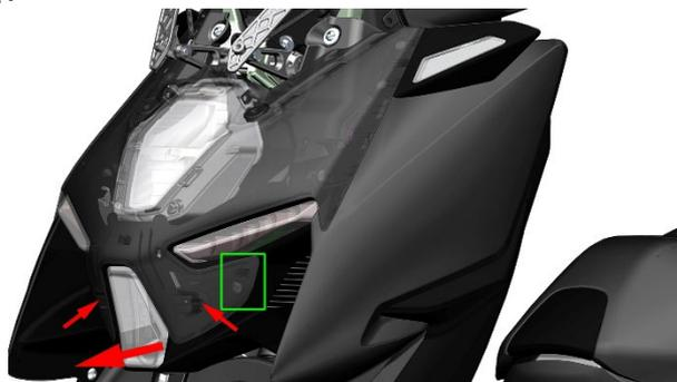
c. 用手抓住前部前盖板标记处（绿色矩形），按照箭头方向往上拔，直至将前部前盖板的 2 处定位扣（蓝色圆圈）以及前部前盖板两侧（黄色区域，左右各 6 处）的 12 处扣位拔出，取下前部前盖板。
