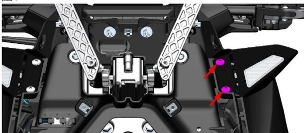
b. 使用 4#内六角拆下前左转向灯上方的 1 颗膨胀钉；使用十字螺丝刀拆下前左转向灯后上方的 1 颗 ST4.2×12 自攻钉。
