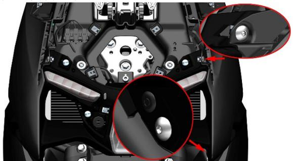
b. 两手抓住前部左面板标记处（绿色矩形），按照大箭头方向小心往外拔，拔的时候需要按照小箭头的指向顺序依次将前部左面板与前部通风口、前储物盒左面板装饰罩、前储物盒前面板上的连接处（黄色区域；前部通风口 4 处，前储物盒左面板装饰罩 1 处+1 个蘑菇扣，前储物盒面板 6 处）的 11 处扣位、1 处蘑菇扣（蓝色区域）分离，取下前部左面板。
