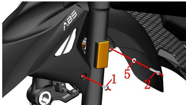
d. 先按照小箭头按住前泥板两侧，将前泥板箭头处的凸起往里按，再将前泥板往上移动至合适部位后按照大箭头方向抽出。
