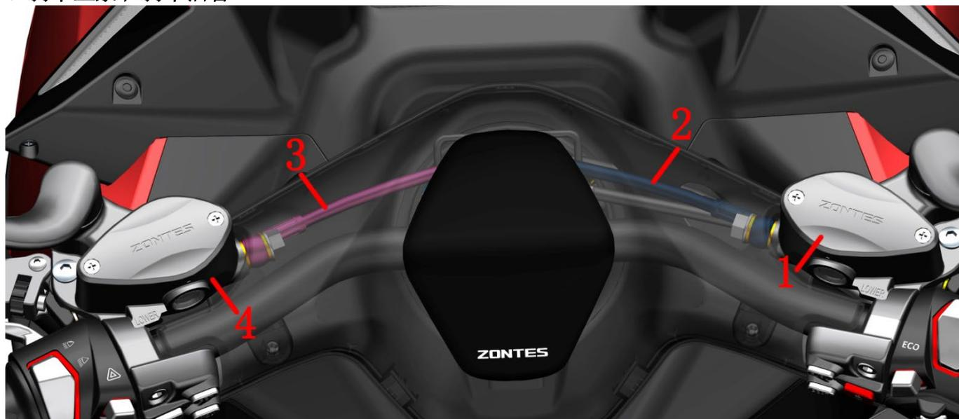
1-前碟刹主泵 2-FMC-HU 制动软管 3-RMC-HU 制动软管 4-后碟刹主泵
