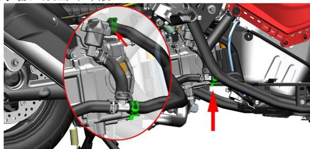
b. 拔下发动机头部的高压包插头。
