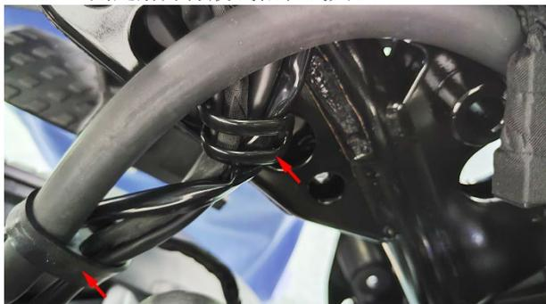
c. 用 4#内六角逆时针松开图示的卡箍螺栓,将空气滤器出气管往后轮方向拉出节气门阀体。
