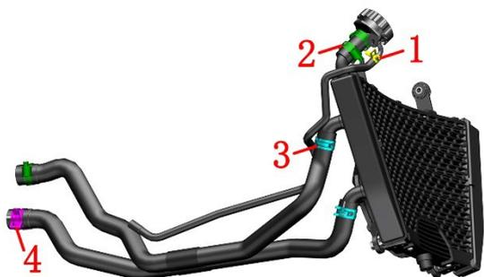
1-水管抱箍 ( $\phi 9$ ) 2-水管卡箍 ( $\phi 26$ ) \*3 3-水管抱箍 ( $\phi 24$ ) \*2 4-水管抱箍 ( $\phi 26$ )
