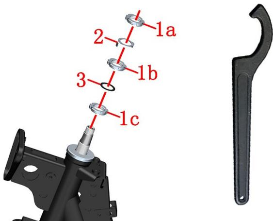
c. 若转向较重则逆时针松开调节螺母(1c)。先顺时针拧到 35N.m(3.6 kgf.m, 26 lbf.ft) 后逆时针松 1/4 圈，然后再拧到 15N.m(1.2 kgf.m, 11 lbf.ft)。
