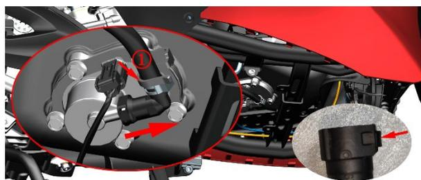
若需从车辆上拆下燃油泵，可用抽油泵将燃油箱内的燃油抽空。将车辆举升后按下图示的插头卡扣将线缆拔出。从底部用 10# 套筒拆下 5 颗螺栓，取下高压油管支架后即可拆下燃油泵。
