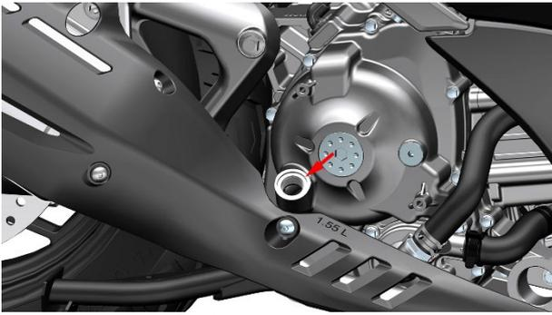
d. 检查 O 环(2)是否有破损、老化, 如无则擦拭干净, 如有则需更换。机油尺所用 O 环规格为:  $18 \times 3 \times 3.5$ 。
