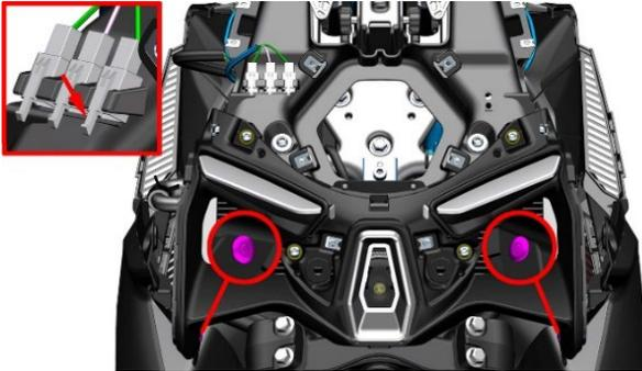
b. 使用 5#内六角拆下前部通风口上的 4 处 M6×14 的轴肩螺栓。取下前部通风口及安装在通风口上的位置灯等零件。**注意：**拆最后一颗螺栓时必须用手托住前部通风口，防止前部通风口直接掉落，刮伤漆面。
