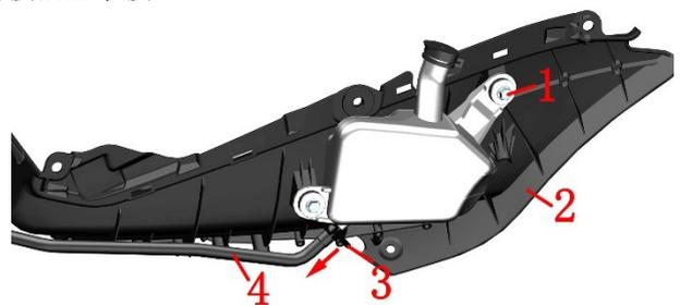
d. 用抱箍钳夹住 φ26 抱箍(5)后再往箭头方向移开约 40mm (1.6 in), 将主水箱出水管拔出。
