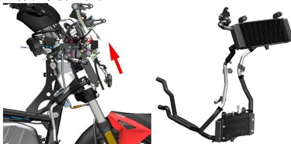
j. 若有需要拆下加水口固定支架的可用 8#套筒拆下螺栓(17)。抓住支架(18)后用 8#套筒拆下螺栓(7)，将主水箱下安装支架(18)取下。
