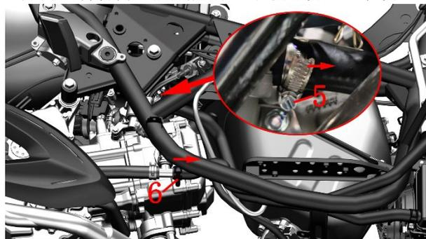
c. 按下箭头指示的卡扣将小水箱散热风扇插头拔下。
