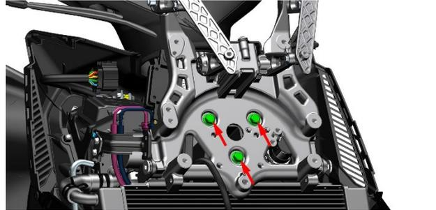
d. 使用 4#内六角拆下 2 颗 M6×16 螺栓，取下翻边衬套。将风挡控制器取下。
