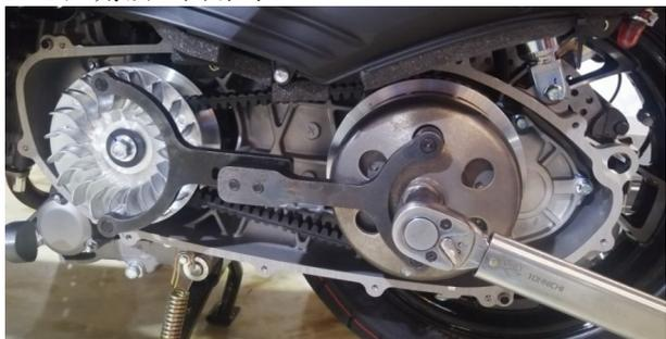
d. 取下 M12×1.25×35 六角法兰面螺栓和  $\phi 12.3 \times \phi 40 \times 4$  垫圈。然后取下 M14×1 六角法兰面螺母和  $\phi 14.5 \times \phi 25 \times 16$  从动轮衬套。
