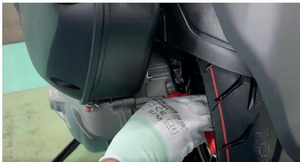
d. 一手将空滤器尾部往外拉，一手将后内泥板往里压。将空滤器与后内泥板分离。
