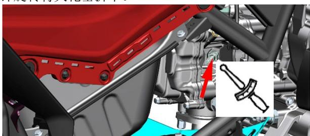
n. 建议用美纹纸或其它软质塑料袋等将火花塞安装孔封好，避免异物进入发动机内部。
