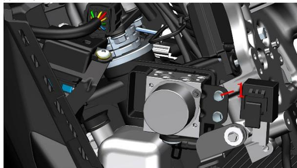
e. 抓牢液控单元后用 4# 内六角拆下 M6×16 螺栓(2)，即可将液控单元(5)拆下。如需更换支架(4)，则需将翻边衬套(3)和缓冲胶(6)取下。
