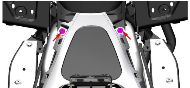
b. 使用电池连接主线束上的正负极将车辆开机打开油箱锁或者拆卸电池前打开油箱锁; 使用 4#内六角拆下固定油箱盖的 1 颗 M6×16 的螺栓, 拧松螺纹油箱盖。
