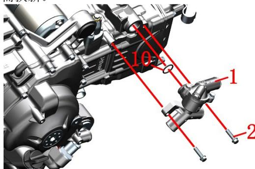
重新装配前应清理干净结合面, 注意 O 环不能漏装并且需要正确装配到位。抱箍应卡到凸台内部防止松脱。螺栓(2)扭力: 12 $\pm$ 1.5 N.m (1.2 $\pm$ 0.2 kgf.m, 9 $\pm$ 1 lbf.ft)。
