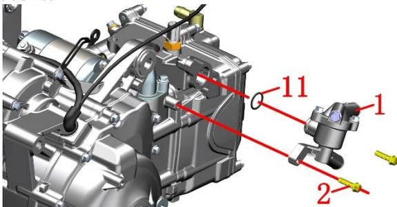
重新装配前应清理干净接合面, 注意 O 环不能漏装并且需要正确装配到位。抱箍应卡到凸台内部防止松脱。螺栓(2)扭力: 12±1.5 N.m (1.2±0.2 kgf.m, 9±1 lbf.ft)。
