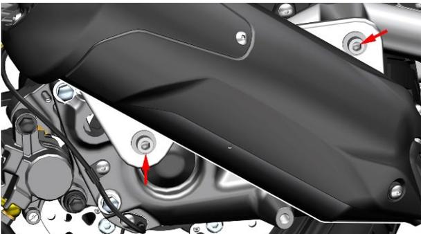
托住消声器后使用 8# 内六角拆下消声器的消声腔与后摇臂连接的 2 处螺栓，取下 2 件  $\phi 10.5 \times \phi 24 \times 2$  垫片后将消声器组件取下。早期生产的车辆没有垫片可自行加装。
