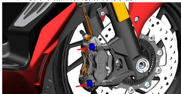
e. 将前刹卡钳组件拉出，检查制动片磨损情况。如已磨损或接近磨损到极限位置则需成对更换新的制动片。
