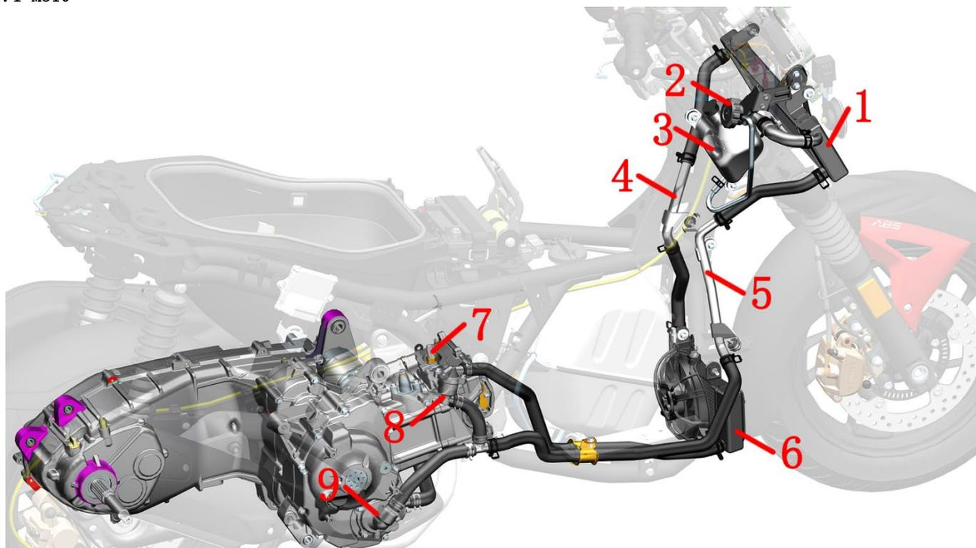
1-主水箱 2-水箱加水口 3-副水箱 4-铝进水管 5-铝出水管 6-小水箱 7-水油共用传感器 8-节温器 9-水泵盖组件
