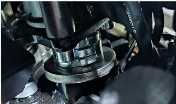
b. 为便于讲解此处隐去其它零部件。先用 38-42 的厚度在 6mm(0.24 in) 内的勾形扳手松开调节螺母(1a)；将防松垫圈(2)往上移再松开调节螺母(1b)。
