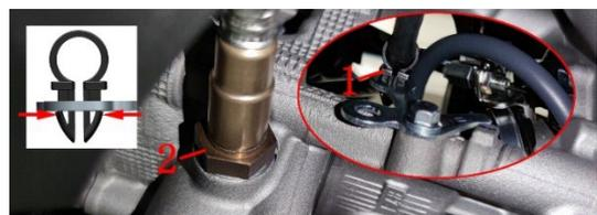
新的传感器螺纹处涂有专用的膏状的螺纹防烧剂, 防止漏气和便于后续再次拆卸。若拆下旧的检查没问
