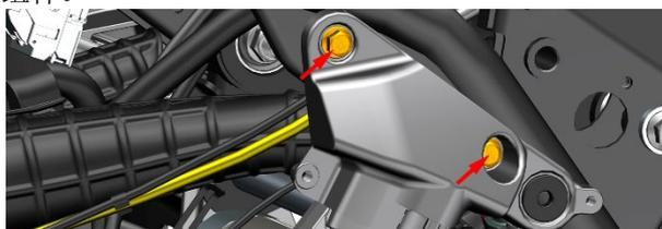
b. 一人使用 17#梅花扳手从空滤器前方伸入固定车辆左侧固定发动机的 M12 的螺母，另一人使用 15#套筒拆下车辆右侧固定发动机的 M12×1.25×290 的螺栓，将螺栓从车架中抽出。
