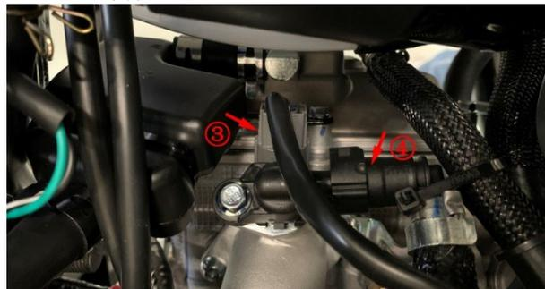
e. 在右侧的车架位置找到并拔下曲轴位置传感器⑤、氧传感器⑥的插头。**注意：**曲轴位置传感器一端连接发动机内部，一端连接主电缆；氧传感器一端连接消声器前部的发动机，一端连接主电缆；不要拔错插头。
