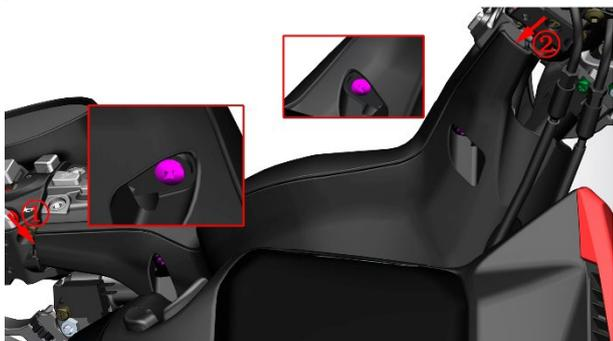
c. 使用一字螺丝刀从方向把中罩的孔中将方向把上罩的 3 处扣位③、④、⑤挑开, 用手抓住靠近坐垫一边的方向把上罩③按箭头方向取下方向把上罩③。
