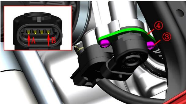
简易测试方法：关电后将步进电机取出，不要松开电缆插头，在开机按下熄火开关，不用打火，查看电机堵头能否来回收缩，最后将熄火开关关闭，查看堵头是否回到原位。
