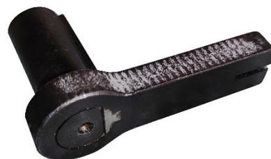
将转子从发动机上拆下，将飞轮检具按图 1 所示装好，检查转子侧面的标记线是否在开槽内（如图 2）。
