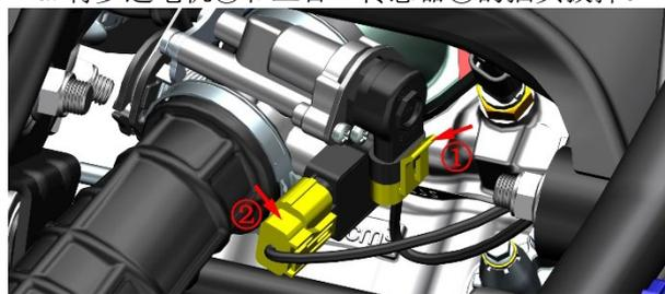
b. 将小型容器放置在高压油管底下，按下③指示的卡扣同时按箭头方向拔出高压油管(1)。拔出时会有少量燃油流出，禁止滴落到零件表面。
