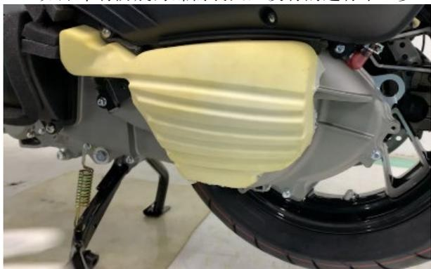
d. 将 M6×14 轴肩内六角螺栓卡在发动机左罩内侧台阶孔处，再用 4#内六角从外侧穿入后顶住螺栓。
