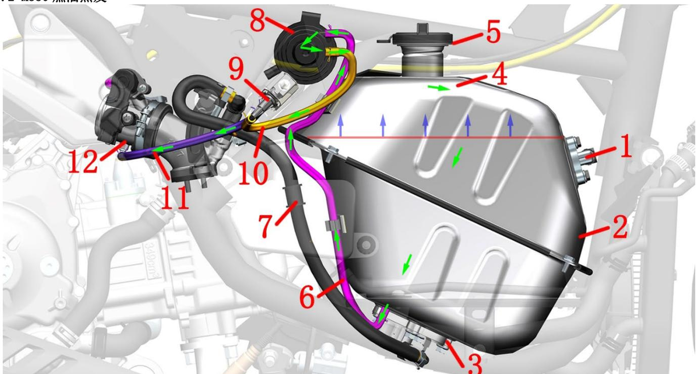
1-油位传感器 2-燃油箱 3-燃油泵 4-油气分离器（焊接在油箱内部） 5-油箱盖 6-吸附/通气管 7-高压油管 8-碳罐 9-碳罐电磁阀 10-电磁阀进气管 11-电磁阀出气管 12-节气门阀体组件
