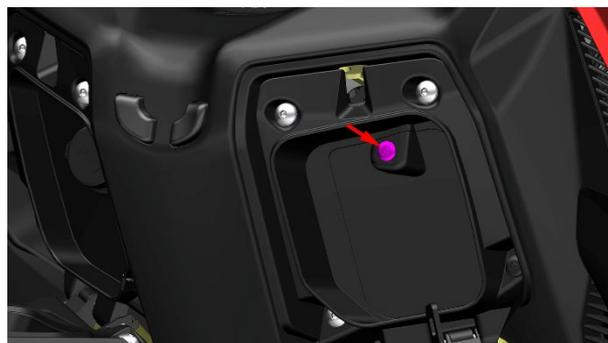
将 OBD 插头拉出，接上诊断仪读取故障代码。OBD 插头不同批次颜色可能不同，有黑色和白色两种颜色，功能相同。如果 OBD 插头有保护盖则需先取下。
