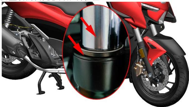
b. 检查底筒是否掉漆；前挡泥板、前轮空心轴和前刹卡钳的安装点是否断裂或开裂的迹象。检查底筒底部是否有渗漏。
