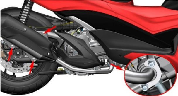
托住消声器后使用 14# 套筒拆下消声器的消声腔与后摇臂连接的 3 处螺栓，将消声器组件取下。
