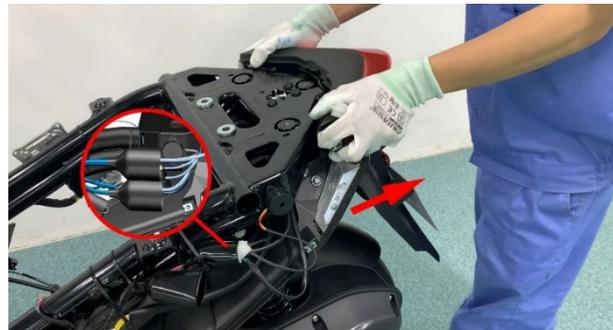
e. 4 根手指握住尾灯盖板，拇指用力往箭头方向将盖板卡扣推开。同样的方法将另一侧的卡扣推开。两侧卡扣推开后一手握紧尾灯，一手将握紧盖板中部用力往上掰开。将盖板和尾灯分离。注意中部有魔术扣故需用较大的力才能掰开。
