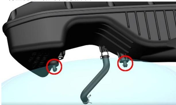
e. 用 8# 套筒拆卸图示的 12 颗 M6×30 六角法兰面螺
