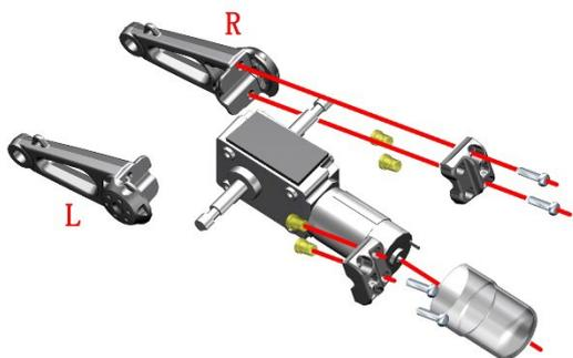
h. 用 6# 内六角拆下 M8×16 螺栓，取下垫片、轴承和上摇臂。
