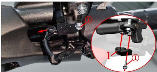
前刹车开关更换步骤与后刹车开关一致，需将油门线移开便于拆下螺栓①。
