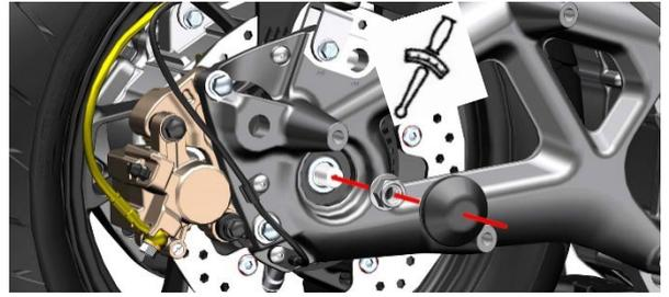
c. 用 4# 内六角拆下后内泥板右侧中部的 M6×14 螺栓 (2)，用 4# 内六角拆下前部的 M6×12 螺栓(1)和后部的 M6×16 螺栓(3)。拆下后摇臂底部的 1 颗 M6×12 螺栓(1)和 1 颗 M6×16 螺栓(3)，将轮速传感器(4)移开。将箭头指示的 3 处卡钉拔出后取下发动机右盖装饰罩(5)。
