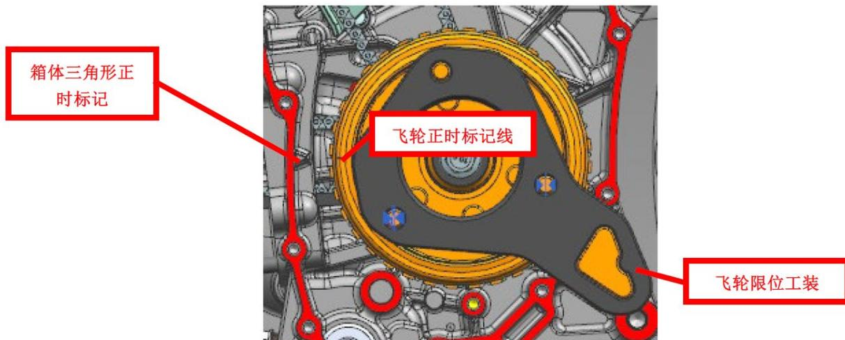
b. 拉紧正时链条，再次检查并使飞轮“T”标记过后紧挨的划线和箱体三角形标记对齐。
