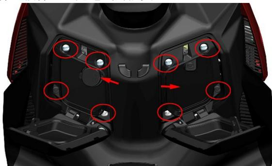
b. 将方向把打至最左，使用 6#内六角拆下 M8×30 的螺栓。用相同方法，将方向把打至最右拆下螺栓。用一字螺丝刀撬开上联板上的缝隙。
