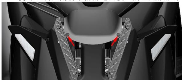
b. 用手扣住前部遮阳板标记处 (绿色矩形), 按照箭头方向往上拔, 取出前部遮阳板。
