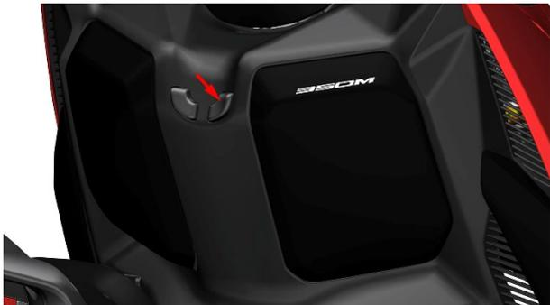
用 4#内六角按下膨胀钉中心圆柱后将膨胀钉取下。将盖板拉出，注意盖板背面粘贴无电感应天线不能强行拉扯。
