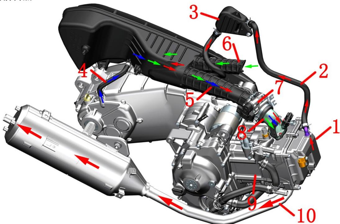
1-缸头 2-缸头废气管 3-外置油气分离器 4-齿轮箱废气管 5-空滤器出气管 6-空滤器进气管 7-节气门阀体组件 8-进气歧管 9-气缸 10-消声器
