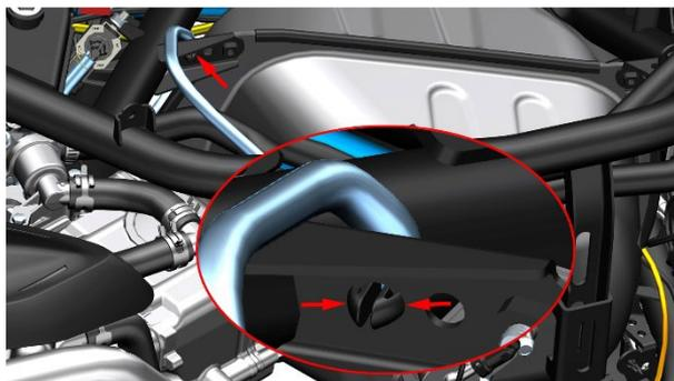
f. 用 10# 套筒拆下固定油箱的 4 颗 M6×12 螺栓 (1)。
