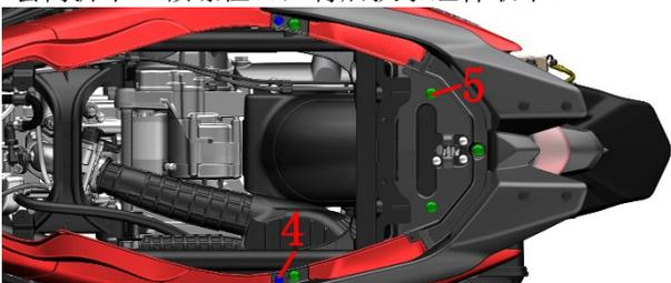
d. 用 4#内六角拆下左侧尾裙前部的 M6×14 螺栓。拆下底部的 2 件膨胀钉。
