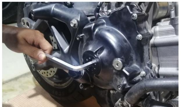
1. 至此完成气门间隙的调整操作。
