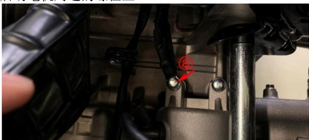
h. 使用 10#梅花扳手拆下启动电机上的 1 颗螺母，取出连接启动电机的正极线⑨。
