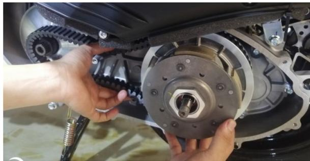
h. 捏住主动轮滑动盘和里面的斜坡板，连同定距筒一起取下。
