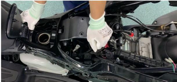
e. 将固定油箱锁的卡扣往两侧掰开后取下油箱锁，注意掰开卡扣时的力度避免掰断。
