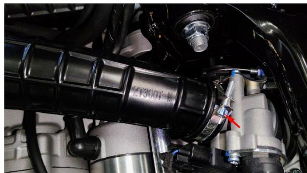
d. 将出气管往车辆右侧拉开露出固定起动电机的两颗 M6×30 螺栓,用 8#套筒拆下。取下螺栓后按大箭头指示的方向将起动电机从发动机上取下。
