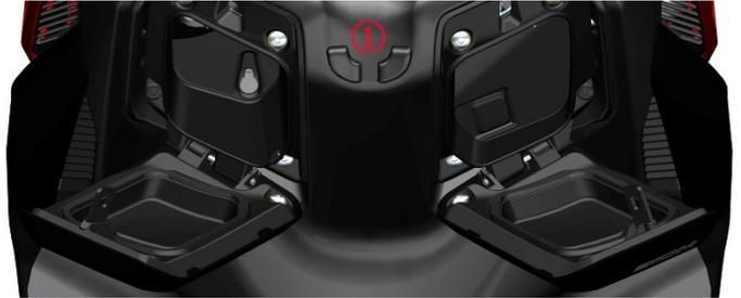
b. 用 4# 内六角拆下右储物盒上方的 2 颗 M6×14 轴肩螺栓，下方的 1 颗 M6×16 螺栓，1 颗膨胀钉。将右储物盒组件取下。同样的方法拆下左储物盒组件，左储物盒还有线路连接，不可大力拉扯，放置脚踏板处即可。
