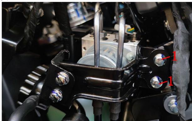
c. 参照前面放出制动液的步骤，将 4 根软管接头拆下并将线缆接头拔下。
