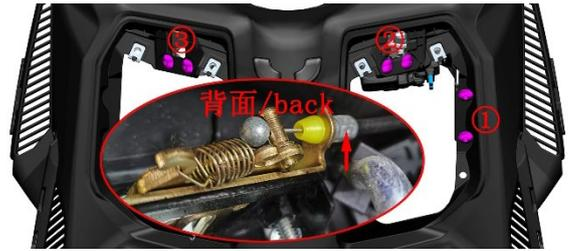
f. 翻转到背面剪断 2 根扎带后用 5#内六角拆下 3 颗 ST4.2×12 自攻钉后，将前储物盒开关从面板上取下。将拉锁从开关上取下。
