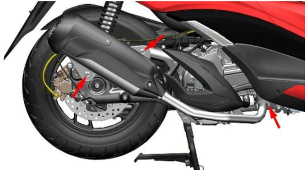
托住消声器后使用 14# 套筒拆下消声器的消声腔与后摇臂连接的 2 处螺栓，将消声器组件取下。
