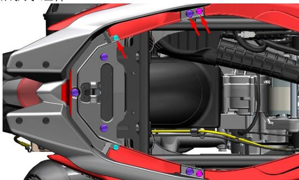
b. 将右后脚踏放下后用 4# 内六角拆下 M6×14 螺栓。
