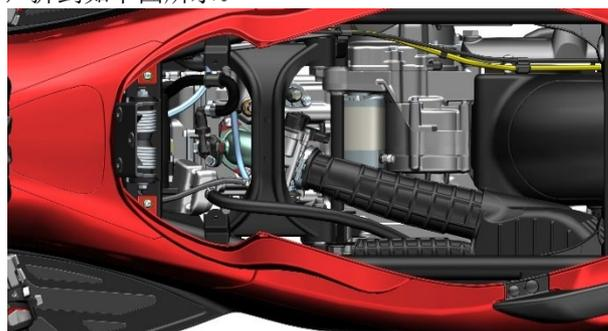
b. 拆下 4 颗膨胀钉后用 4# 内六角拆下两侧的 M6×14 螺栓。
