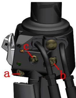
d. 使用 5# 内六角拆下左手把开关下方的螺栓 a 和 b, 再使用十字螺丝刀拆下螺栓 c, 将左手把开关上、下部分开。
