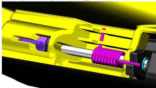
c. 用 4#内六角拆下 3 颗 M6×14 的轴肩螺栓，将内外盖分离。从外盖上取下 3 件夹板螺母。泡棉通过双面胶粘贴在内盖上。
