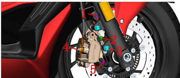
b. 佩戴好防水手套后用 12# 套筒松开螺栓(4)，将卡钳倒放让螺栓(4)头部朝下将制动液排到接油盘中。取下螺栓(4)和铜垫(6)后移开 FC-HU 油管，参照添加制动液步骤拆下前碟刹主泵上盖加快制动液排出。注意不能让制动液污染制动片。
