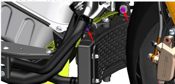
b. 拆下两侧的膨胀钉后，将导风板凸出的安装部分往后掰开再往下取下。如不方便操作则用 10# 套筒拆下固定油箱的 4 颗 M6×12 螺栓再取下导风板。
