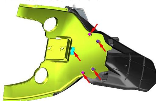
i. 4#内六角拆下两侧的 2 颗 M6×14 的轴肩螺栓。
