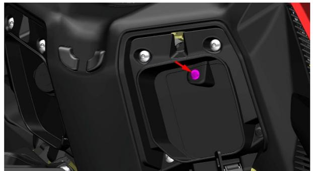
拔掉 PKE 保险，掀开胶塞插入原厂标配的充电器 DC 插头。再将 AC 座插入 110-220V 电源。充满后需插回保险。如使用劣质充电器导致电池损坏的不在三包范围。
