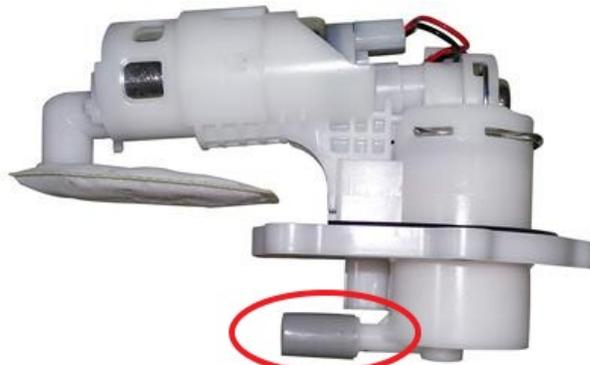
重新装配时需先对角预紧然后再拧紧 5 颗螺栓，否则燃油泵的密封胶圈压缩不均匀容易导致渗漏造成安全隐患。
