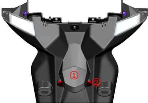
j. 翻转到背面用 5#内六角拆下上部的 ST4.2×12 自攻钉后将后右转向灯 (R) 和后左转向灯 (L) 取下。握紧后牌照灯①后用 10#套筒拆下自带的螺母后, 取下 φ6 垫片。握紧后反射器②后, 用 10#套筒拆下自带的螺母和垫片后取下。
