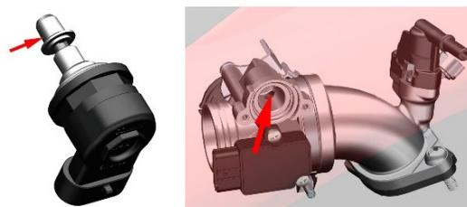
o. 将步进电机装回阀体上，注意不能漏装密封圈。将插头插回。
