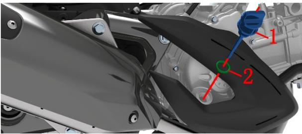
e. 擦拭干净机油尺，用手顺时针旋转将机油尺(1)和 O 环(2)装回发动机右曲轴箱盖。
