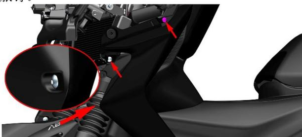
b. 使用一字螺丝刀从小箭头所指位置撬出前左踏板胶垫和前左踏板铝垫，再按照大箭头方向将前左踏板胶垫及前左踏板铝垫向上拔出。**注意：**使用一字螺丝刀撬时可使用无纺布等工具包裹住一字螺丝刀，防止划伤漆面。
