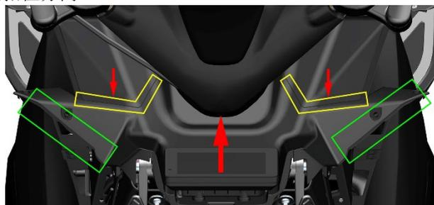
c. 一手抓住仪表面板按照大箭头方向轻微抬起，一手拔下连接仪表的仪表插头，**注意：**拔插头时需先用手手指按住插头反面箭头所指的锁扣，再往外拔下插头，不可直接拔下仪表插头；最后抓住仪表面板两侧往大箭头方向抬并往外拉取出仪表面板。
