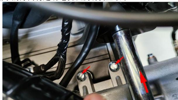
e. 复装时注意不能遗漏起动电机自带的O环,要对准电起启动减速齿轮的齿。注意O环需正确装配进箱体,如发生切边会导致渗漏。固定起动电机的两颗螺栓扭力:  $12 \pm 1.5 \text{ N.m}$  ( $1.2 \pm 0.2 \text{ kgf.m}$ ,  $9 \pm 1 \text{ lbf.ft}$ )。并用记号笔标记。
