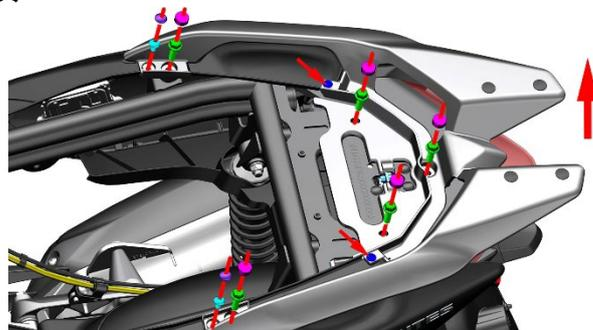
b. 将后扶手翻转到背面使用 4# 内六角拆下左侧 2 颗 M6×12 的螺栓取下后扶手左缓冲胶（图示 L），同样方法拆下右缓冲胶（图示 R）。4# 内六角拆下后部的 5 颗 M6×12 的螺栓，取下翻边衬套和翻边衬套缓冲胶后将底板取下。
