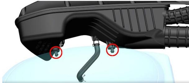
e. 将空滤器往外稍掰开，参照上一页调整右后减震方式调整左后减震到同一档位。
