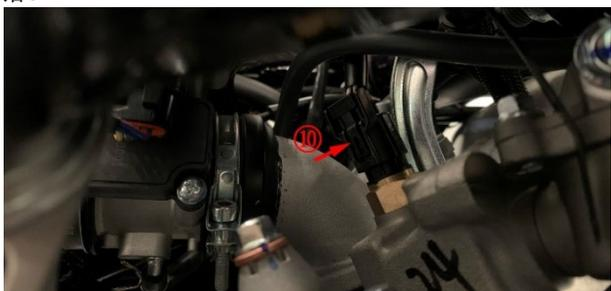
j. 在节气门阀体下部找到并拔下节气门阀体连接碳罐的管。
