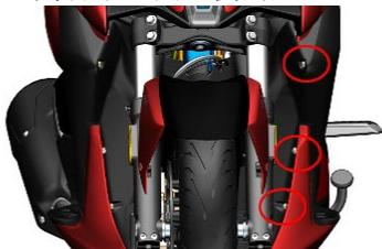
f. 用手指或塑料撬棍从箭头指示处用力往外掰开到露出箭头指示附近的螺栓露出即可。因上部还有螺栓未拆故不能直接取下。
