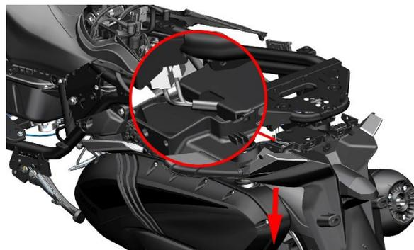
f. 一人抬着车架尾部或两侧，抽出后减震上部 2 颗螺栓。按照大箭头方向往上抬，直至车架与后减震之间的缝隙足够后内泥板取出，一人抓住后内泥板两侧或中部按照小箭头方向先往上穿过后减震再取出。
