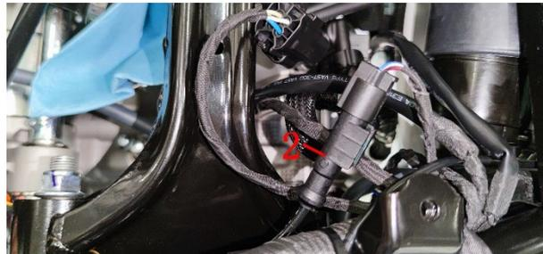
c. 先取下 3 件线夹(4)，然后将轮速传感器(2)和 RC-HU 软管从 4 件油管夹(3)中拔出。如需拆下油管夹(3)可用 4# 内六角拆下螺栓后即可取下。
