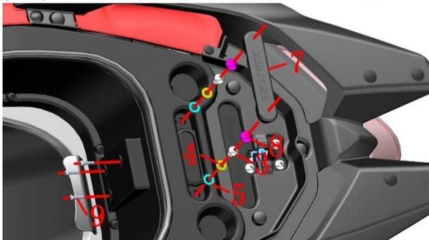
j. 整体式后置物箱：取下M6内六角螺栓装饰扣(8)；用4#内六角拆下两侧的M6×16螺栓(3)。
