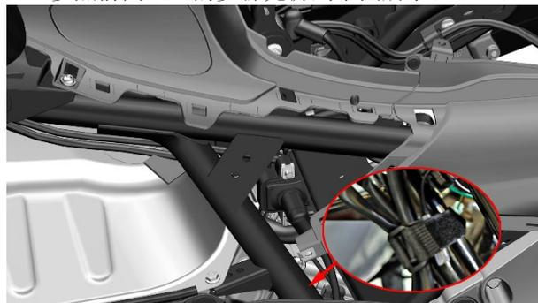
解下左侧的扎带，再将火花塞处的高压帽拔出。一手抵住点火线圈本体一手按下箭头指示处的插头防脱卡扣，将插头拔出。因插头内有防水胶塞拔出比较困难，需注意不要把塑料支架掰断。
