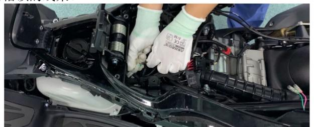
d. 取下油箱盖：一手按下坐垫支架，一手取出油箱盖板中部。**注意：**取油箱盖板中部时需要注意油箱锁的线束不要被卡住，防止拉断油箱锁线束；为防止油箱内部进入异物，取下油箱中部盖板后应立即将油箱盖拧回至油箱上。
