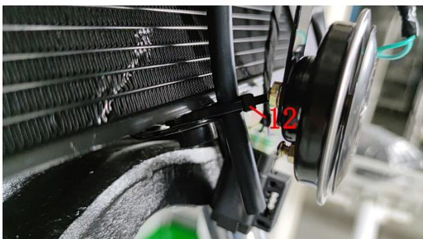
g. 用抱箍钳将  $\phi 10.5$  的抱箍(11)按箭头方向移开后将漏水管(13)拔除。检查副水箱(14)是否有破损。
