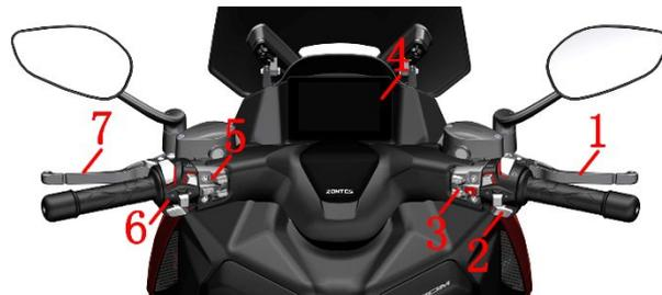
1. 前制动手柄 2. 右手把开关 3. 右副开关 4. 仪表 5. 左副开关 6. 左手把开关 7. 后制动手柄
