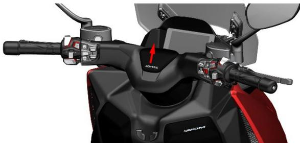
b. 使用十字螺丝刀拆下方向把下罩处的 2 颗 ST3.9×12 自攻钉, 使用一字螺丝刀撬开①处和②处的卡扣。
