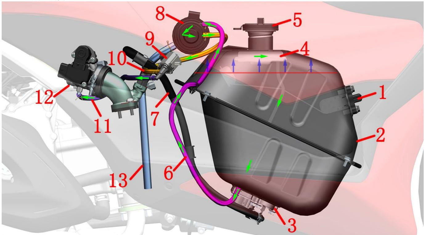
1-油位传感器 2-燃油箱 3-燃油泵 4-油气分离器（焊接在油箱内部） 5-油箱盖 6-吸附/通气管 7-高压油管 8-碳罐 9-碳罐电磁阀 10-电磁阀进气管 11-电磁阀出气管 12-节气门阀体组件 13-进气管
