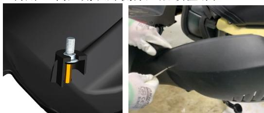
e. 将左螺栓对好安装孔后打紧。
