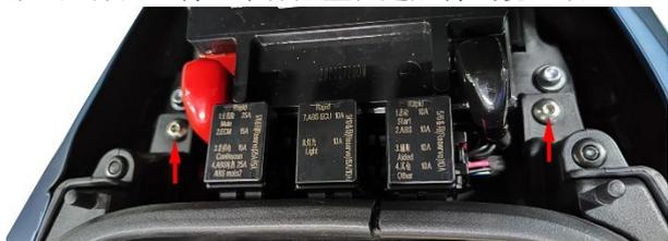
c. 使用 4# 内六角拆下电池旁的 2 颗 M6×14 轴肩螺栓。取下两侧的 2 颗膨胀钉。取下后部的装饰扣后用 4# 内六角拆下 2 颗 M6×16 的螺栓。
