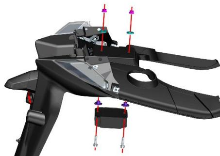
h. 翻转到背面用 4#内六角拆下 2 颗 M6×14 的轴肩螺栓。拆下 2 件膨胀钉后将后挡泥板前部与后部分离。如有需要取下蓝色胶塞的用手取下即可。
