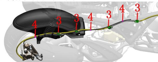
d. 将 RC-HU 头部从副水箱与车架间的缝隙抽出。
