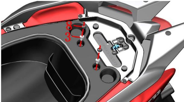
k. 抓住置物箱尾部往斜上方拉起，注意电池舱处的线缆。拉起到能看到左侧的置物箱氛围灯线头，将线头拔掉后取下置物箱组件。
