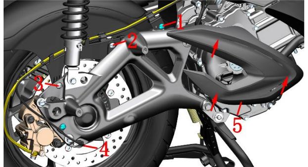
d. 在左侧空滤器与后内泥板的缝隙中，一手拉住空滤器壳体，一手将箭头指示的两处往里按后内泥板。将后内泥板与空滤器上的卡钉分离后往上抬起便于后续拆后摇臂。
