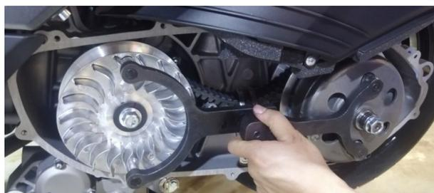
b. 用扭力扳手（或风批）和 17# 套筒逆时针拆卸 M12×1.25×35 六角法兰面螺栓。
