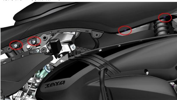
抓住左尾裙后拆下膨胀钉(3)，将左尾裙取下。
