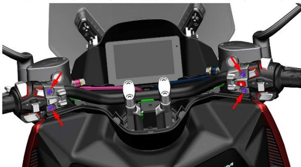
b. 使用 4# 内六角拆下 1 颗 M6×14 的螺栓; 最后使用 6# 内六角拆下 4 颗 M8×30 的螺栓, 取下 2 个压块, 拿起方向把。
