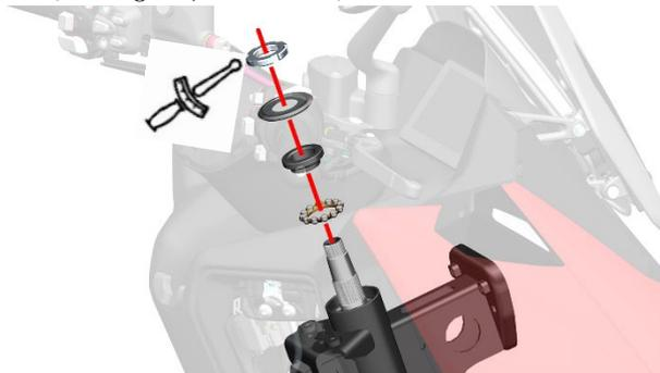
c. 在方向柱调节螺母上放入橡胶胶垫；再拧入第二颗方向柱调节螺母，将第二颗方向柱调节螺母拧到与第一颗方向柱调节螺母的缺口对齐，放入卡式垫片；最后拧入第三颗方向柱调节螺母，扭力：100N.m(10.2 kgf.m, 74 lbf.ft)。
