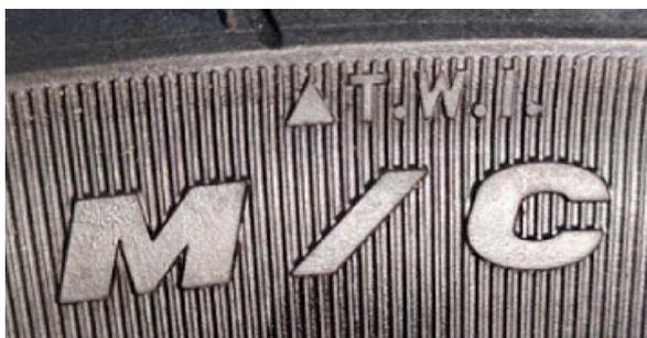
胎面凸起的磨损标记高度为 1.6mm (0.06 in)。胎侧三角形 (△T.W.I.) 标记指示磨损条位置。若磨损到标记点表明已经磨损到极限，继续驾驶会有安全隐患，必须更换新的同规格轮胎。
