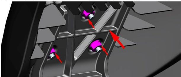
c. 将坐垫翻转到背面，注意坐垫不能直接放地面或硬的物体表面防止将坐垫蒙皮或边缘划破。用一只手顶住坐垫装饰罩，然后用 5# 内六角拆下头部的 2 颗 ST4.2×12 的自攻钉，将坐垫装饰罩取下。如需取下坐垫缓冲胶则用手直接取下即可。
