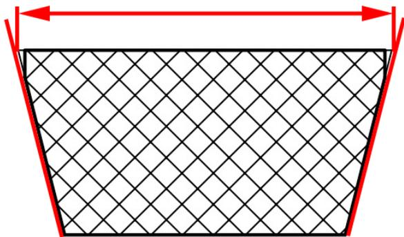
e. 检查从动轮离合器外罩内圆面是否磨损或损坏。用游标卡尺测量内圆孔径，孔径 $\geq \phi 151\text{mm}$ (5.945 in)时需要更换。
