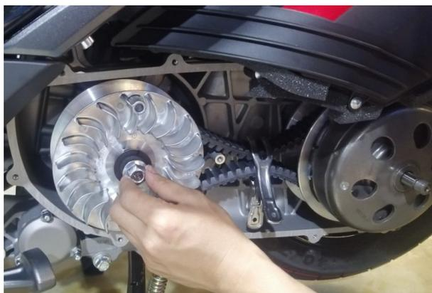
h. 将  $\phi 14.5 \times \phi 25 \times 16$  从动轮衬套带台阶的一头指向从动轮，装在驱动轴外露的一截光轴上。然后在驱动轴螺纹上拧上 M14 $\times$ 1 六角法兰面螺母。
