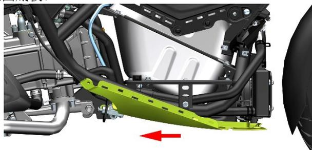
M350 参照 M310 的步骤拆下包围底部，如需拆下装饰板则用十字螺丝刀拆下 2 颗 ST3.9×12 的自攻钉后即可取下。
