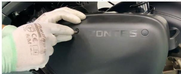
b. 用十字螺丝刀拆下2颗自攻钉。
