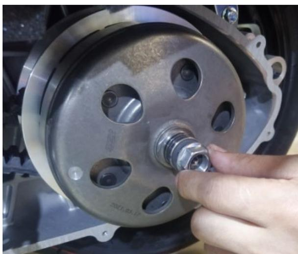
i. 与拆卸时第一步相同，用专用夹具卡住主动轮驱动盘和从动轮离合器外罩，使之不能自由转动。
