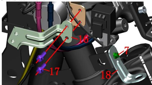
k. 用抱箍钳松开抱箍后，将散热器组件分解。各抱箍分布图见下图。
