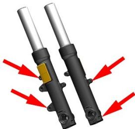
c. 若前叉管上附着大量液压油，则先擦拭干净后骑行观察。若无油迹或轻微油迹则为防尘封处装配时积存的液压油，可判断为油封未漏油。若附着少量油渍或油泥混合物则拆下防尘封后擦拭干净前叉管和油封表面，先压缩一次前减震再擦拭干净再压；重复 10 次上述操作。观察前叉管上是否仍然有，若有则前减震漏油需更换防尘封和油封，若无则是装配时积存的少量液压油为正常现象。
