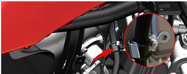
g. 按下防脱锁扣后按箭头方向拔出高压油管。注意2021年3月份之后生产的车辆进气歧管处有高压油管支架和扎带。之前生产的车辆此处仅为扎带绑扎。
