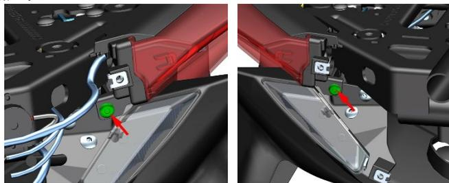
d. 从车架左侧的胶套中找到并拔下尾灯插头，然后双手抓住尾灯两端按照箭头方向往斜后方拔，取下尾灯。
