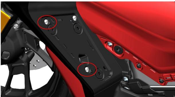
e. 用 4#内六角拆下包围左侧的 3 处 M6×14 螺栓。
