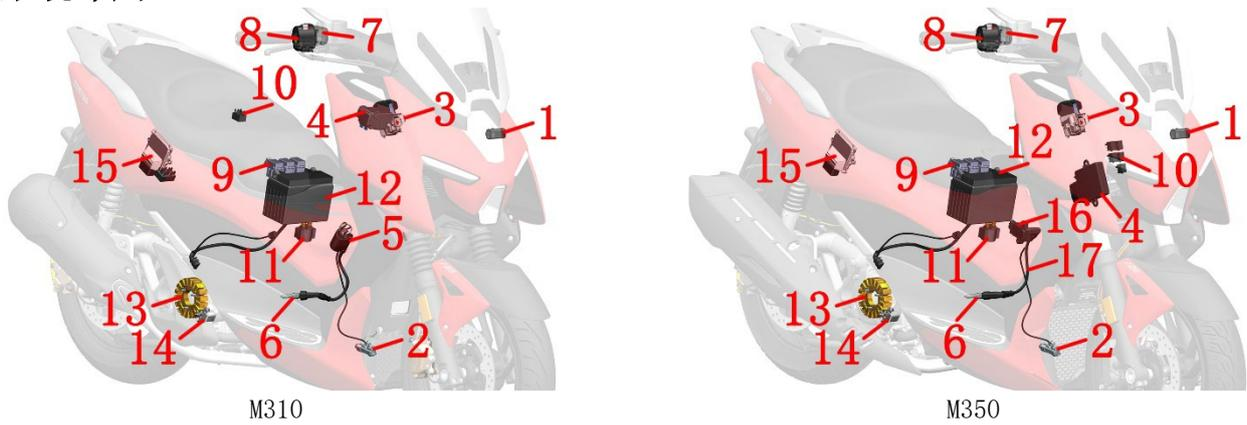
1-倾倒开关 2-侧支架熄火开关 3-龙头 4-PKE 5-点火线圈（M310） 6-火花塞 7-右手把副开关 8-右手把开关 9 保险盒 10-继电器 11-启动继电器 12-蓄电池 13-磁电机定子 14-曲轴位置传感器 15-ECU 16-点火线圈本体（M350） 17-高压线（M350）
