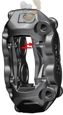
g. 复原前碟刹主泵总成，务必准确装配到位。
