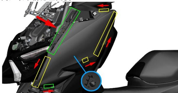
c. 使用相同的方法拆下前右面板。
