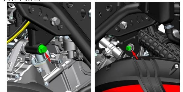
c. 一人使用 14#梅花扳手从尾裙下方伸入并固定左后减震上方的 M10×1.5×55 的螺栓，一人使用 14#套筒+棘轮扳手从车架中拆下固定左后减震的 M10 螺母，并抽出 M10×1.5×55 的螺栓。使用同样方法拆下固定右后减震的 M10 螺母，一人扶住车架，一人使用胶锤+合适工具敲出固定右后减震的 M10×1.5×55 的螺栓。
