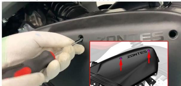
c. 用十字螺丝刀拆下4颗空滤器自带的固定外壳的螺钉。
