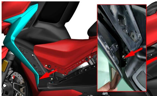
g. 用 5#内六角拆下 M6×16 螺栓，取下衬套。
