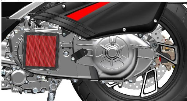
b. 用 8# 套筒拆下图示的两处螺栓(1)。
