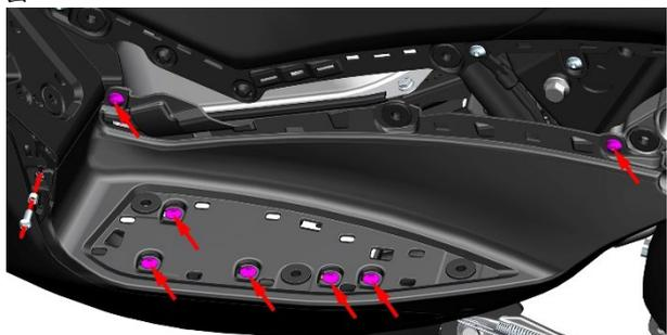
c. 使用 4#内六角拆下包围中部连接左踏板装饰罩头部内侧的 2 处 M6×14 的轴肩螺栓。
