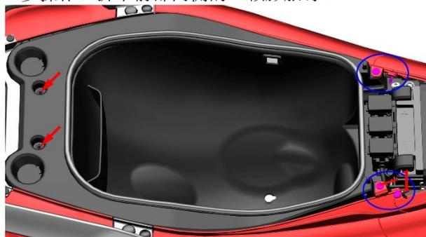
b. 用 4#内六角拆下两侧的 M6×16 螺栓。
