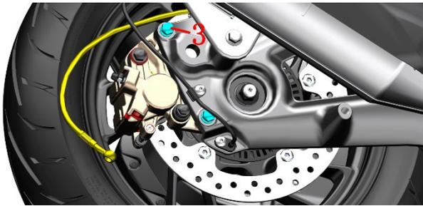
c. 参照更换制动片步骤将制动片先拆下。
