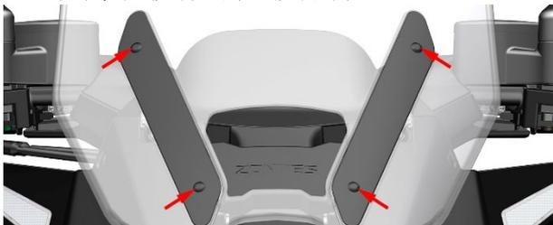
b. 使用 4# 内六角拆松挡风玻璃左、右装饰盖上的 4 颗 M6×14 的螺栓。
