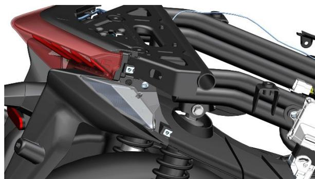
c. 使用 4#内六角拆下尾灯连接在后泥板上的 2 颗膨胀钉。
