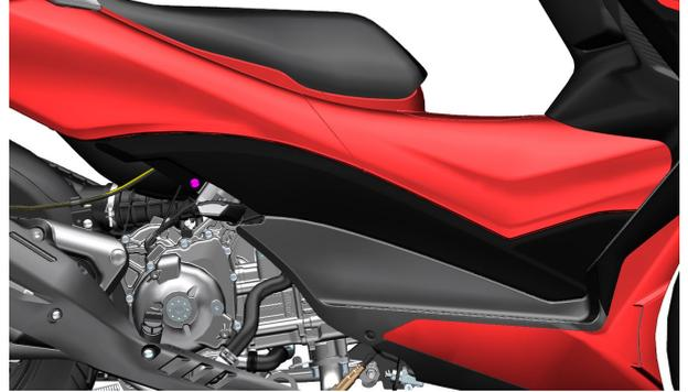
b. 按箭头方向（从后轮往前轮方向）顺序往外拔出。注意红圈处有 5 个卡钉，周围有一圈卡扣。需要用较大力量才能拔出。
