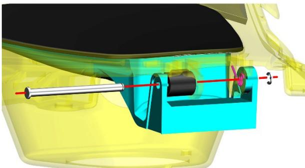
g. 用 5#内六角拆下 ST4.2×12 自攻钉后，将外盖和外盖支架分离。注意外盖头部有卡扣插入外盖支架上。
