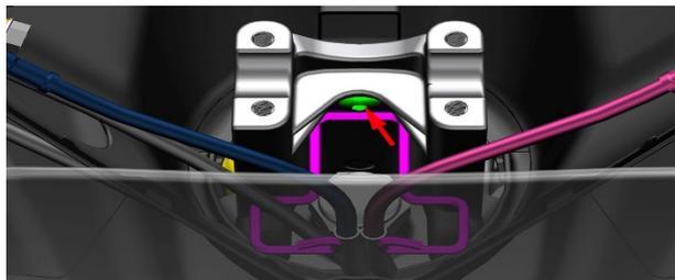
b. 使用棘轮扳手+加长杆+30#套筒拆下上联板盖形螺母。
