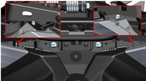
c. 2022年5月25日前生产的车辆：从底部用8#短套筒拆下2颗螺栓(5)，后将整流器和后挡泥板组件往下拉开一定距离方便将整流器线缆抽出。
