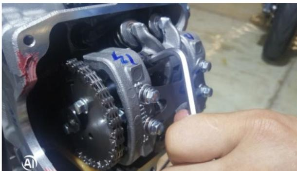
j. 用干净的抹布擦干净缸头结合面和缸头盖密封圈上的机油和残存密封胶后，在缸头结合面拐角处重新涂抹适量密封硅胶。然后对应结合面形状装上缸头盖组件。用 8#T 形套筒扳手（或风批）锁紧缸头盖 6 颗 M6×30 六角法兰面螺栓，扭矩值  $10 \pm 2\text{N}\cdot\text{m}$  ( $1 \pm 0.2 \text{ kgf}\cdot\text{m}$ ,  $7.4 \pm 1.5 \text{ lbf}\cdot\text{ft}$ )。
