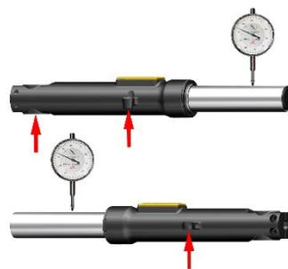
变形量 < 0.2mm (0.008 in) 的轻微变形可用 V 形铁块将前叉管支撑好并在接触面放置软胶或橡胶、铜片等防止前叉管划伤，使用压力机缓慢小压力小行程分多次校直，边校直边测量，矫正后径向跳动应 < 0.05mm (0.002 in)。若矫正后原弯曲变形部位失圆则应更换。过大的变形则应更换减震。
