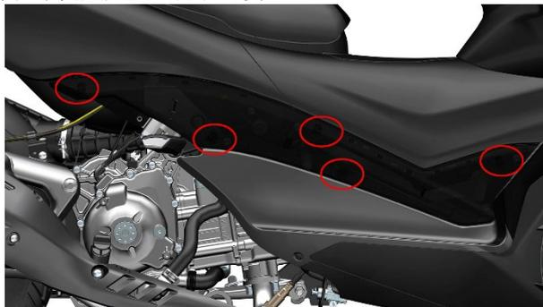
d. 使用 4#内六角拆下尾裙前部的 2 颗 M6×14 轴肩螺栓，再使用 4#内六角拆下尾裙下方的 2 处膨胀钉。
