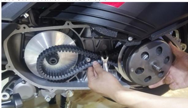
f. 将主动轮驱动盘带有风叶片的一面朝外，中间花键孔对准曲轴上的花键后装配在曲轴上，并装配到位。
