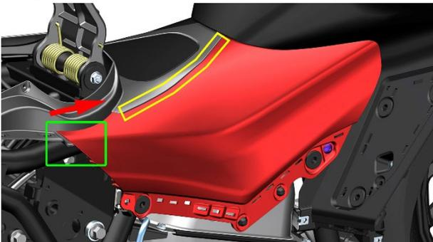
b. 用手抓住油箱盖板右部装饰罩的标记处 (绿色矩形) 按照箭头方向往外拔, 直至将油箱盖板上的 2 处蘑菇扣 (蓝色圆圈) 拔出, 取下油箱盖板右部。
