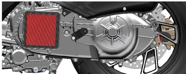
b. 用 8# 套筒拆下图示的两处螺栓(1)。
