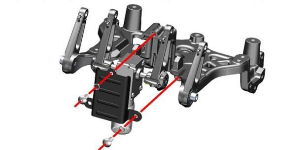
g. 使用十字螺丝刀拆下 2 颗 M4×16 螺栓，将摇臂压块和右下摇臂分离。将 2 件摇臂缓冲胶从摇臂压块上取下。用同样的方法拆下左下摇臂。如购买风挡电机需搭配购买一件“1240300-007000 HJ125-6 电瓶胶垫”，粘贴在电机压板一侧。
