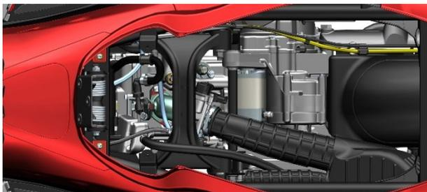
b. 将燃油泵插头拔下，启动发动机怠速运行直到发动机熄火。将发动机熄火开关打到“
