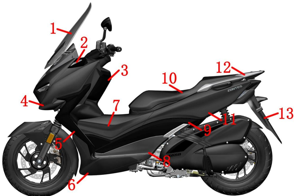
1. 挡风玻璃 2. 左转向灯 3. 前左储物盒 4. 前部左面板 5. 前储物盒面板左装饰罩 6. 左踏板装饰罩 7. 油箱盖板左部 8. 左踏板 9. 左侧盖 10. 坐垫 11. 尾裙左部 12. 后扶手 13. 后挡泥板
