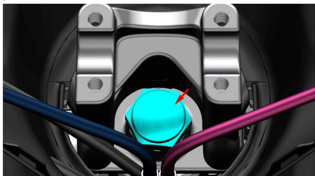
c. 将方向把底座拆卸工装装在方向把垫块上，使用 6#内六角将方向把压块上的 4 颗螺栓装在拆卸工装上并拧紧。再使用棘轮扳手+30#套筒将拆卸工装往下拧，顶出方向把底座和方向把垫块。最后将工装连同方向把垫块和方向把底座一起取出。
