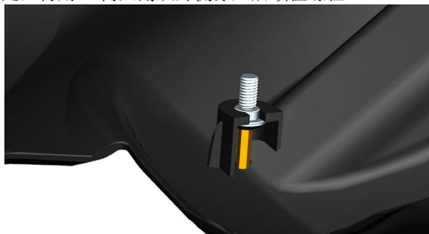
c. 将螺栓对好安装孔后打紧。
