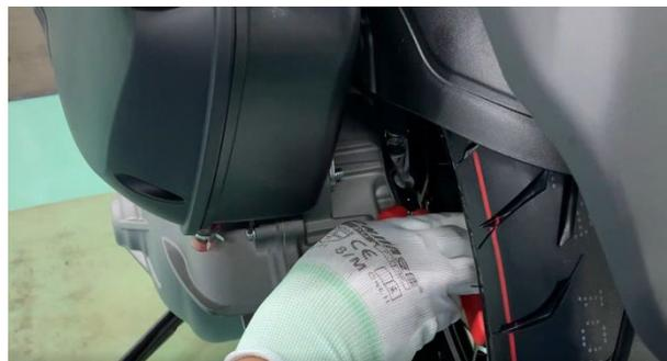
d. 一手将空滤器尾部往外拉，一手将后内泥板往里压。将空滤与后内泥板分离。
