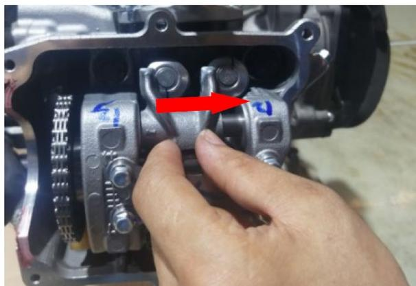
h. 在更换好四个气门调整垫片后，须对四处气门间隙再进行一次检查确认。若出现偏离标准现象，则重复第⑥⑦步操作再次进行调整，直至符合标准范围为止。
