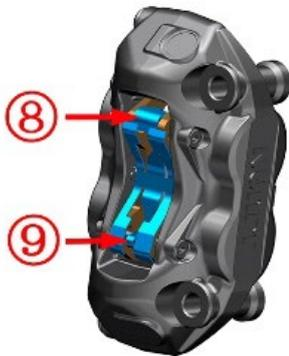
j. 用手将箭头(8)所指处的片体向箭头方向往里按住，将用销轴(2)插入孔位固定住制动片(1)。用 T25 内六角梅花扳手上紧销轴(2)。
