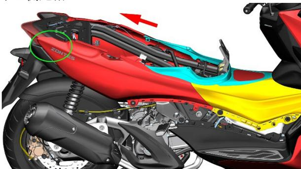
g. 参照“拆卸火花塞”步骤中的 a-j 步骤拆下左、右踏板和左、右装饰罩组件。
