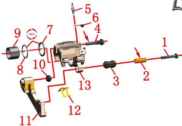
1-卡钳安装板销轴 2-衬套 3-胶帽 4-卡钳销轴 5-放气嘴
