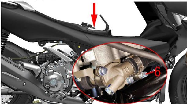
f. 将 2 根水管从水管夹中拔出, 水管夹为塑料材质需注意力度。
