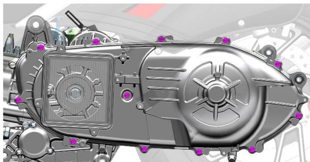
f. 将左曲轴箱盖(2)和左曲轴箱盖垫片(4)取下。复装时必须换新的左曲轴箱盖垫片(4)，不能遗漏空心定位销(3)。
