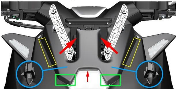
c. 将扣位全部拔出后，用手抓住前部盖板标记处（绿色矩形），按照箭头方向往下拔，直至拔下前部盖板。
