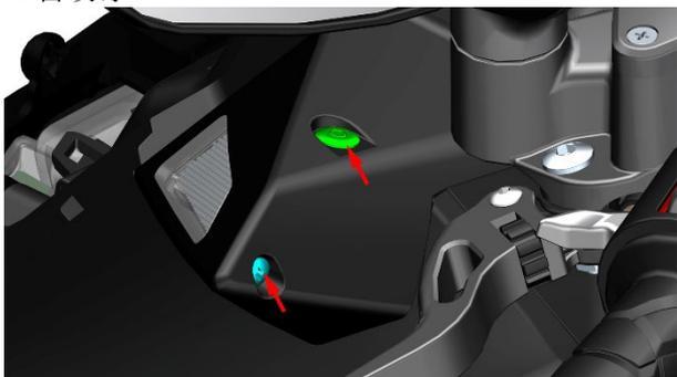
c. 一手取出前左转向灯，一手拔下前左转向灯的 2 个子弹头接头。
