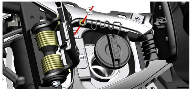
c. 从坐垫支架下方找到并拔下油箱锁接头, 整理好油箱锁的线束。
