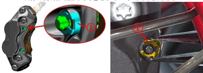
b. 用 T25 内六角梅花扳手依次先拆下上方的销轴②，再拆下方的销轴。
