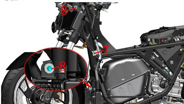
f. 先打开副水箱黑色的橡胶盖，一手抓住副水箱连接水管(10)，一手用抱箍钳将  $\phi 9$  的抱箍(9)按箭头方向移开后将水管慢慢往下同时用接油盘接住排出的冷却液。用同样方法移开  $\phi 10.5$  的抱箍(11)后将水管(10)拔除。剪断扎带(12)，用 8#套筒拆下固定副水箱的 2 颗 M6×22 螺栓(7)。将副水箱组件从车辆上取下。拆下主水箱右侧和铝出水管处的螺栓(7)。
