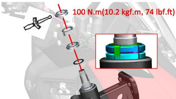
d. 在下联板的凹槽处装入半圆键，再将方向把垫块和底座的缺口对准半圆键装入，最后拧入盖形螺母，扭力：100N.m(10.2 kgf.m, 74 lbf.ft)。
