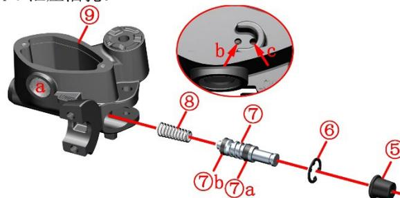
⑤防尘帽 ⑥挡圈 ⑦活塞组件 (⑦a 外密封圈 ⑦b 内密封圈) ⑧弹簧 ⑨主泵壳体
