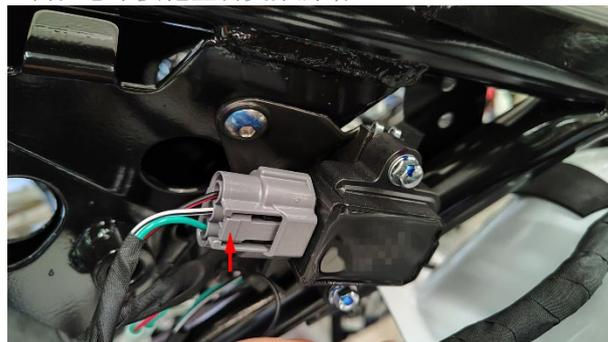
用 4#内六角拆下 M6×12 螺栓(1)，将点火线圈及支架组件从车辆上取下。用 8#套筒拆下 2 颗 M6×22 螺栓(9)后将点火线圈本体(10)和高压线(12)组件取下。将高压线(12)从点火线圈本体(10)上拔下。
