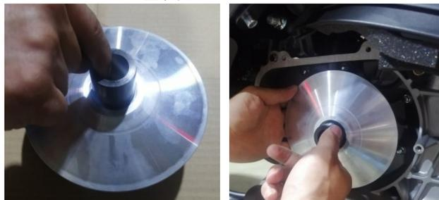
d. 将从动轮整体平放于工作台或干净的地面上，然后使 V 形传动皮带上的指示箭头指向逆时针转动方向，将 V 形传动皮带放置在从动轮外圈，并使其中一段距离从动轮 4~5cm 远。双手手掌部分按住从动轮离合器外罩，双手手指扣住从动轮移动盘向上提拉的同时顺时针旋转。将从动轮移动盘提升大约 10mm (0.4 in) 高度后，快速伸出靠近 V 形传动皮带一侧的手指将 V 形传动皮带拨入从动轮移动盘和固定盘中间的皮带槽内。最后用弹性夹夹住皮带中部，防止皮带自行松出。
