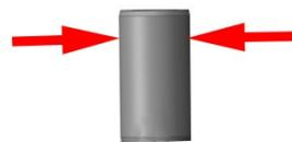
c. 检查普利珠是否磨损失圆，失圆变形则需要跟换。用游标卡尺或外径千分尺测量普利珠外圆柱面直径。直径  $\leq \phi 24.5\text{mm}$  (1 in) 时需要更换。
