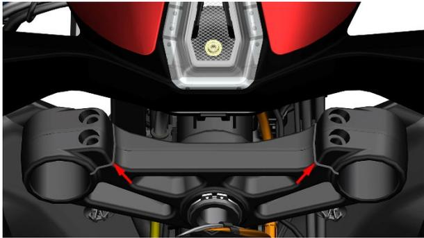
b. 使用一字螺丝刀撬开上联板上的一处缝隙，套入对应减震，注意减震上端面与上联板上端面平齐。将减震装到位后取下一字螺丝刀。拧入 M8×30 的螺栓，使用 6# 内六角拧紧。扭力：25N.m (2.6 kgf.m, 18 lbf.ft)。
