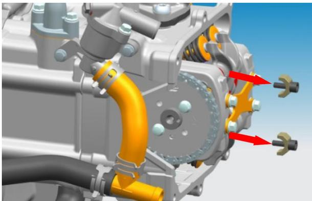
e. 用塞尺分别测量两处进气门间隙和两处排气门间隙，测量值以有轻微拖拽感为准。将测量的四处气门间隙值作好记录。
