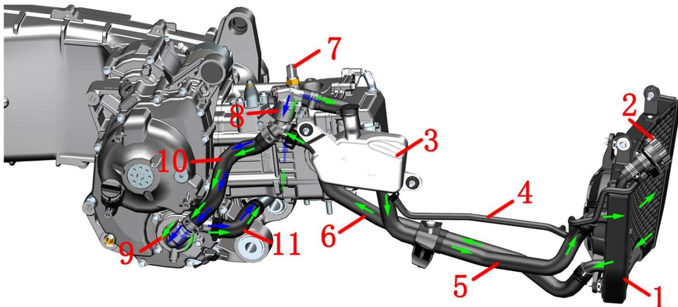
1-主水箱 2-水箱加水口 3-副水箱 4-副水箱连接水管 5-主水箱进水管 6-主水箱出水管 7-水油共用传感器 8-节温器
