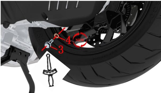
c. 将 M8×25 放油螺栓(3)和 8.3×16×1.5 铜垫(4)取下。
