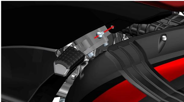
b. 按箭头方向（从后轮往前轮方向）顺序往外拔出。注意红圈处有 5 个卡钉，周围有一圈卡扣。需要用较大力气才能拔出。
