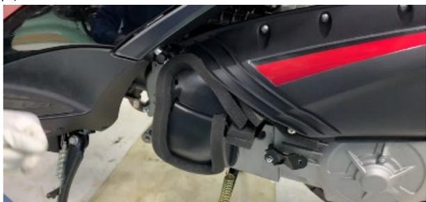
c. 如原车有防震海绵需装回，没有的进行下一步。
