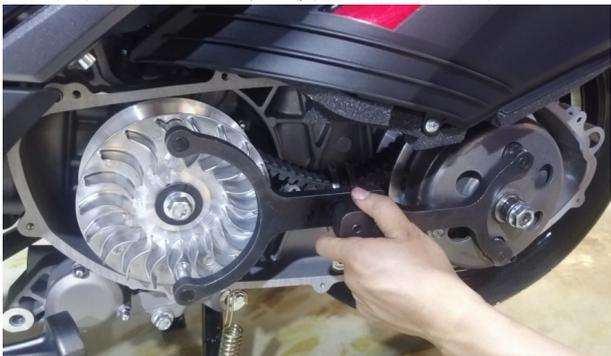
j. 用扭力扳手（或风批）和 17#套筒顺时针拧紧 M12×1.25×35 六角法兰面螺栓，拧紧的扭力需达到  $103 \pm 10\text{N}\cdot\text{m}$  ( $10.5 \pm 1\text{ kgf}\cdot\text{m}$ ,  $76 \pm 7\text{ lbf}\cdot\text{ft}$ ) 范围。然后用扭力扳手（或风批）和 19#套筒顺时针拧紧 M14×1 六角法兰面螺母，拧紧的扭力需达到  $75 \pm 7\text{N}\cdot\text{m}$  ( $7.65 \pm 0.7\text{ kgf}\cdot\text{m}$ ,  $55 \pm 5\text{ lbf}\cdot\text{ft}$ ) 范围。
