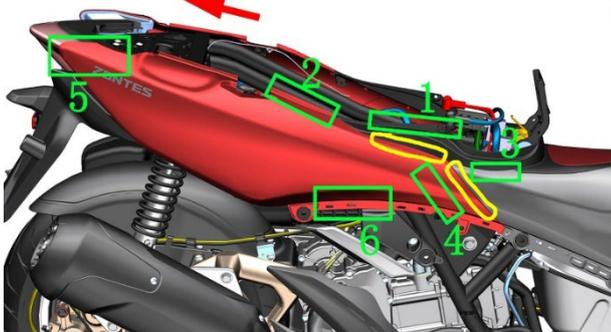
d. 使用同样的方法拆下左后尾裙。
