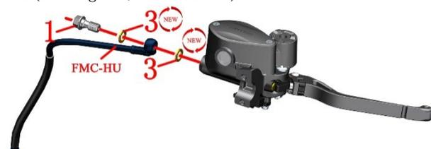
e. 参照添加制动液步骤拆除上盖；参照拆刹车开关和制动手柄的步骤拆除。
