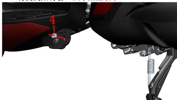
f. 使用柴油或煤油，或者干净的抹布将残留的润滑脂擦拭干净。在侧支架内侧 2 个安装平面、与熄火开关配合的面涂抹适量润滑脂，尽量不要涂抹到螺纹孔内。
