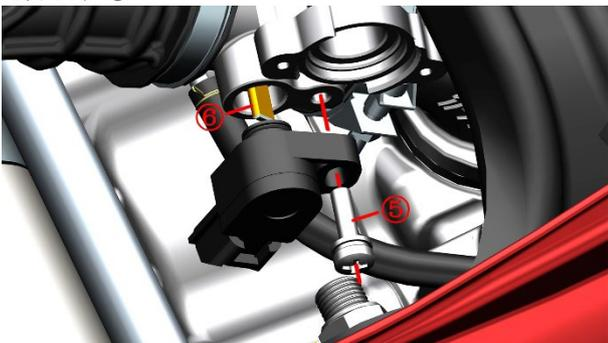
简易测试方法：整车连接上诊断仪器，按下熄火开关（无需打着火），转动油门手把从初始位置到全开，此过程查看节气门位置信号是否跟从 0 到 100 变化。
