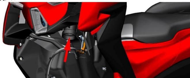
b. 依次在下联板上方放入涂抹好润滑脂的轴承、轴圈、防尘盖，再拧入 1 颗方向柱调节螺母，使用四爪套筒将方向柱调节螺母拧紧，扭力：50N.m(5.1 kgf.m, 37 lbf.ft)，确保上联板不上下串动后将方向柱调节螺母逆时针松 1/4 圈，最后使用扭力扳手拧紧，扭力：15N.m(1.2 kgf.m, 11 lbf.ft)。
