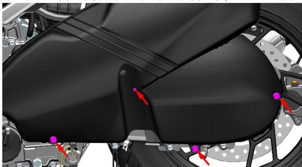
c. 拔出将空滤器装饰罩上的3处蘑菇扣，取下空滤器装饰罩。
