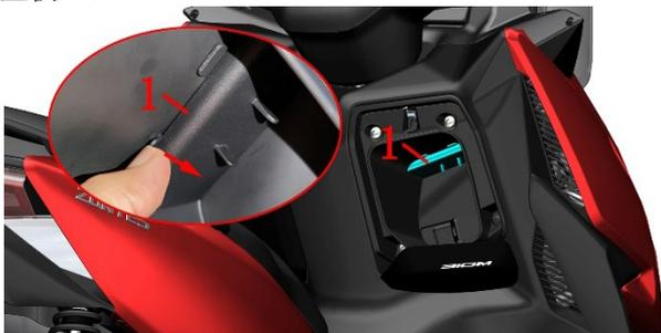
将 OBD 插头拉出，接上诊断仪读取故障代码。OBD 插头不同批次颜色可能不同，有黑色和白色两种颜色，功能相同。如果 OBD 插头有保护盖则需先取下。
