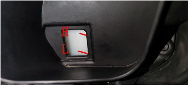
d. 检查完毕将橡胶塞装回。关闭右储物盒盖。
