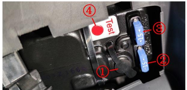
①为充电 DC 接口保护帽；②为充电保险；③为 PKE 保险，用充电器通过 DC 接口给电瓶充电时需拔掉此保险；④为 TEST 按键，功能相当于副开关上的解锁按钮。
