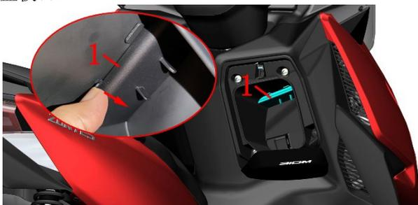
掀开保护帽①，拔出 PKE 保险③后先将随车赠送充电器 DC 输出线端插头插入 PKE 充电口；再将充电器输入 AC 端接入 110~220V 家用交流电。
