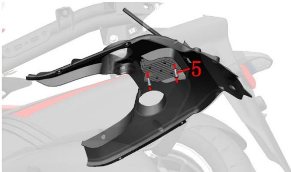
2022年5月25日后生产的车辆：用10#梅花扳手固定好上方的M6螺母，在底部用8#套筒拆下M6×22螺栓。注意整流器与后泥板前部之间有两个衬套。
