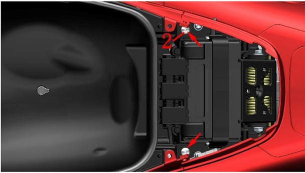
c. 拔掉步进电机插头①和节气门位置传感器插头②。
