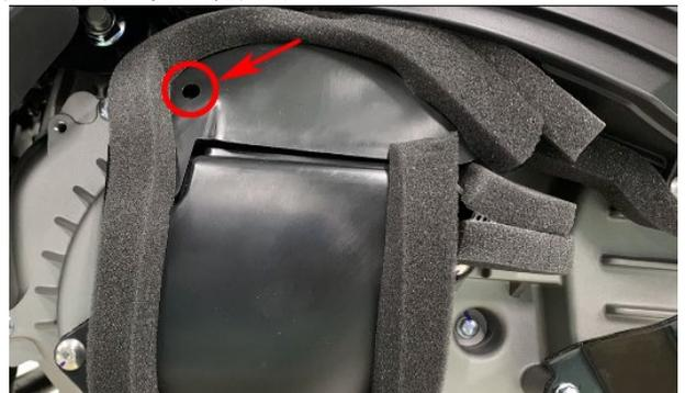
b. 用 4#内六角拆下图示的 3 颗 M6×14 轴肩内六角螺栓。
