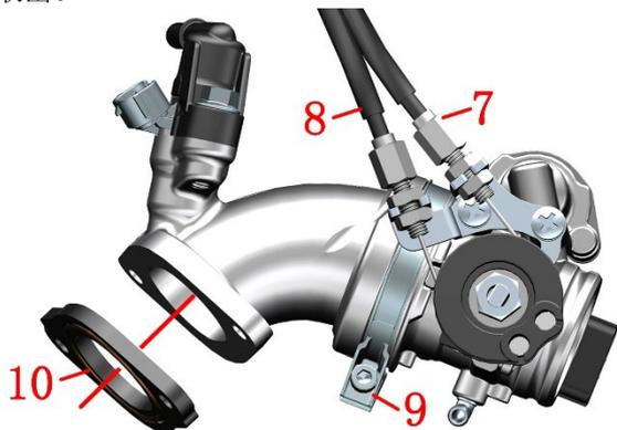
g. 用节气门阀体清洗剂分别对进气歧管和节气门阀体出气口的积碳进行清理。禁止用任何液体直接浸泡节气门阀体组件和进气歧管组件。
