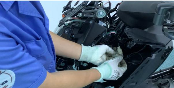
c. 在前储物盒面板右边找到并拔下 PKE 的子弹头接头、PKE 接头、PKE 天线接头。
