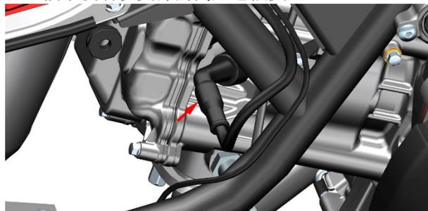
c. 参照《拆节气门阀体组件清理积碳》中的步骤拔掉节气门阀体上的步进电机①、三合一传感器②的插头。
