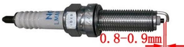
d. 如有需要，可通过弯曲侧电极来调整间隙，注意调节时的力度。
