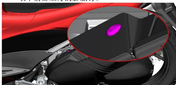
b. 用4#内六角拆下图示的4颗内六角M6×14螺栓。
