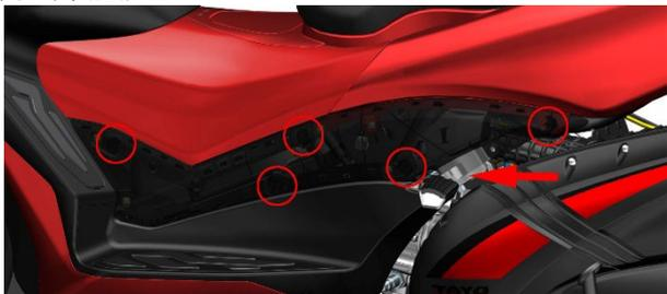
c. 用 4#内六角拆下 2 颗 M6×14 螺栓。从油箱左盖板和尾裙相交的底部开始，一手将左盖板往外拉，一手压住后尾裙的前部；拔出底部后再将左盖板上部往外拔。再抓住盖板中部，将盖板后部往下压的同时往外拔出左盖板。
