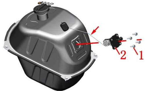
重新装配时需先对角预紧然后再拧紧4颗螺栓，否则油位传感器的密封胶圈压缩不均匀容易导致渗漏造成安全隐患。
