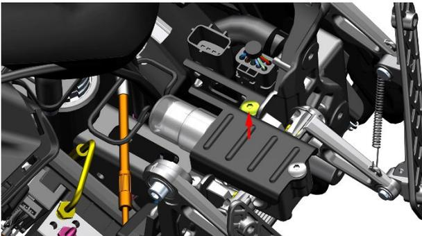
b. 用 8#套筒拆下副水箱左侧的 M6×30 螺栓和右侧的 M6×30 螺栓将主水箱从基座上移开。将副水箱漏水管从
