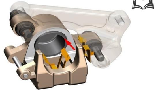
d. 左手抓住外侧制动片，右手插入销轴(2)，注意不要插到底。将内侧制动片装入到位后再将销轴插到底并使用 5#内六角锁紧销轴(2)。注意切勿装反，有凹槽的一面朝向制动盘；黑色金属背板朝向卡钳。
