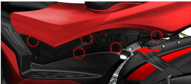
c. 用手指或塑料撬棍插入箭头指示处，先将箭头指示处撬开缝隙后再拉起。
