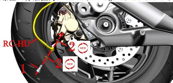
b. 用 14# 套筒拆下螺栓(3)。螺栓(3)的标准扭力：24N.m(2.4 kgf.m, 18 lbf.ft)。
