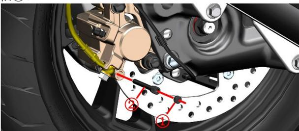
b. 用 12#套筒拆下螺栓(3)，将卡钳组件绕螺栓(4)顺时针转动，取下制动片。注意螺栓(4)不用拆卸。
