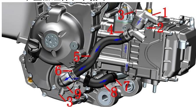
1-节温器组件 2-M6 $\times$ 22 螺栓\*2 3-M6 $\times$ 12 螺栓\*2 4-水管抱箍 ( $\phi 25$ ) 5-水泵盖进水管 6-水管抱箍 ( $\phi 24$ ) 7-水管抱箍 ( $\phi 26$ ) \*2 8-水泵盖出水管 9-水泵盖组件
