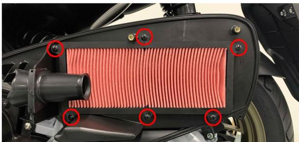
b. 将旧的空滤器滤芯取下。用吹尘枪将进气管内侧的灰尘吹干净后再用干净的无纺布将内壁擦拭干净。
