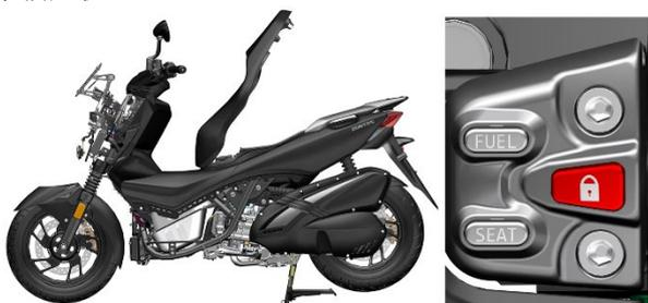
b. 一手扶住坐垫，一手使用 10# 梅花扳手或 10# 套筒拆下坐垫固定在坐垫支架上的 3 颗 M6 的螺母，双手抓住坐垫按照螺柱的角度（大箭头方向）往斜上方抽出坐垫。**注意：**角度不对导致坐垫抽不出来时，不可使用蛮力将坐垫强行抽出，防止损伤坐垫安装螺柱上的螺纹。
