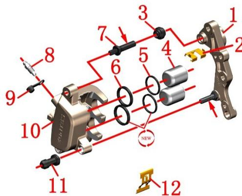
1-卡钳安装板 2-制动片保持架 3-卡钳销轴胶帽 4-活塞 5-防尘封 6-油封 7-卡钳销轴 8-放气嘴 9-放气嘴胶帽 10-卡钳壳体 11-卡钳安装板销轴胶帽 12-制动片弹簧
