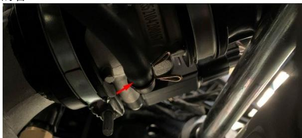
k. 在节气门阀体左边找到并拔下油气分离器连接空滤器的管。
