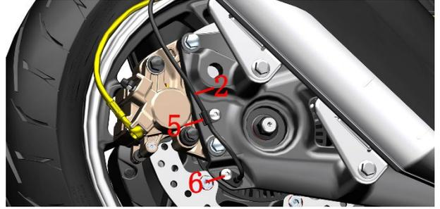
g. 检查取下的软管表面是否有老化龟裂、破损、磨损等不良现象。用无纺布擦拭干净残留的制动液后用保鲜膜或塑料袋将软管两端面包好，防止异物进入。检查轮速传感器线的线缆外皮是否有破损，若有磨破外皮可用电工胶布粘好防止短路。
