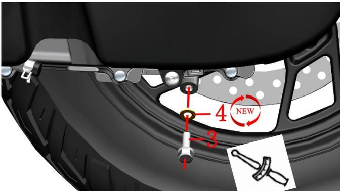
c. 将  $M8 \times 25$  放油螺栓(3)和  $8.3 \times 16 \times 1.5$  铜垫(4)取下。
