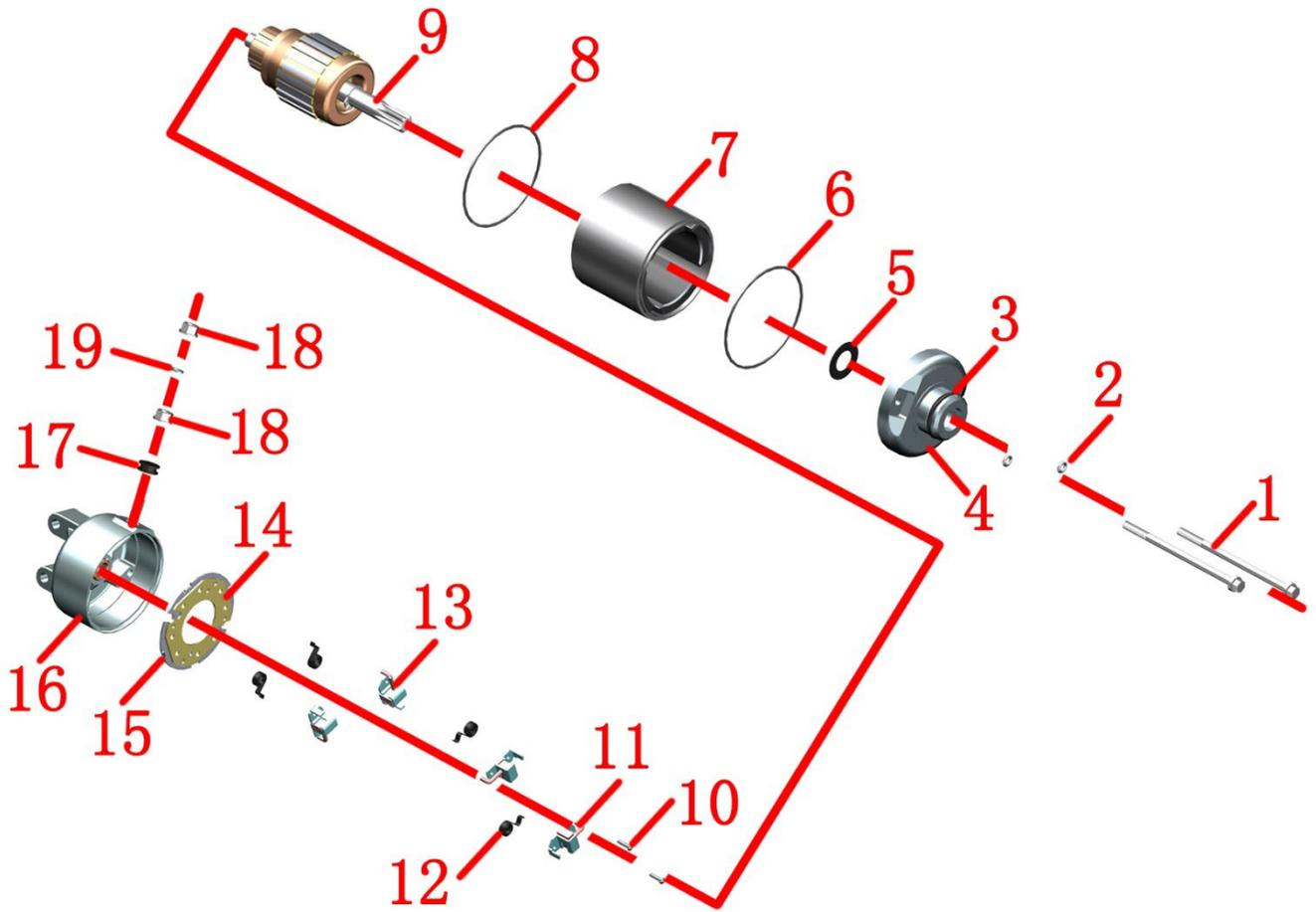
1-M6×90 螺栓×2 2-0 环×2 3-0 环 4-起动机前盖 5-垫片 6-矩形密封圈 7-起动机外过壳 8-矩形密封圈 9-电枢
