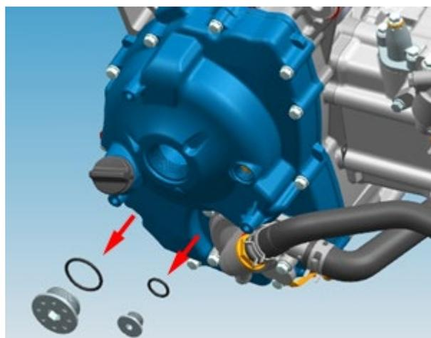
c. 将 14#T 形套筒扳手从 M30×1.5 铝螺塞孔插入并套在飞轮螺栓六角头上，然后顺时针转动曲轴使飞轮上的 T 点刻线对准 M14×1.5 螺塞孔标记缺口。同时正时从动链轮上的上止点刻线也要对准缸头上的凸起标记线。
