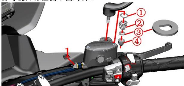
c. 抓牢前刹主泵后用 5# 内六角拆下 2 颗螺栓(2)，将右副开关移开。
