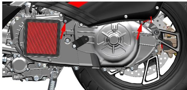
c. 用尖嘴钳将空滤器尾部内侧的废气管卡箍夹住再往上移动约 20mm(0.8 in)。再用手将废气管拔出曲轴箱。
