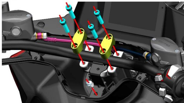
c. 使用 5# 内六角拆下右手把开关下方自带的螺栓 a 和 b, 再使用十字螺丝刀拆下螺栓 c, 将右手把开关上、下部分开。
