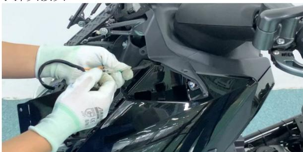
d. 使用相同的方法拆下前右转向灯。
