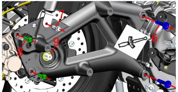
f. 取下轴套(10)后将后轮组件取下。
