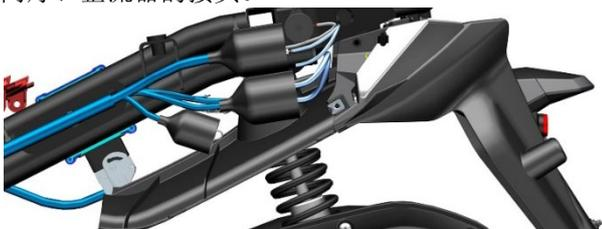
c. 一人使用 14#套筒固定住固定后减震上方的非标 M10×1.5×55 的螺栓，一人使用 14#套筒+棘轮扳手或梅花扳手从车架内侧将固定后减震上方的非标 M10×1.5 螺母拆下，扭力：30N.m (3.1 kgf.m, 22 lbf.ft)；使用同样的方法拆下另一侧的螺母。注意螺栓先不要取下。
