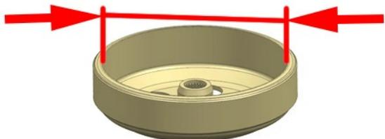
f. 检查从动轮离合器蹄块是否磨损或损坏。用游标卡尺测量蹄块圆孔径，直径 $\leq \phi 146\text{mm}$ (5.748 in)时需要更换。从动轮离合器组件禁止自行拆解，拆解后需专用的压装和限位工装以及专业的动平衡设备。
