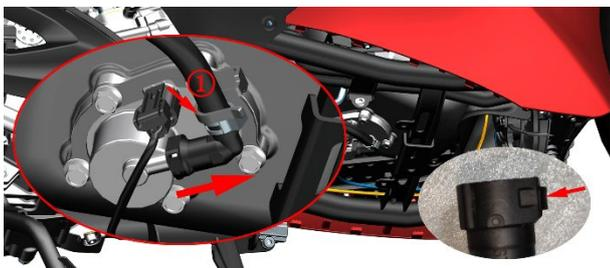
f. 将高压油管从缸头处的支架拔出。
