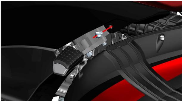
b. 按箭头方向（从后轮往前轮方向）顺序往外拔出。注意红圈处有 5 个卡钉，周围有一圈卡扣。需要用较大力量才能拔出。
