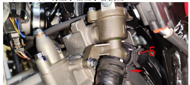
e. 从上方用一字螺丝刀松开  $\phi 26$  卡箍(6)后移开, 将主水箱进水管拔出。
