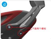
如果您不需要安装小靠背,可取下车辆后尾下的2个螺栓,在螺栓孔内涂上少量黄油防锈,在配件箱中找到如图e所示的大圆盖,贴好双面胶,先把短的卡扣放到对应的位置,长的一端朝上,卡进扣位.
