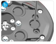
② 打开坐垫并取下,把工具插到车尾的两个孔中,如图b所示,轻轻往下拍,取出后尾裙上的两个小圆盖,请妥善保管:
