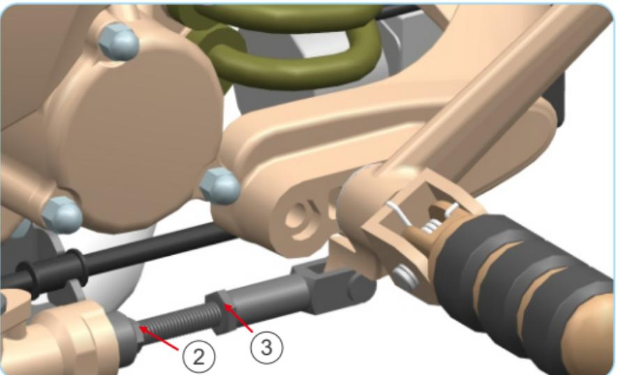
3. 前右脚踏装到最前位置:在步骤2的基础上加装ZT310-V后刹主泵活塞推杆加长杆④。
