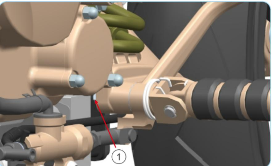
2. 前右脚踏装到中间位置:松开锁紧螺母②,旋转螺杆③,将刹车踏板位置调到合适高度后打紧锁紧螺母②。
