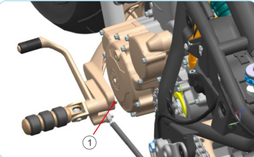
3. 脚踏装最前面位置时,按上面的方式在调节螺杆前多加装一个前挡泥板衬套②,起到延长调节螺杆的作用。
